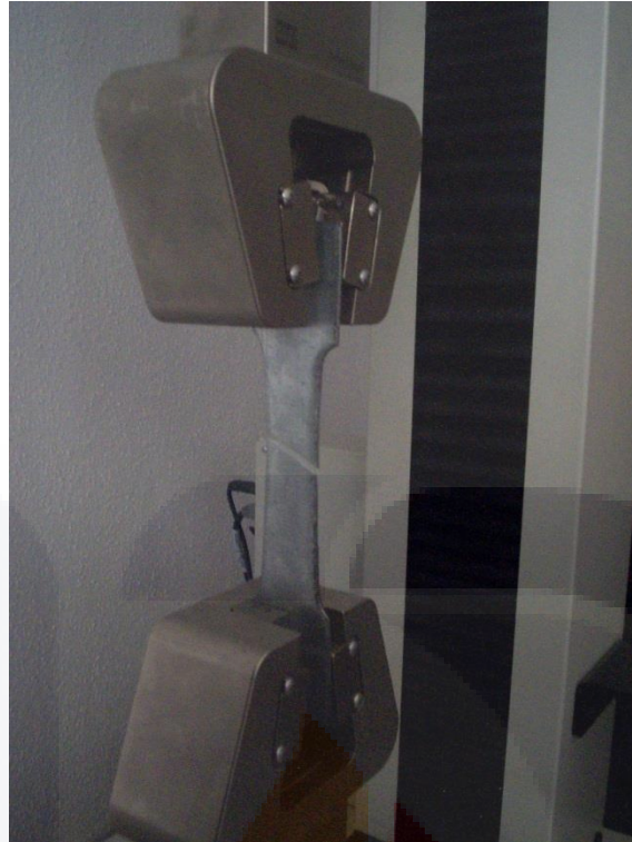
Imagen 9.- Ensaye a tensión de probeta de acero en maquina universal de pruebas.
