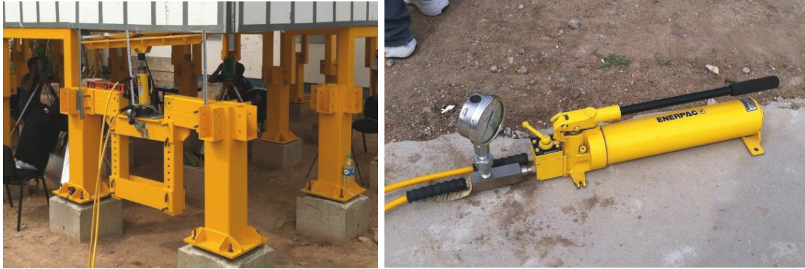
Imagen 66.- Marco móvil que permite desplazamientos en vertical de la estructura de la plataforma en que se asienta el prototipo de vivienda ensayado.
