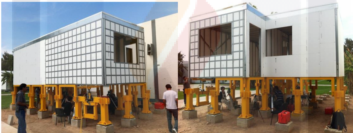
Imagen 63 e Imagen 64.- Prototipo de vivienda que se somete a ensayo en plataforma simuladora de hundimientos diferenciales.
