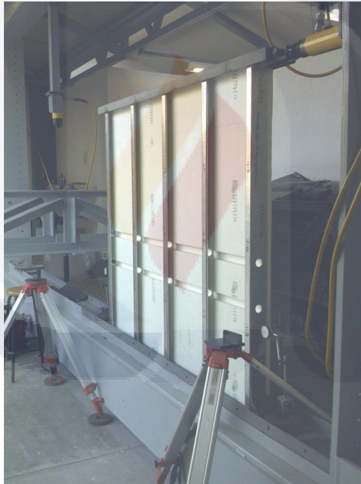
Imagen 18.- Ensaye por carga lateral en panel de muro construido a base de perfiles de acero rolad con placas de poliestireno.
