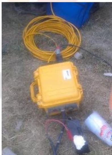
Figura 8 Sismógrafo ultra ligero Geode.
