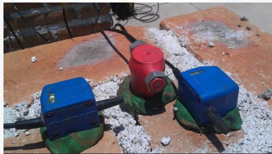
Figura 12 Disposición y colocación de geófonos en pilastras.
