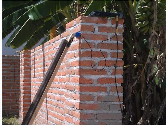
Figura 13 Colocación de geófono para determinación de módulo de elasticidad.
