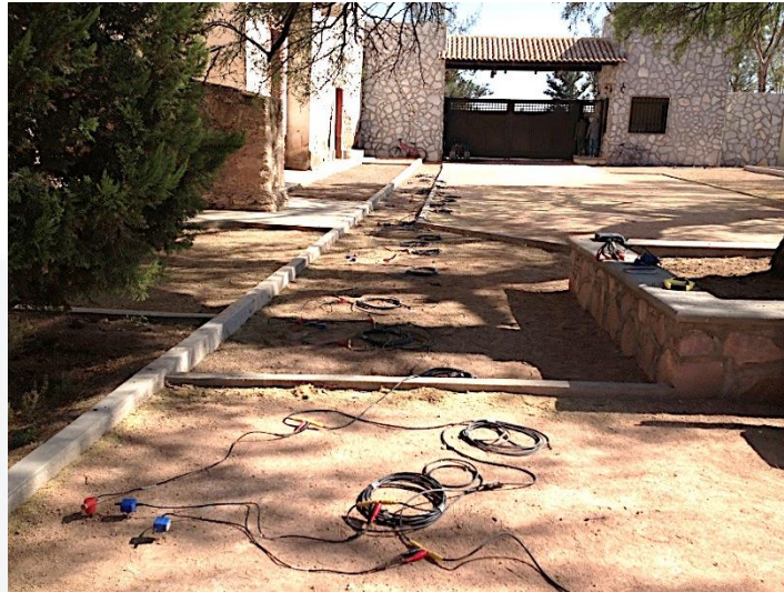
Fig.49: Colocación de la primera línea de medición de 24 canales dividida en 8 grupos de 3 cada uno, con geófonos para la medición de los ejes X, Y y Z.
