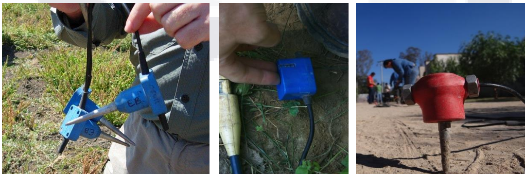
Fig.43: Imágenes de geófonos utilizados en la toma de lecturas.
