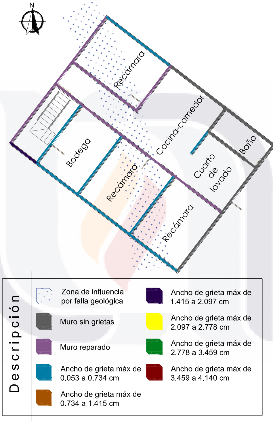
Figura 55. Abertura máxima de grietas en planta baja
