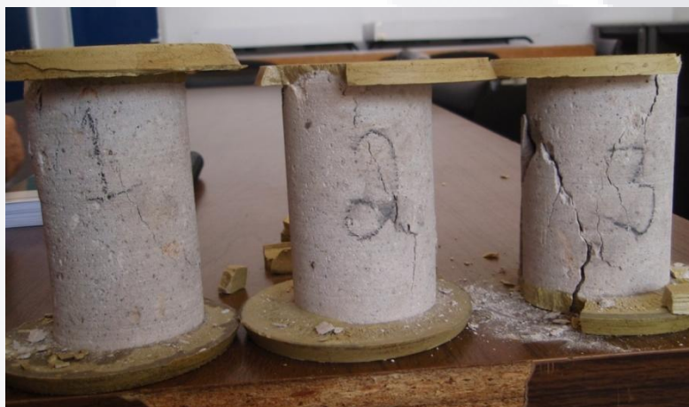
Figura 64. Especímenes después del ensayo.
