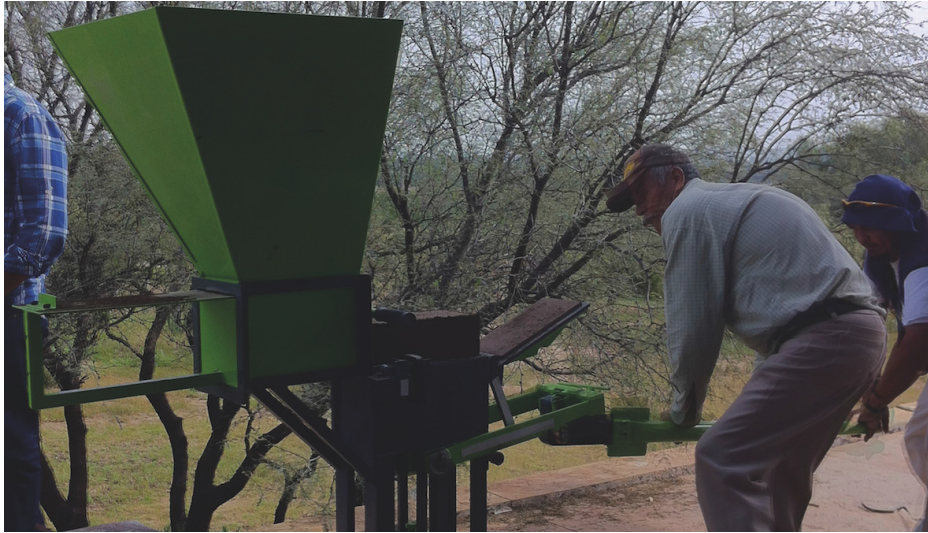
Figura 46. Máquina manual que se utilizó para el desarrollo del proyecto (producida en México). Fotografía captura propia.
