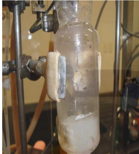
Figura 25. Cámara para órgano aislado, el cual contiene un fragmento de aorta aislada (2-3 mm) que ha sido aislada, sujeta a un gancho en el fondo de la cámara y en la parte superior a un transductor de tensión.
