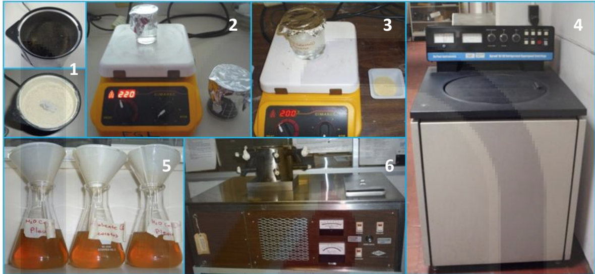
Figura 7. En la ilustración se resume el proceso de extracción por el que se obtuvieron los extractos acuosos calientes de ambos hongos. 1) Polvo de huitlacoche (arriba) y P. ostreatus (abajo) liofilizados; a partir de este material se prepararon los diferentes extractos. 2 y 3) Extracción; se realizó mediante la agitación de la muestra en agua en ebullición durante 10 min, #2 huitlacoche y #3 P. ostreatus . 4) Separación de la muestra y extracto mediante centrifugación. 5) Filtración del extracto; este proceso se realizó con el fin de eliminar los restos de muestra que pudiera contener el extracto. 6) Liofilización de los extractos. Es necesario mencionar que cada muestra se extrajo en 3 ocasiones y se unieron los 3 extractos para el proceso de liofilización.
