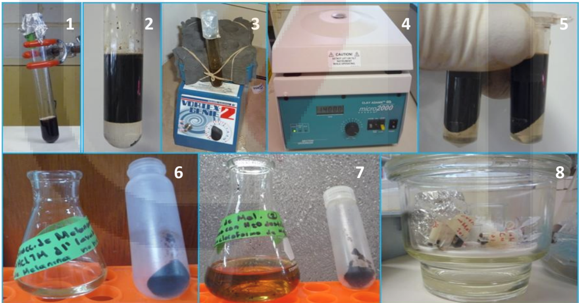
Figura 12. En la ilustración se resume el proceso de lavado con cloroformo de la “melanina no hidrolizable”. 1) Solución alcalina de “melanina no hidrolizable”. 2) Mezcla de cloroformo y solución alcalina de “melanina no hidrolizable”, se puede observar la separación de ambos elementos en 2 fases. 3) Agitación de la mezcla; este proceso se realizó bajo atmósfera de nitrógeno. 4) Centrifugación de la mezcla. 5) Separación de la fase de cloroformo; después de separar la fase de cloroformo el proceso fue repetido en 2 ocasiones más a la solución alcalina de melanina. El cloroformo separado de los 3 lavados se considero como el sexto residuo de la extracción de melanina. 6) Precipitación de la melanina por acidificación a pH 2; se realizó con HCl y la melanina fue separada por centrifugación. El sobrenadante (HCl) fue considerado como el séptimo residuo de la extracción de melanina. 7) Lavado de la melanina con agua destilada. El agua de los lavados
