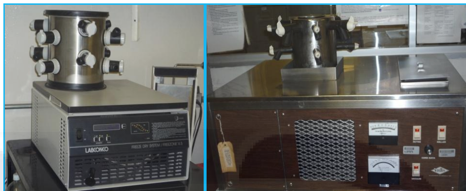
Figura 4. En la ilustración se muestran las dos liofilizadoras utilizadas para la deshidratación de las muestras. Del lado izquierdo se muestra la liofilizadora Labconco modelo Freezezone 4.5, localizada en el Laboratorio de Instrumentación de la Universidad Autónoma de Aguascalientes. Del lado derecho se muestra la liofilizadora Virtis modelo 620L 3150 0C localizada en el Laboratorio de Microbiología de la Universidad Autónoma de Aguascalientes.
