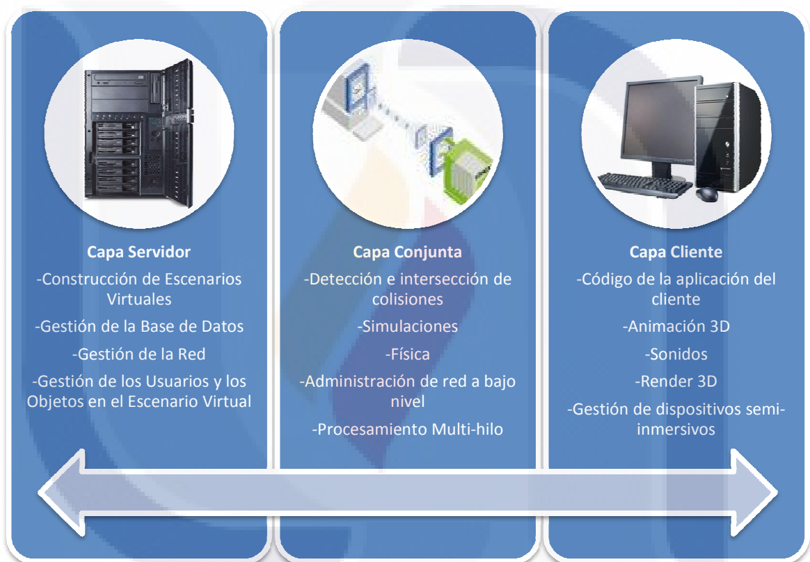
Figura 7. Arquitectura de un Game Engine basada en niveles
