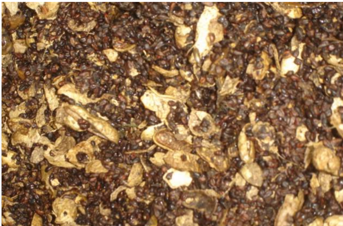
Figura A1. Vista del soporte de biofiltración utilizado en el biofiltro.
