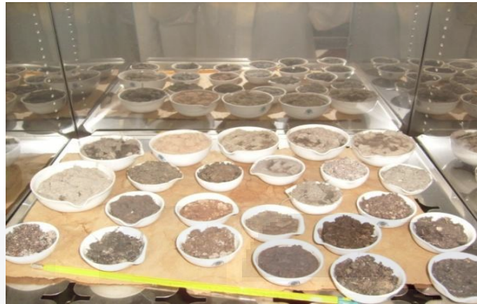
E 1. Secado de sedimentos a 105° C/ 24 – 48 h previo al proceso de molienda y tamizado.
