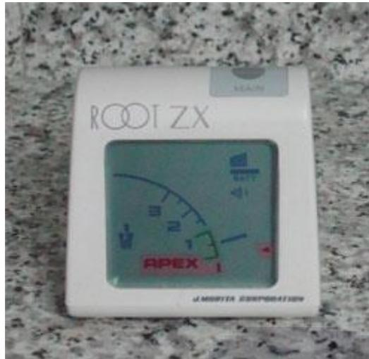
Fig. 9. Fotografía que muestra la ventana de señalización del Root ZX.
