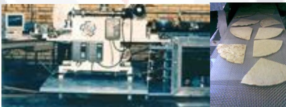
Figura No. 16. Deshidratado en horno de radiación IR.
