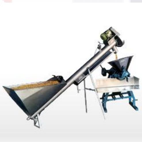
Figura No. 4. a) Lavado de maíz manual; b) Lavadora de maíz nixtamalizado
