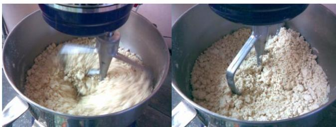
Figura No. 13. Rehidratado y mezclado de las formulaciones.
