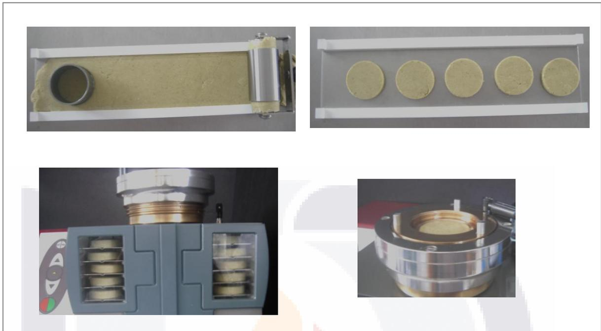
Figura No. 18. Preparación de la muestra para análisis reológicos (tenacidad y trabajo).
