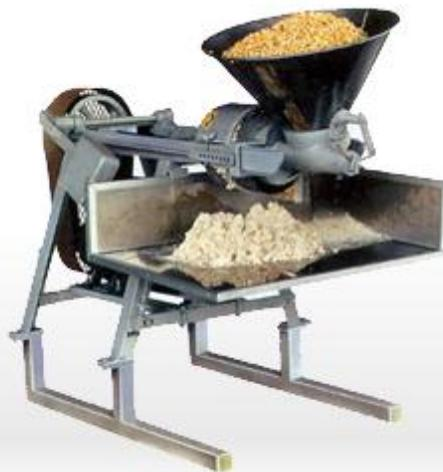
Figura No. 5. a) Molienda ancestral en el “metate” y b) Molino de nixtamal de acero inoxidable.
