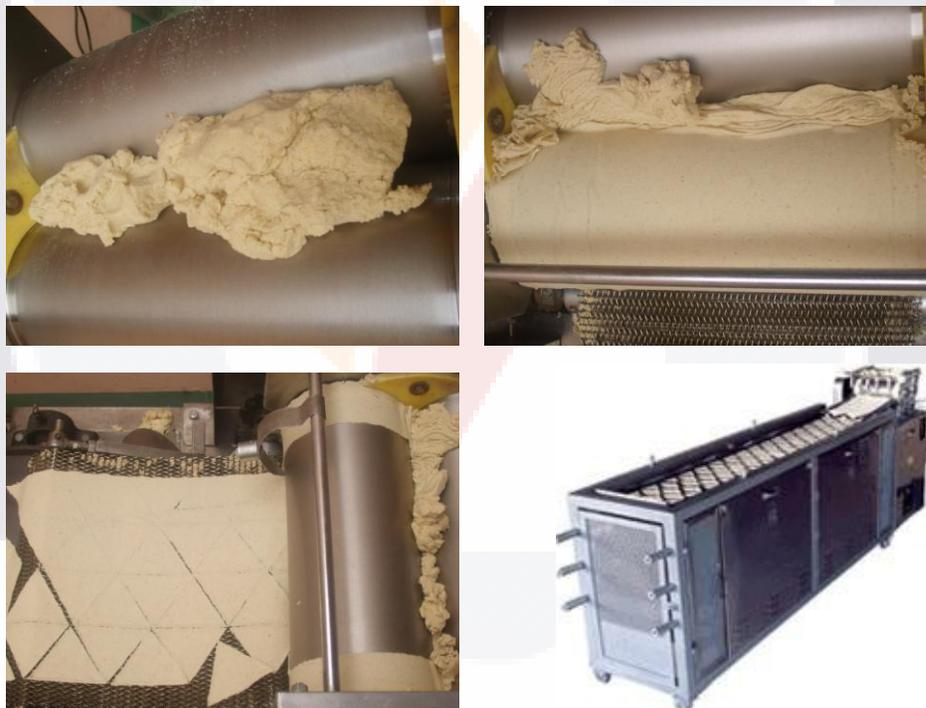
Figura No. 14. Moldeado, cortado y precocido.
