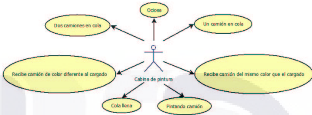
Figura 6.4: Diagrama de estados de la Cabina de pintura
