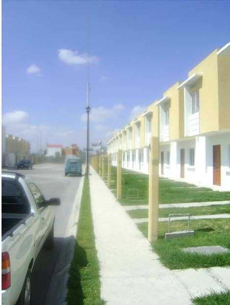
Aquí se observa la instalación eléctrica que es aérea la principal (media tensión) y la secundaria que es oculta (baja tensión), el sistema de electrificación es híbrido.
