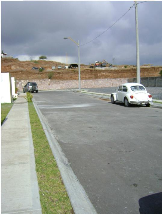
Aquí se observa la instalación eléctrica que es aérea la principal (media tensión) y la secundaria que es oculta (baja tensión), el sistema de electrificación es híbrido. Como también observamos la banquetta, el arriate, la guarnición tipo pecho paloma y el pavimento flexible (pavimento de concreto asfáltico).
