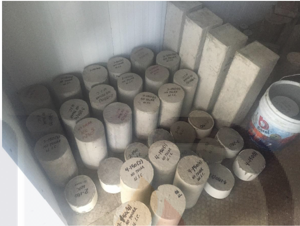
Ilustración 14 Especímenes en el cuarto de curado de la Universidad Autónoma de Aguascalientes (UAA, 2016).
