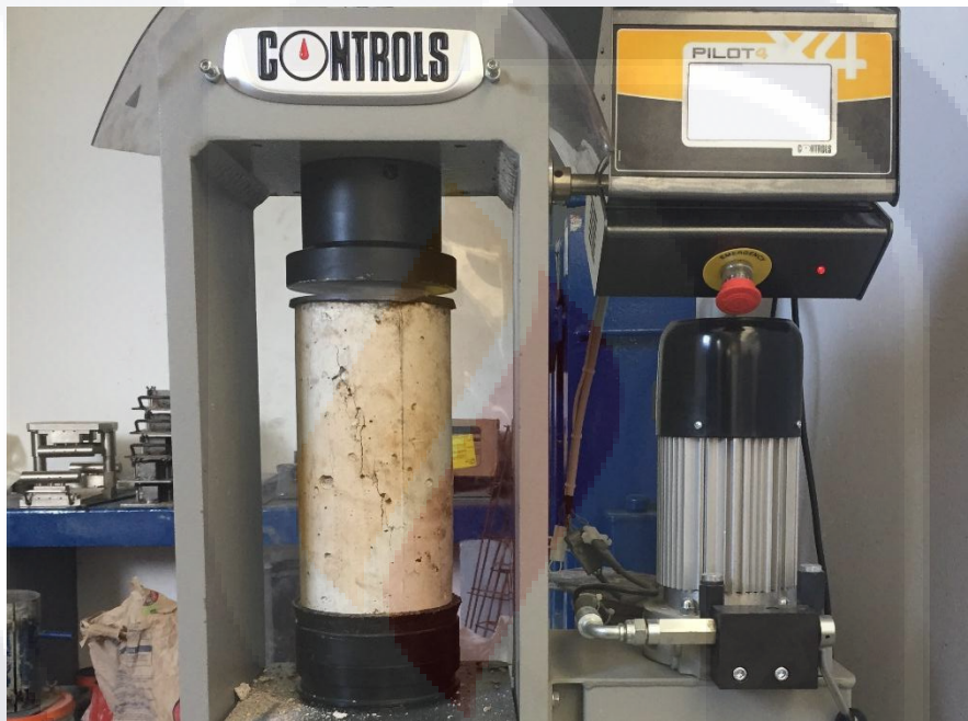
Ilustración 16 Cilindro en ensayo de compresión (UAA, 2016).
