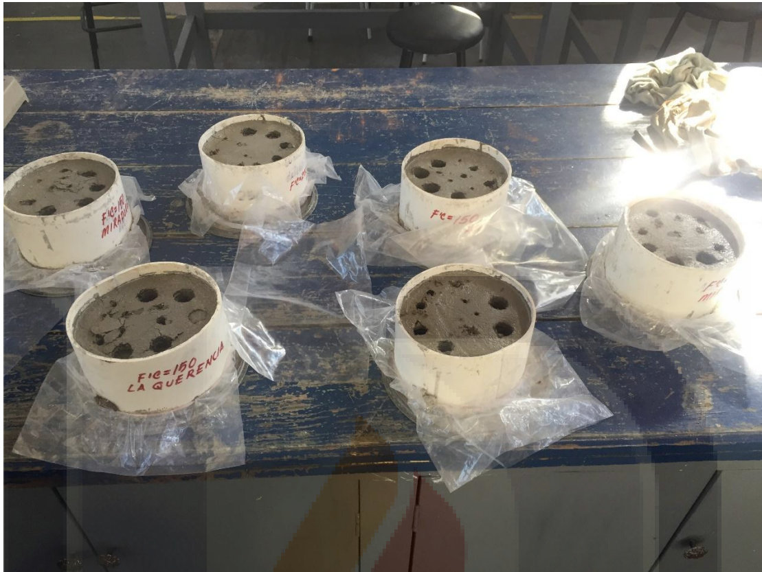
Ilustración 12 Algunas de las muestras donde se midió el tiempo de fraguado (UAA, 2016).
