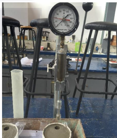
Ilustración 11 Penetrómetro junto con muestra de mortero (UAA, 2016)
