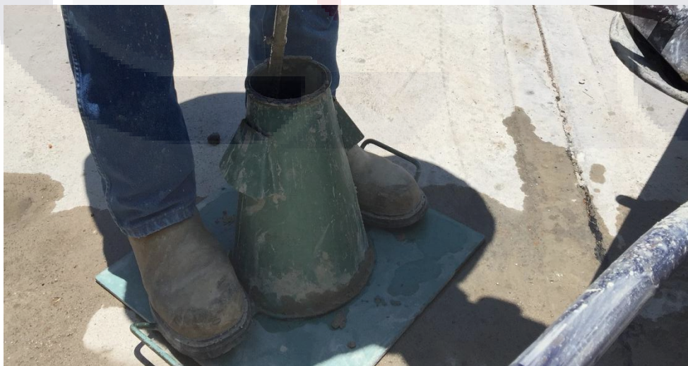
Ilustración 8 Compactado por varillado (UAA, 2016)
