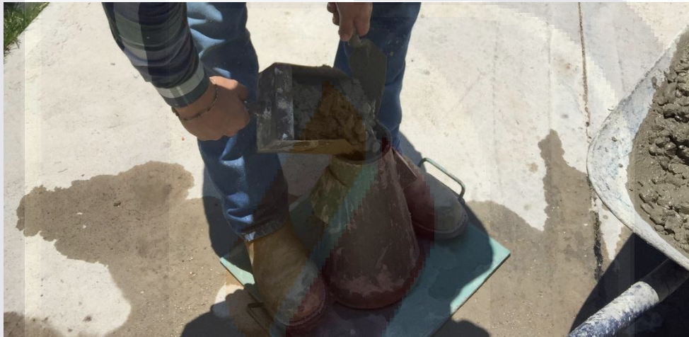
Ilustración 7 Llenado de cono de revenimiento con mezcla elaborada para la presente investigación (UAA, 2016)
