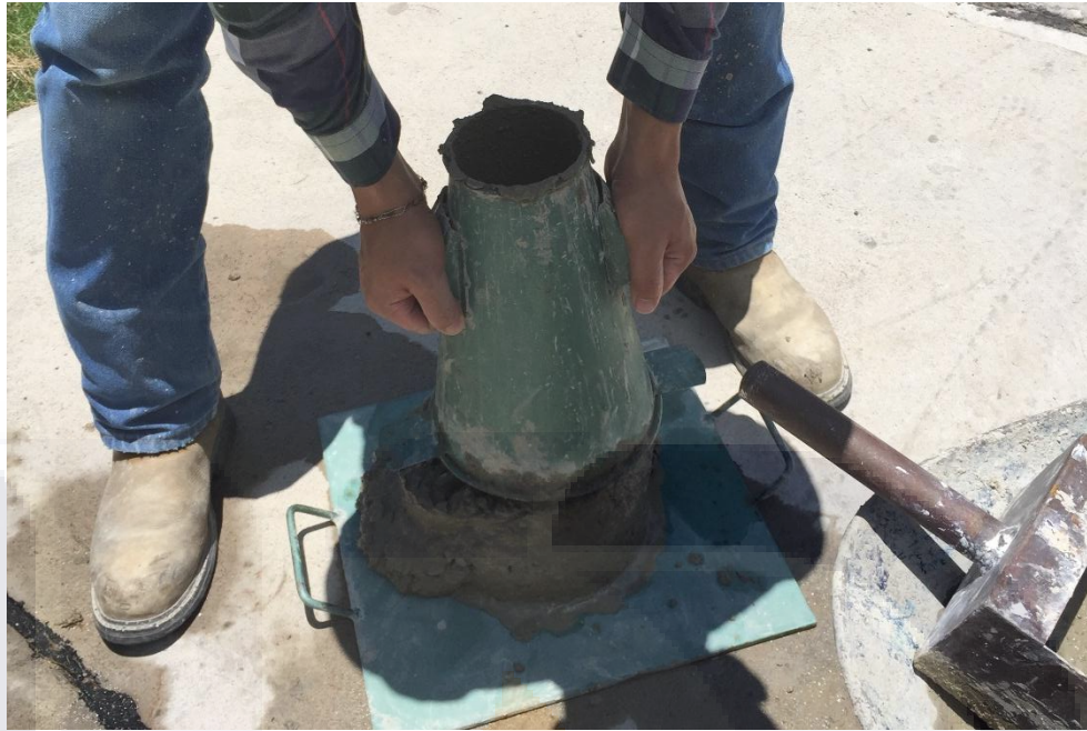
Ilustración 9 Retiro del cono para la medición del revenimiento (UAA, 2016).
