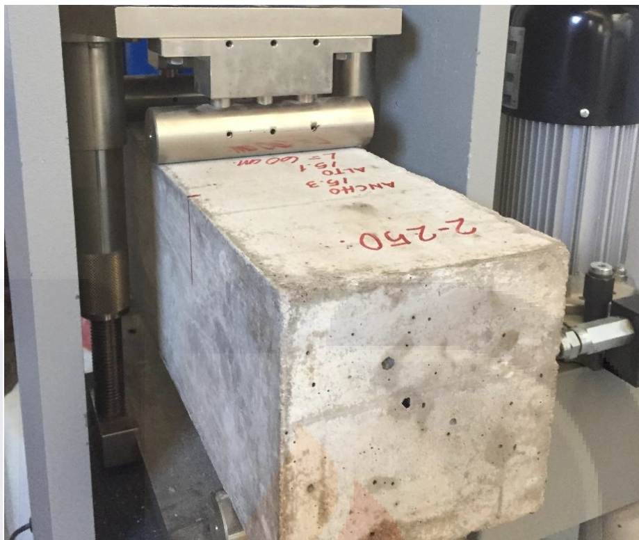
Ilustración 18 Viga ensayada a flexión (UAA, 2016).
