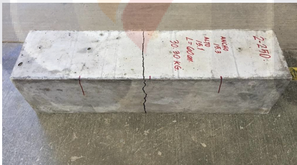
Ilustración 19 Viga después del ensayo a flexión con su línea de falla (UAA, 2016).
