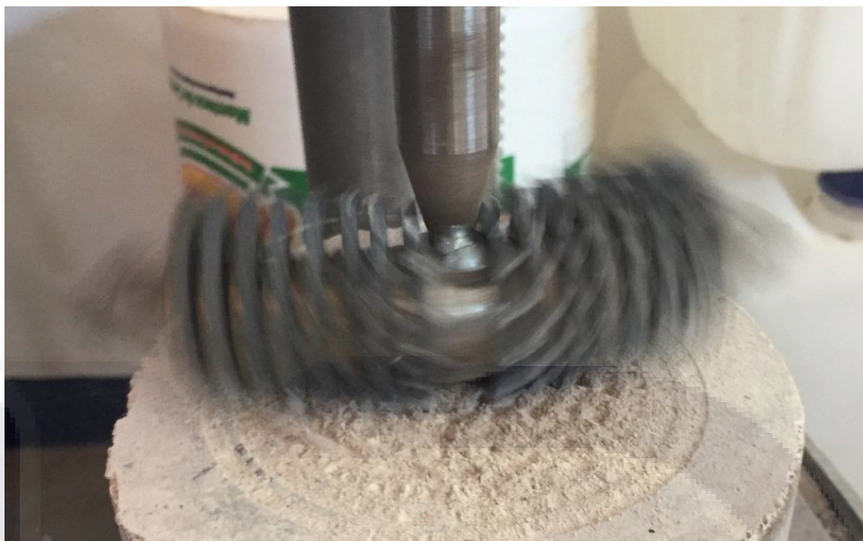
Ilustración 20 Realización de prueba de abrasión a espécimen elaborado en la presente investigación (UAA, 2016).
