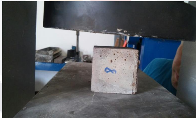
Figura 59 Ensayo a compresión del mortero para pegar piezas.
