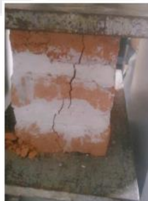
Figura 63 Fallo por aplastamiento de la pila de mampostería.
