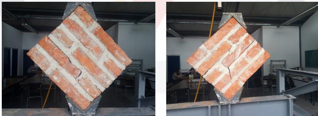
Figura 64 Fallo del murete: se observó un fallo deslizamientos de las juntas con inicio de fisuración por tensión en las unidades.
