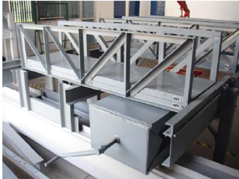
Figura 53 Dispositivo simulador de hundimientos desarrollado por (Araiza, 2011)
