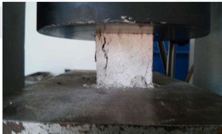
Figura 65 Prueba de cubos de mortero a compresión.
