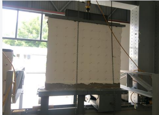
Figura 55 Construcción del muro ensayado: a) cadena de desplante sobre dispositivo simulador de hundimientos; b) muro de tabique rojo recocido y colado de la cadena de cerramiento; c) aplanado de yeso y cuadrícula para medición de desplazamientos.
