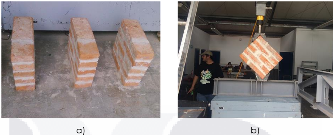
Figura 58 a) Muretes para obtener la resistencia a compresión diagonal, V_m^* ; b) murete en posición para aplicación de carga.
