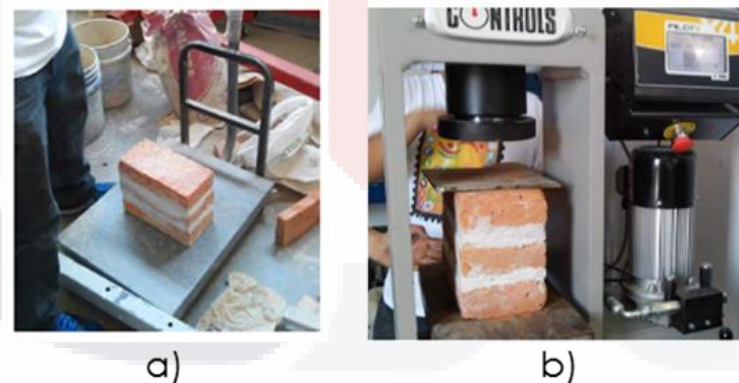
Figura 57 Pilas de tabique rojo recocido para obtener la resistencia a compresión, f_m^* : a) peso de la pila; b) ensayo de la pila.
