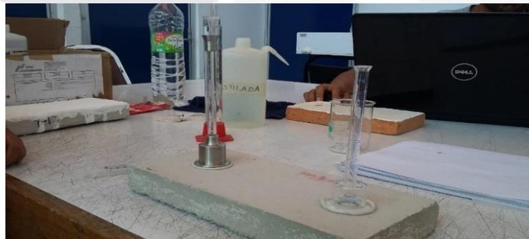
Figura 28 Permeabilidad Karsten en concreto  $f'c=200$  kg/cm<sup>2</sup>
