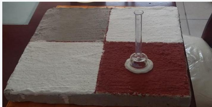
Figura 27 Permeabilidad en Mortero sobre I-4
