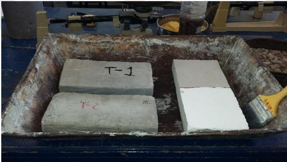
Figura 16 Aplicación de impermeabilizantes a probetas a ensayar
