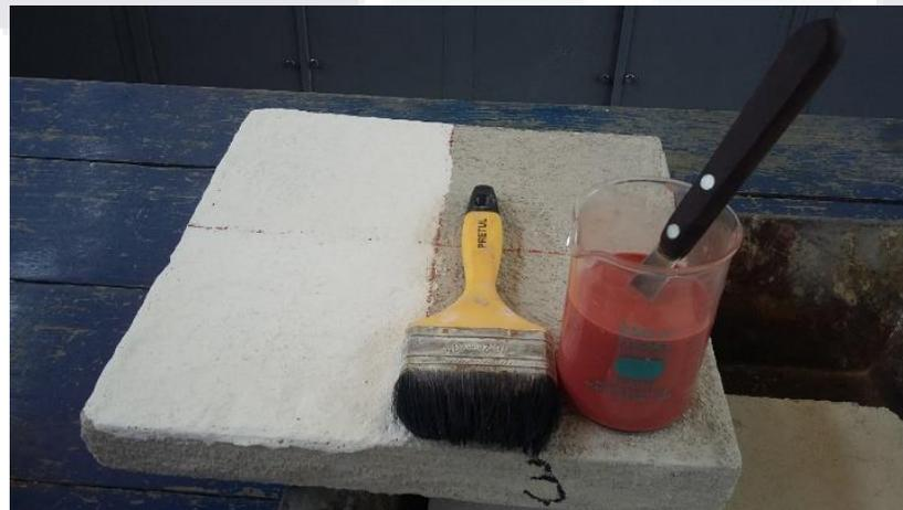
Figura 18 Aplicación de impermeabilizante I-4.
