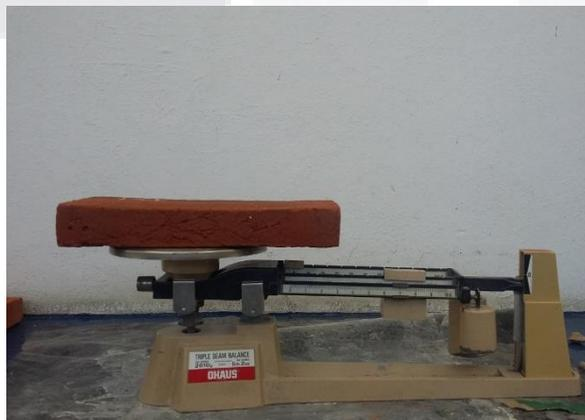
Figura 21 Determinación de la masa de una probeta
