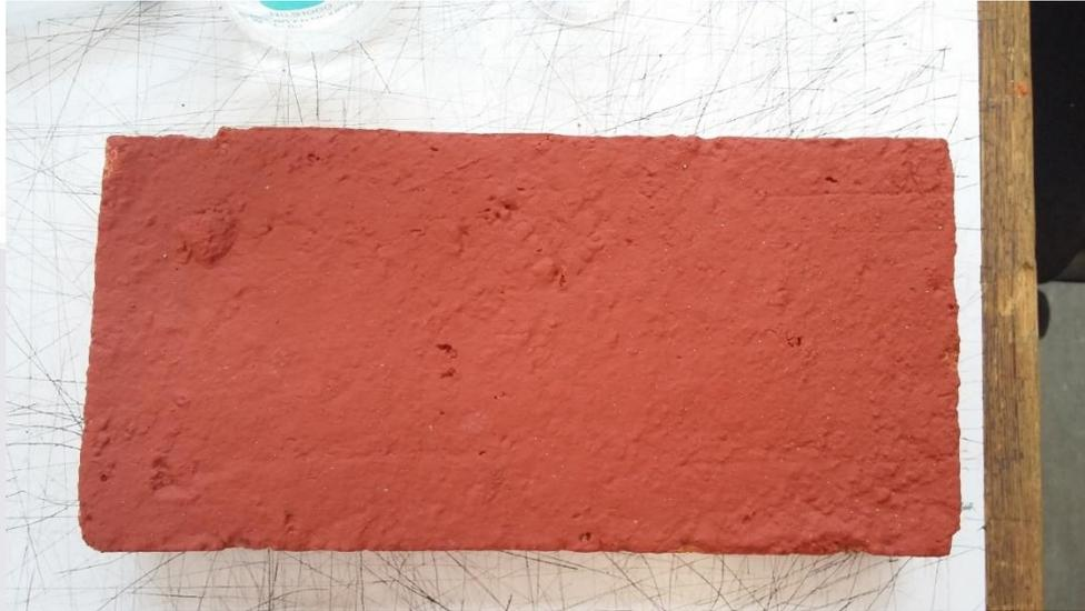
Figura 35 Impermeabilizante Fester aplicado en ladrillo petatillo
