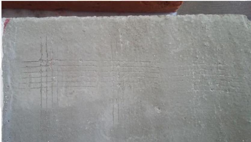
Figura 29 Prueba de adherencia sobre probeta
