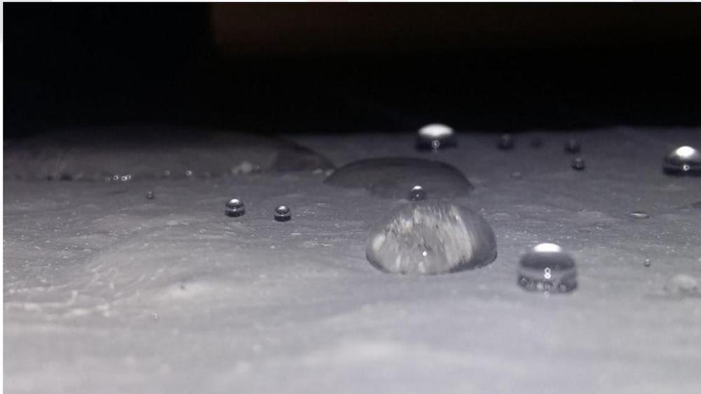
Figura 36 efecto impermeabilizante de mezclas naturales tradicionales
