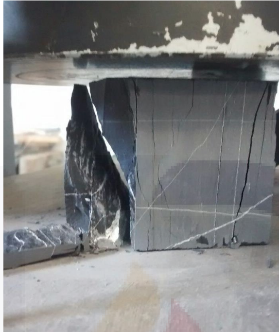
Imagen 59. Cubo PE fallado con visibles lajamiento.
