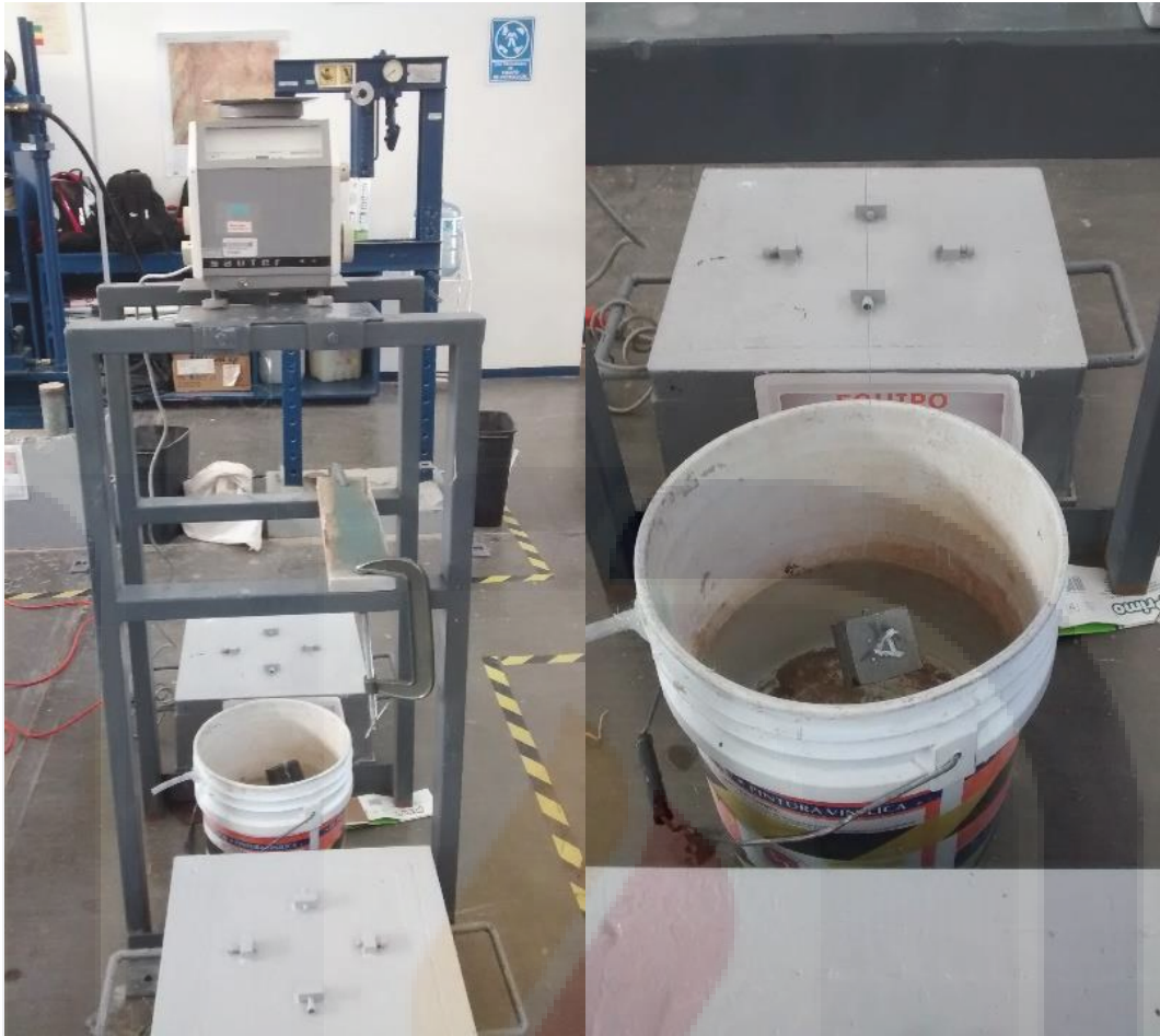
Imagen 55. Prueba de densidad por sumersión. Figura a, cubo suspendido de báscula; figura b, peso al aire del cubo PA.
