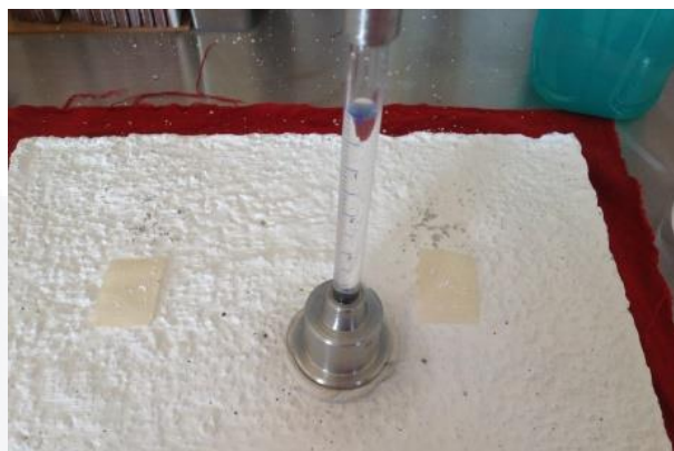
Figura 6. 10 Prueba de permeabilidad al panel de mortero en acabado rugoso con recubrimiento de la pintura PFN
