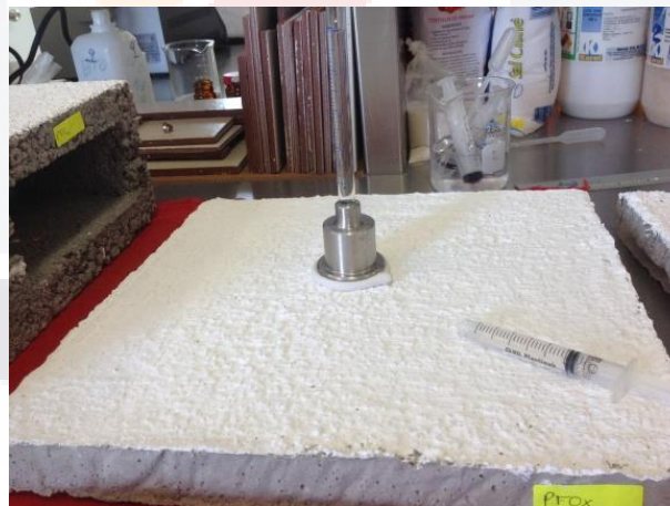
Figura 4.42 Prueba de permeabilidad en el panel de mortero en acabado rugoso, con un tiempo de 2 días de secado de la pintura PFOX.
