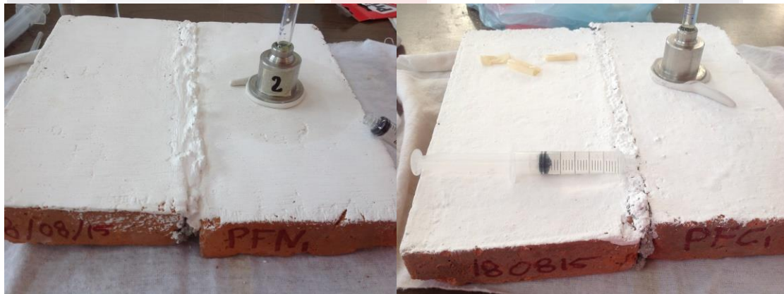
Figura 4.60 Prueba de permeabilidad en los paneles de tabique con 2 días de exposición al ambiente, panel cubierto con pintura PFN (a), panel cubierto con pintura PFC1 (b).
