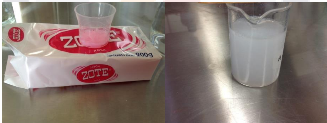
Figura 4.24 Disolución del jabón en agua para la producción de la pintura PFR.
