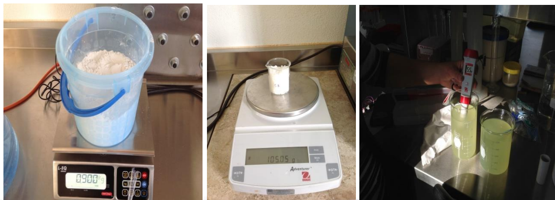
Figura 3. 26 Medición de los materiales para la fabricación de la pintura PFN.
