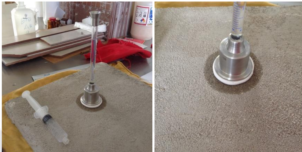
Figura 4.9 Prueba de permeabilidad del mortero en acabado fino sin la aplicación de alguna pintura.
