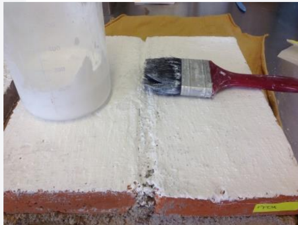
Figura 5. 4 Acabado después de la segunda capa de recubrimiento de la pintura PFOX.
