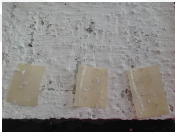
Figura 4.96 Área de corte de la prueba de adherencia sobre el panel de mortero con acabado rugoso con PFN aplicada en la superficie.
