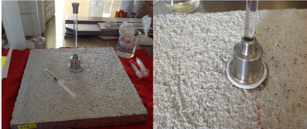
Figura 4.11 Prueba de permeabilidad con el tubo Karsten en mortero con acabado rugoso sin recubrimiento alguno.
