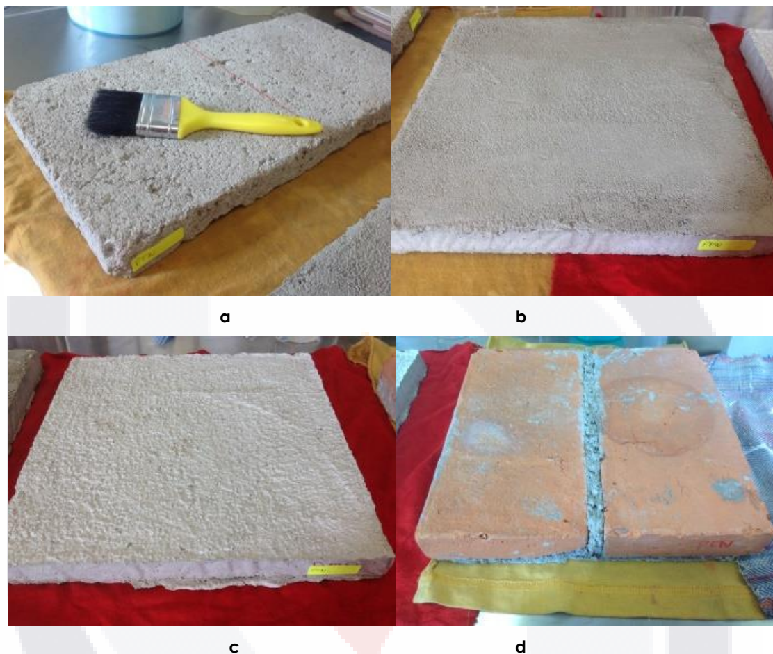
Figura 5. 1 Superficies utilizadas para la aplicación de las pinturas. (a) Block, (b) mortero acabado fino, (c) mortero acabado rugoso y (d) tabique.
