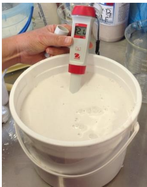
Figura 4.32 Medición de pH en la pintura PFOX.
