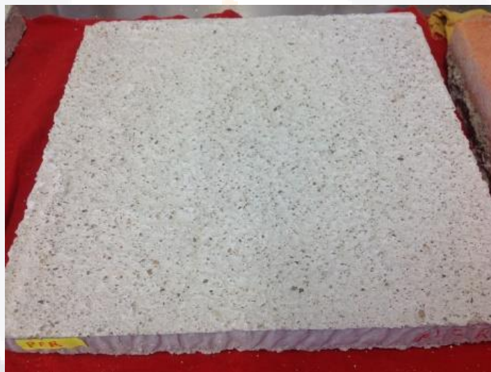
Figura 3. 10 Terminado del mortero con acabado rugoso, aplicando la llana como instrumento para el terminado.
