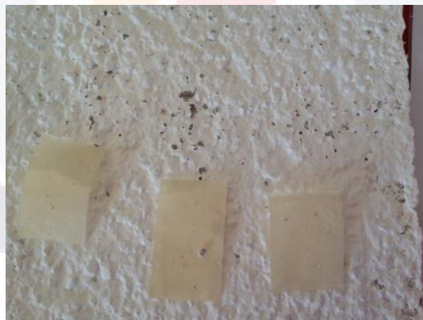
Figura 4.104 Panel de mortero rugoso con las áreas de corte para la prueba de adherencia en el tiempo T-3 de la pintura PFC1.
