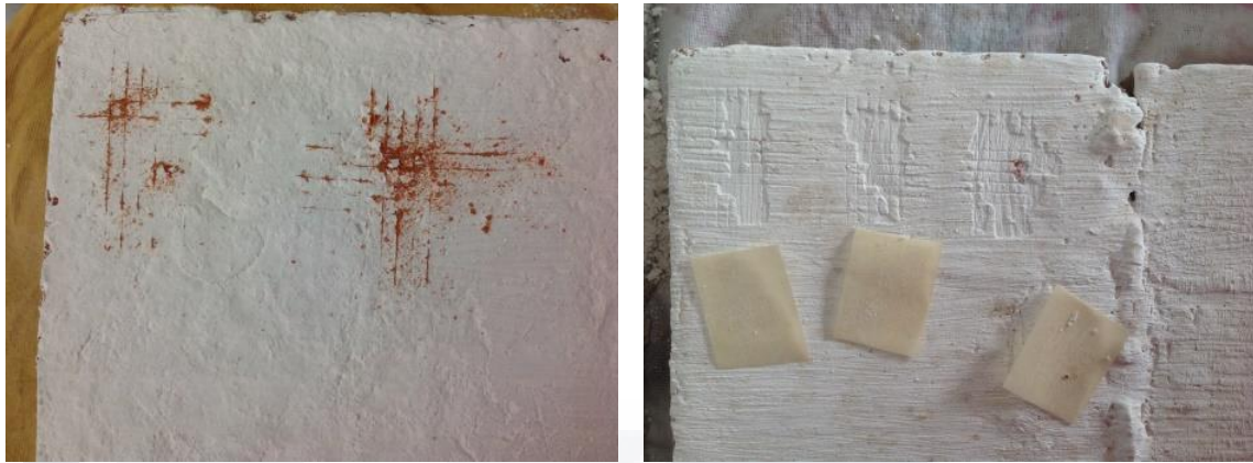
Figura 4.82 Capacidad de adherencia de los paneles de tabique para la pintura PFC2 (a) y PFN1 (b), en el tiempo T-1
