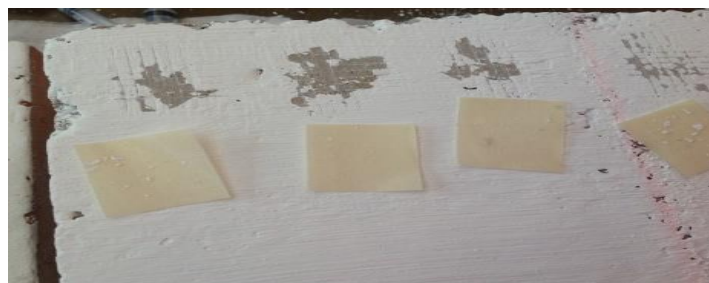
Figura 4.108 Panel de block con las áreas de corte para la prueba de adherencia en el tiempo T-1 de la pintura PFN1.
