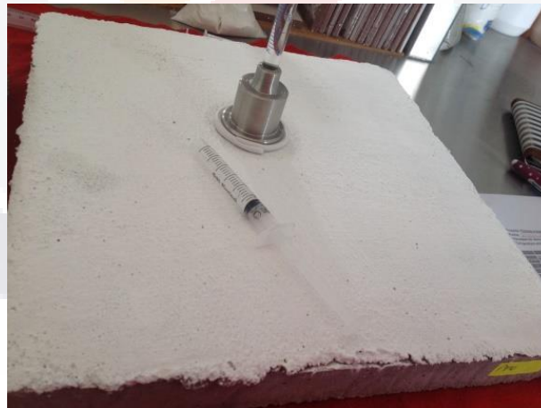
Figura 4.48 Proceso de la prueba de permeabilidad en el panel de mortero de acabado fino con la aplicación de PFN sobre la superficie.
