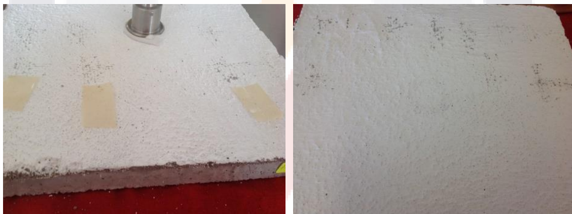
Figura 4.101 Resultados de porcentaje de remoción de las películas de las distintas pinturas analizadas en los paneles de mortero acabado fino ubicados dentro del laboratorio, en el tiempo T-3.
