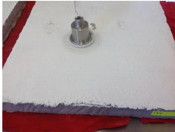
Figura 4.56. Prueba de permeabilidad de la pintura con mayor absorción sobre la superficie de mortero en acabado fino.
