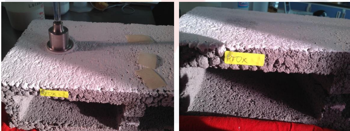
Figura 4.53 Resultados de la prueba de permeabilidad de los paneles de block con recubrimiento aplicado con 16 días de anterioridad.
