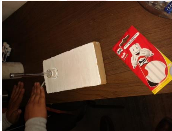
Figura 3. 41 Unión del tubo Karsten con el panel de tabique, utilizando adhesivo.
