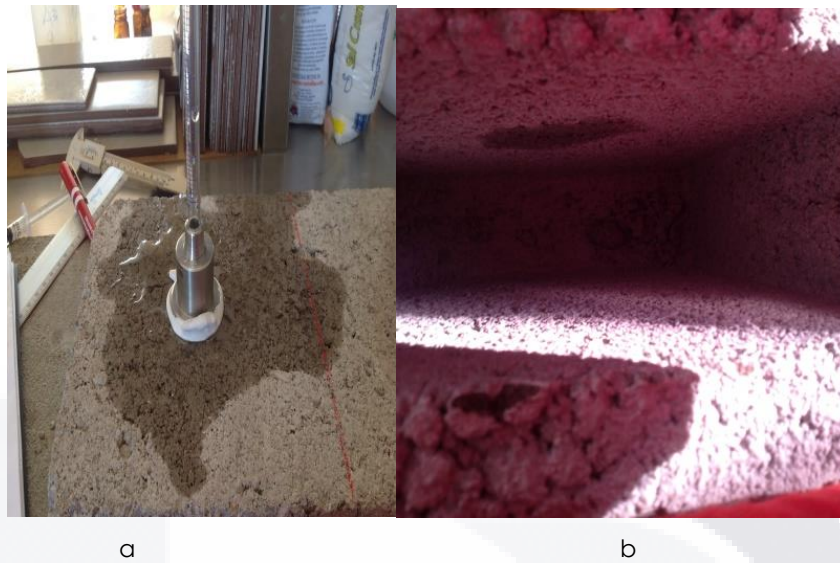
Figura 4.38 Panel de block si recubrimiento (a), panel de block con recubrimiento en el tiempo T-1 (b)
