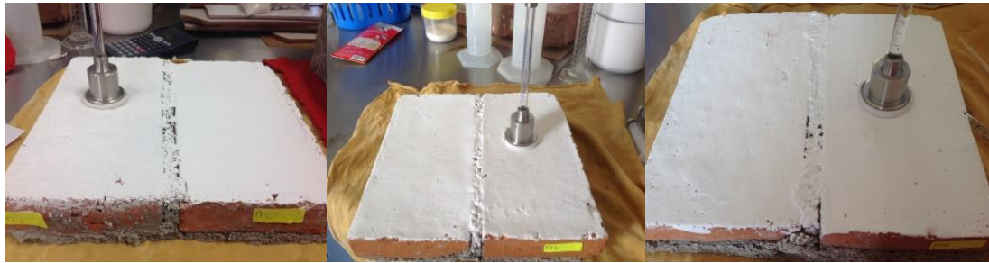
Figura 4.34 Prueba de permeabilidad en el tabique, con dos 2 días transcurridos de la aplicación de PFC1, PFN, PFR respectivamente.
