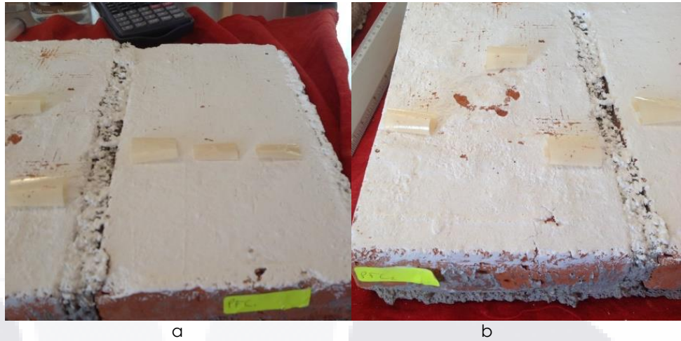
Figura 4.98 Área de corte de los paneles de tabique de las pinturas PFC1 (a) y PFC2 (b).
