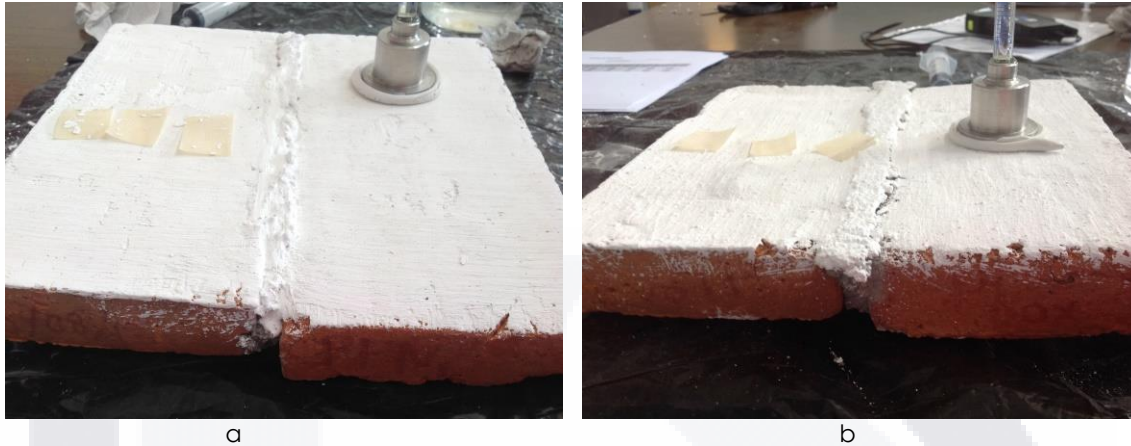
Figura 4.68 Prueba de permeabilidad en el tabique con la superficie cubierta por la pintura PFN1 (a) y PFOX (b).
