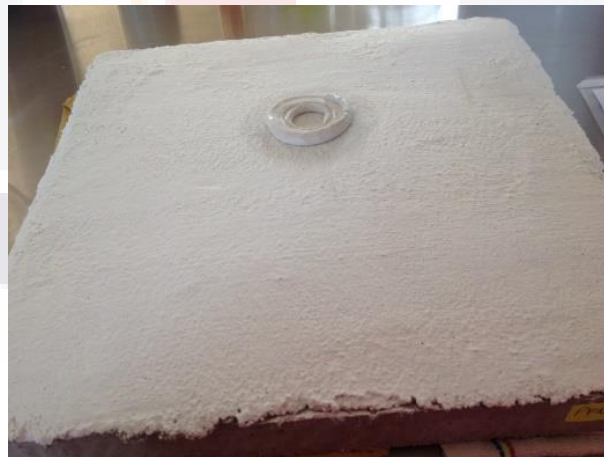
Figura 4.39 Panel de mortero en acabado fino con PFN aplicada en la superficie.
