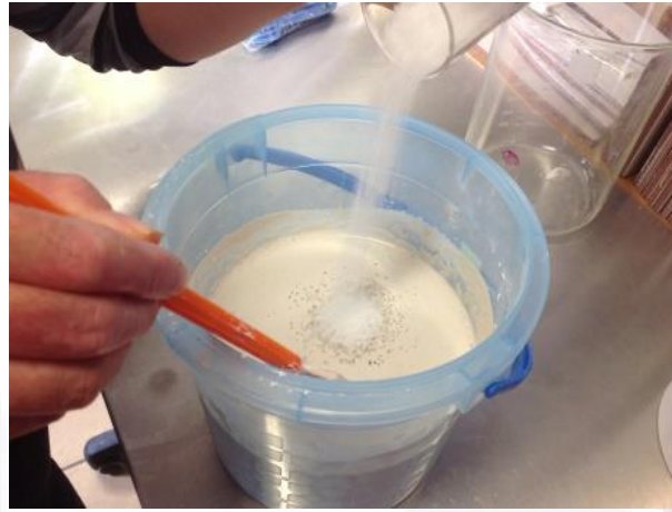
Figura 4.21 Adición de la sal entera en grano a la solución de cal con agua.
