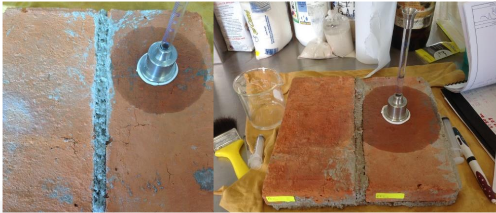
Figura 4.3 Prueba de permeabilidad en el tiempo T-0 sin recubrimiento sobre el tabique.
