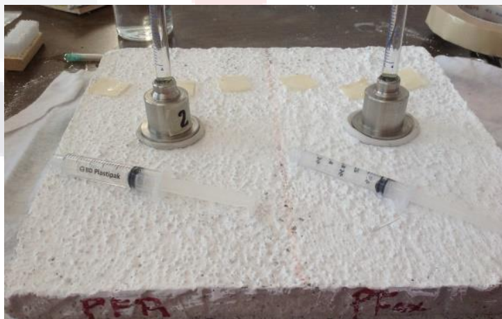
Figura 4.66 Prueba de permeabilidad sobre los paneles de mortero en acabado rugoso, durante el tiempo T-1 de exposición al exterior.
