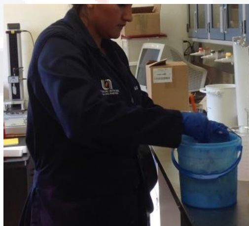
Figura 4.20 Paso dos, mezclado de la cal con el agua destilada.
