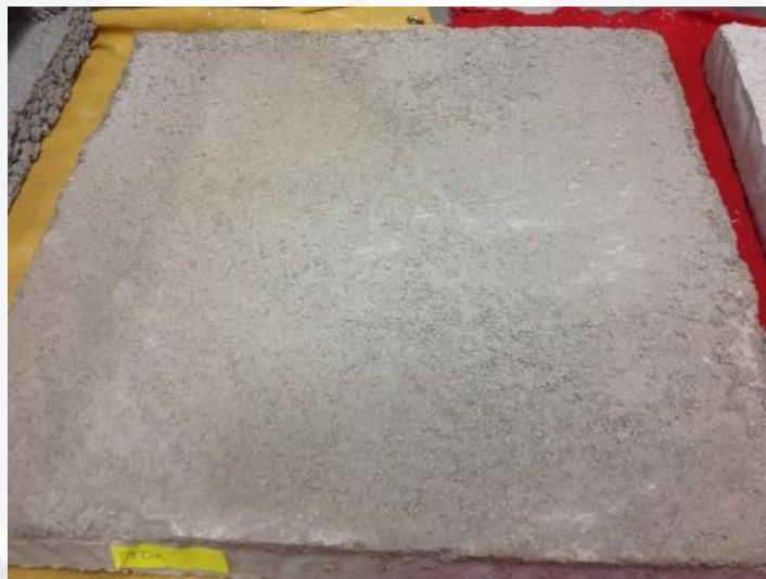
Figura 3. 9 Terminado del mortero con acabado fino, aplicando la llana como instrumento.
