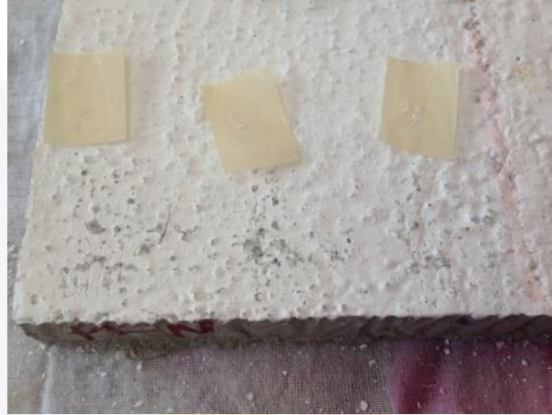
Figura 4.111 Panel de mortero en acabado rugoso con las áreas de corte para la prueba de adherencia en el tiempo T-1 de la pintura PFN.
