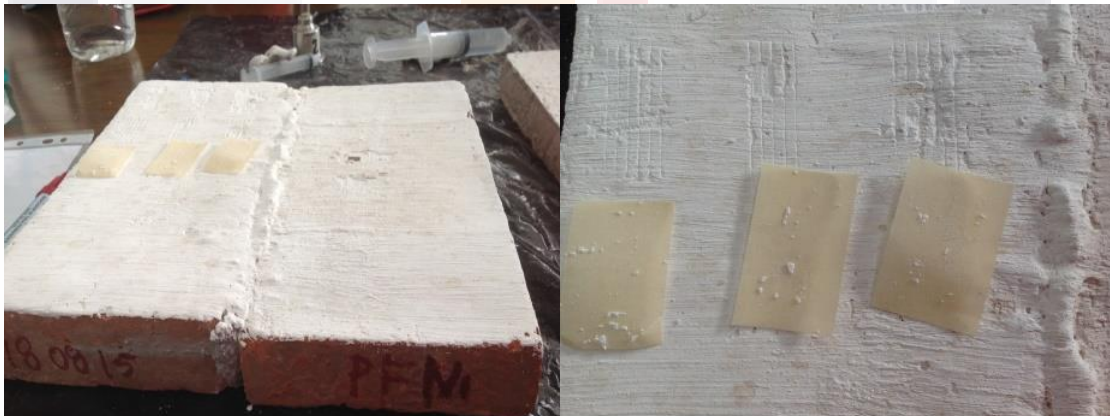
Figura 6. 16 Área de corte del panel de tabique con el recubrimiento de PFN1
