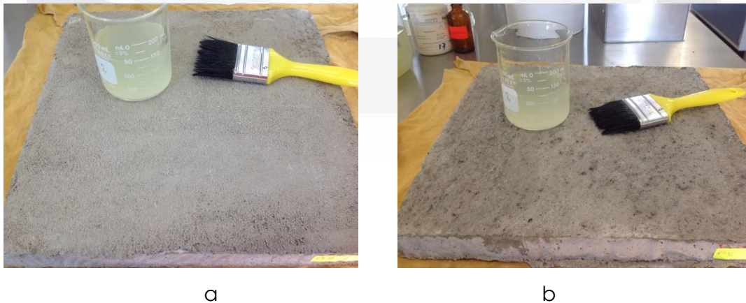
Figura 4.12 Superficie más lisa del mortero en acabado fino (a), mortero en acabado rugoso muestra espacios vacíos (b).
