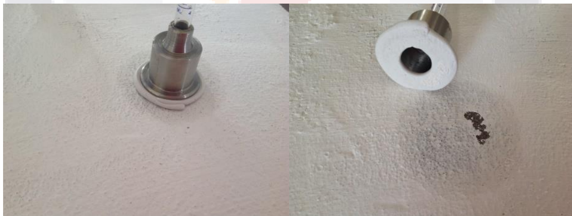
Figura 6. 8 Absorción de la pintura formulada con mucilago de nopal PFN sobre el panel de mortero en acabado fino.
