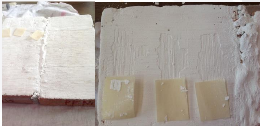
Figura 4.90 Área de rasgado del panel de tabique con el recubrimiento de PFN1.
