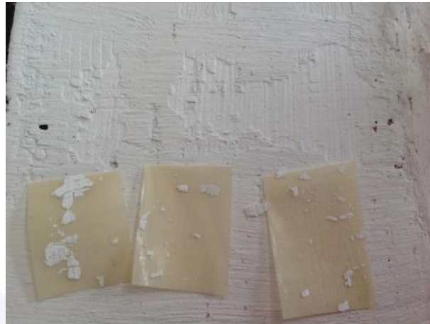
Figura 4.114 Clasificación 5B (0% de remoción) en el panel de tabique con el recubrimiento de PFN1.
