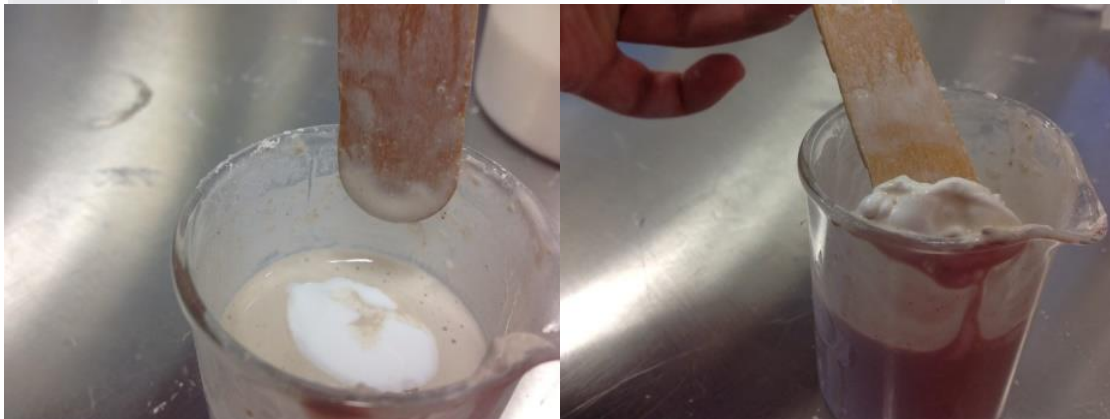
Figura 4.26 Fenómeno presentado al agregar el resistol en la solución de cal, agua y jabón.
