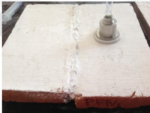
Figura 4.75 Absorción de agua de PFN1 en la prueba T-3, sobre el panel de tabique.
