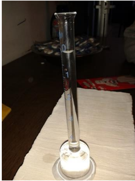
Figura 3. 42 Llenado al nivel máximo del tubo Karsten con agua destilada.
