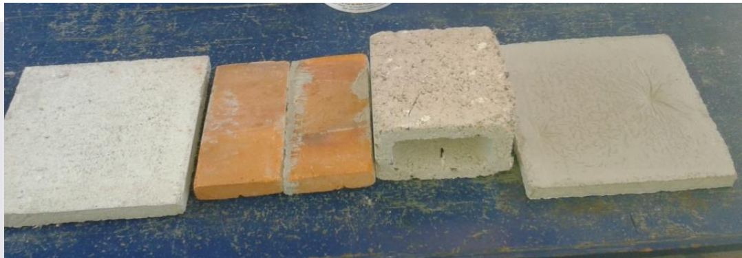
Figura 3. 2 Paneles empleados para la implementación de pruebas asignadas a las distintas pinturas.
