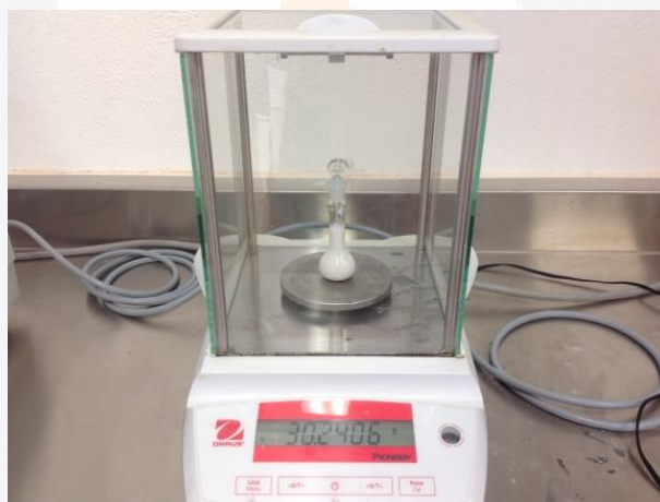
Figura 4.33 Prueba de densidades de las pinturas, utilizando el picnómetro de 10 ml y la balanza analítica.
