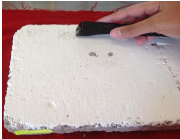
Figura 3. 45 Rasgado con la navaja del Kit de adherencia realizado en la superficie del panel.
