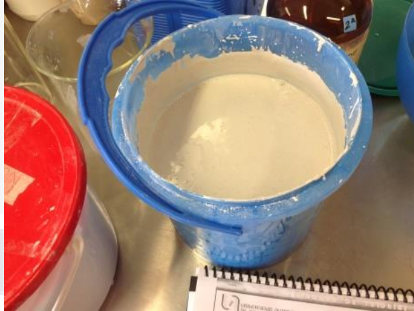
Figura 4.28 producto final de la receta tradicional de la pintura artesanal base cal formulada con resistol y jabón.
