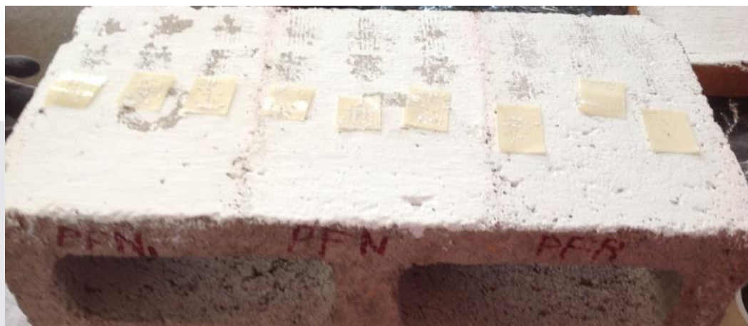
Figura 4.116 Panel de block con las áreas de corte para la prueba de adherencia en el tiempo T-2 de las pinturas PFN1, PFN y PFR, respectivamente.
