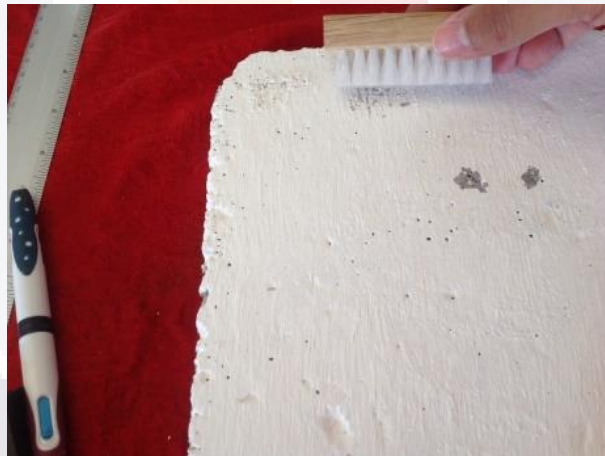
Figura 3. 46 Limpieza del área de corte en la prueba de adherencia.
