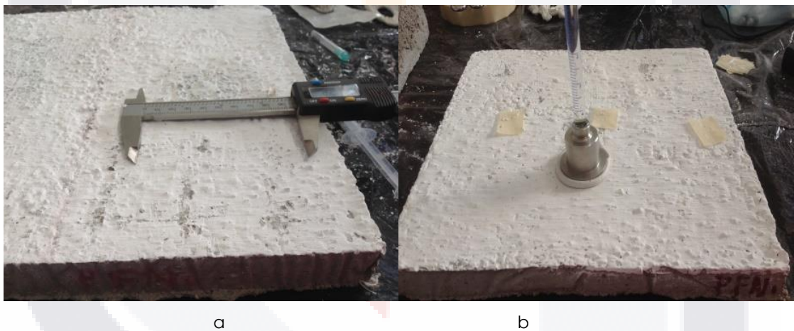
Figura 4.72 Medición del área humedecida por la cantidad de absorción permitida en el panel de mortero con acabado rugoso en el tiempo T-2 de la pintura PFN1 (a), prueba de permeabilidad en el tiempo T-2 del panel expuesto a la intemperie (b).
