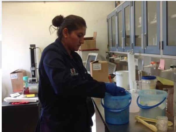
Figura 3. 32 Se mezcla el agua con la cantidad de cal mencionada en el recetario para la producción de la pintura PFR.
