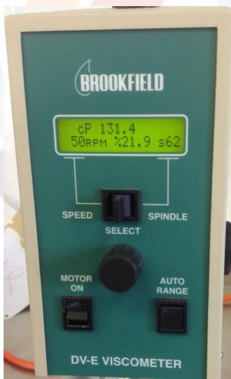
Figura 4.30 Viscosímetro BROOKFIELD DV-E, con 3 resultados de una prueba realizada a un fluido.
