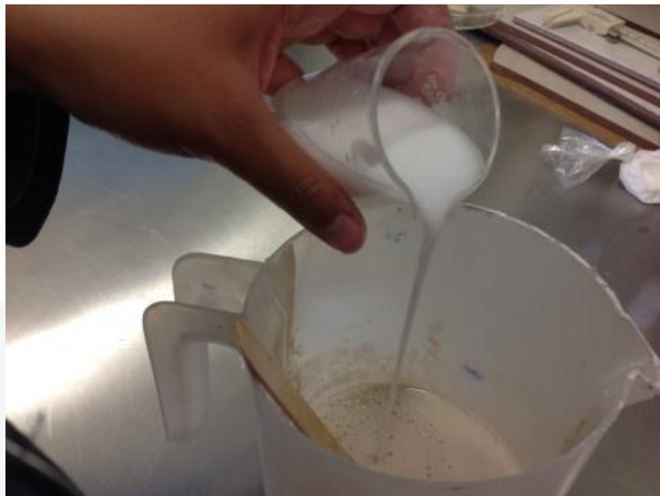
Figura 3. 33 Mezcla de los todos los ingredientes para la producción de la pintura PFR.
