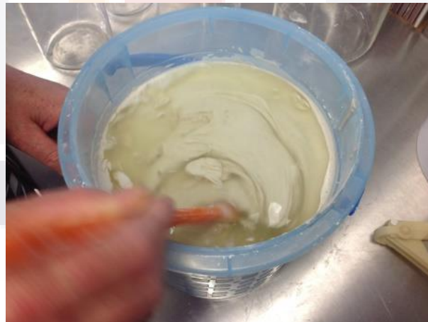
Figura 4.22 Integración del adhesivo a la pintura base cal.
