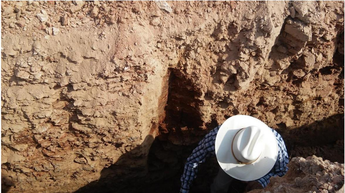
Figura 1- Proceso de infiltración sobre una falla.
