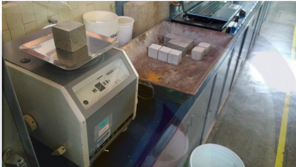
Imagen 89 Pesado de especímenes durante periodo de secado en ensayo de "tendencia de pérdida de humedad".
