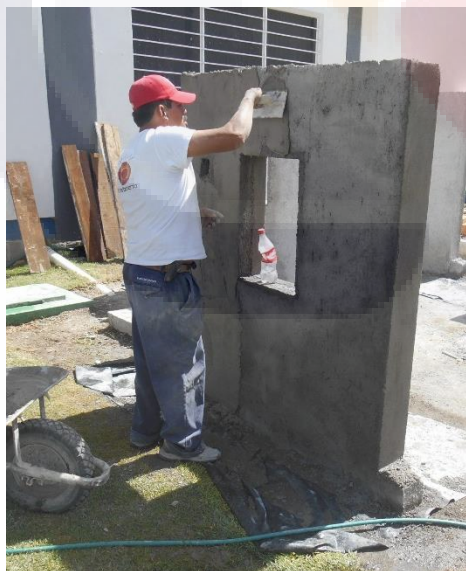
Imagen 39 (Izq.) Aplicación de mortero fino de MCEM sobre MBC 1-A. (Der.) Aplicación de mortero fino de MCCA sobre MBC 2-A.
