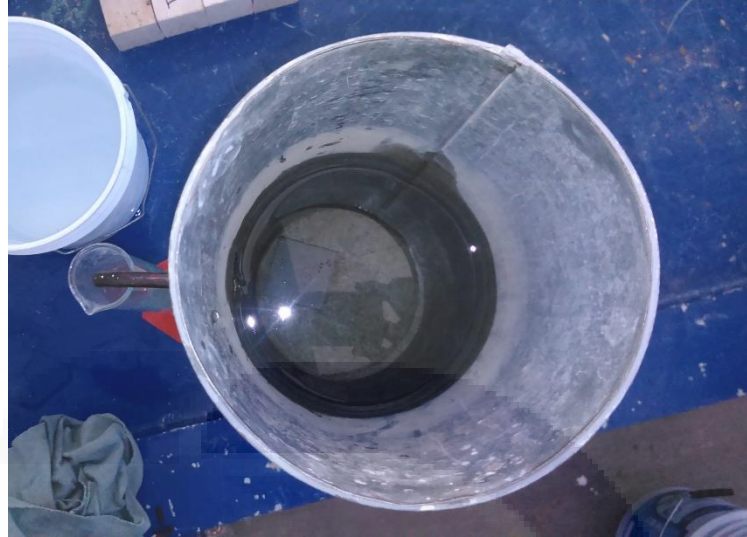
Imagen 87 Cuantificación de volumen de especímenes mediante desalojo de agua de picnómetro.
