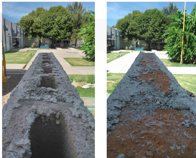
Imagen 36 Cantos superiores de muretes sin aplanar. (Izq.) MBC 2, (Der.) MTR 1.
