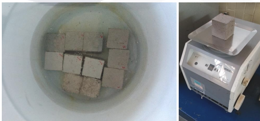
Imagen 86 Saturación de especímenes y pesado especímenes saturados.
