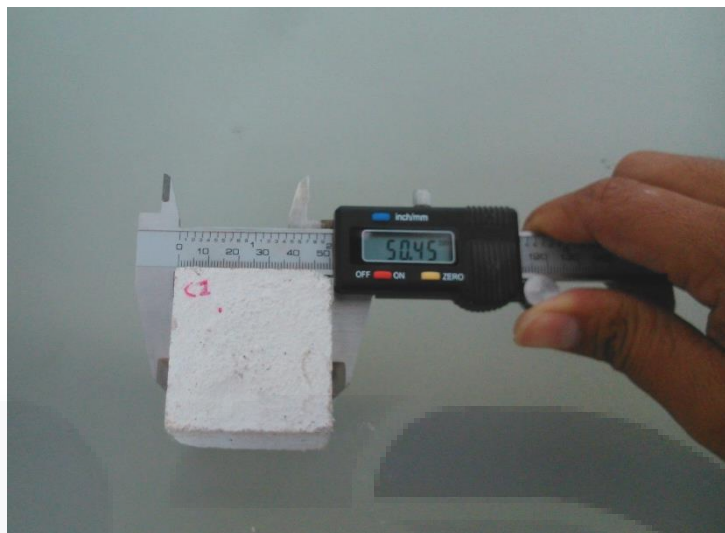
Imagen 91 Medición de los lados de las caras de los especímenes con calibrador vernier para calcular superficie por recibir carga en ensayo de resistencia a la compresión.
