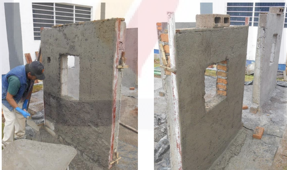
Imagen 33 (Izq.) Aplicación de repellado de MCEM sobre MBC 1-A. (Der.) Repellado concluido de MCEM sobre MTR 2-B (adelante) y de MCAL sobre MBC 2-B (atrás).
