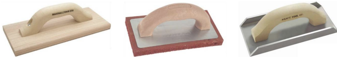
Imagen 6 Herramientas implementadas para lograr distintos acabados en aplanados de mortero. Izquierda: plana, centro: flota, derecha: llana metálica. (Herramientas, 2016).
