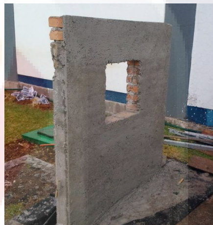
Imagen 30 Repellados de MCPA sobre MBC 1-B (Izq.) y de MCCA sobre MTR 1-B (Der.).
