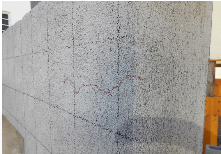
Imagen 44 Registro de fisuras con lápiz de cera en MTR 2-A-MCPA.
