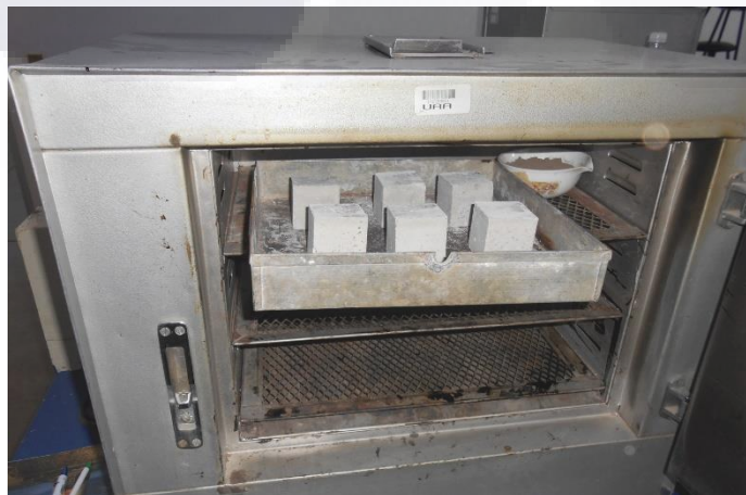
Imagen 88 Especímenes de mortero en horno de secado.
