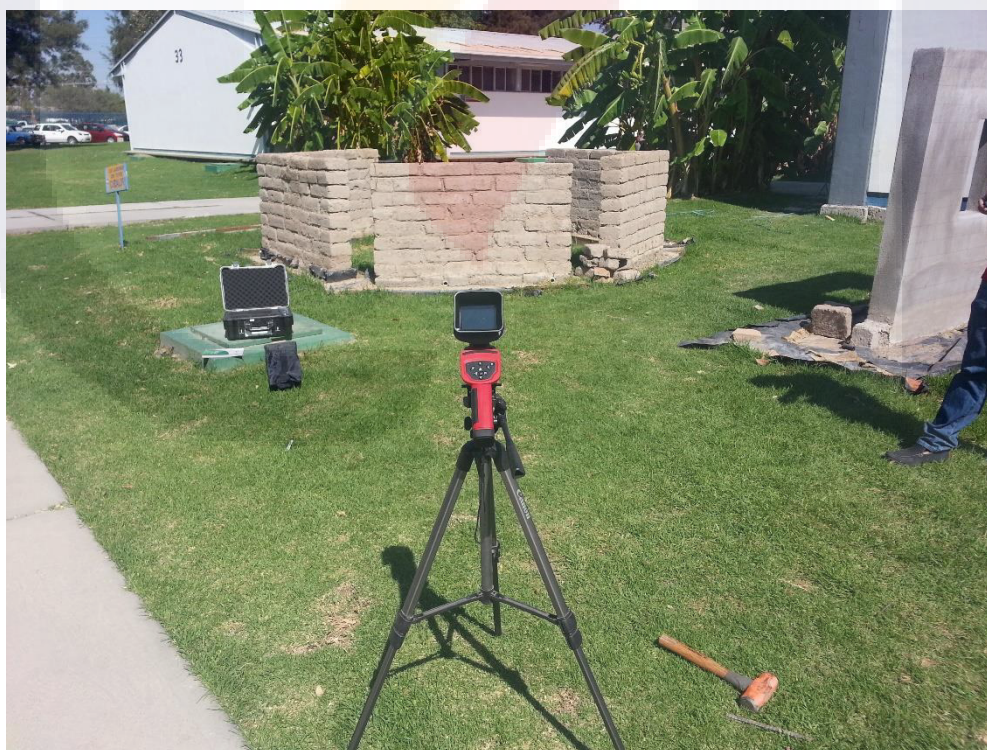
Ilustración 68 Colocación cámara para termografía.
