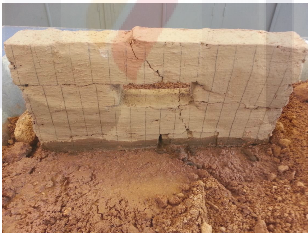
Ilustración 19 Elemento ensayado dañado
