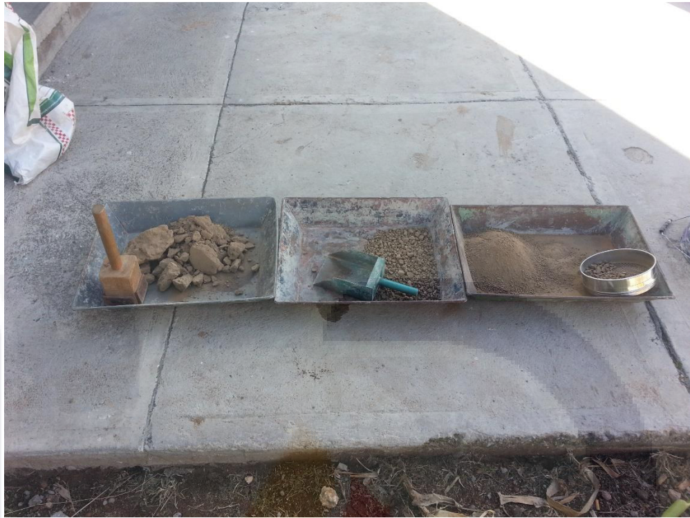
Ilustración 1 Etapas de disgregación del adobe.
