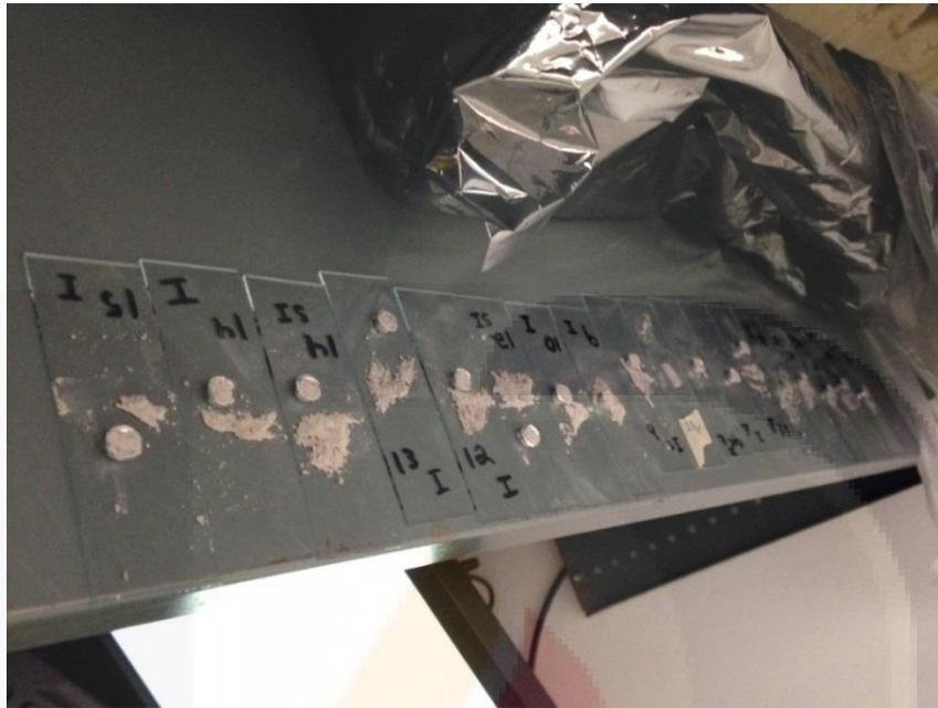
Figura 26. Polvo de cemento de las muestras de concreto hidráulico irradiado para espectroscopia Raman.
