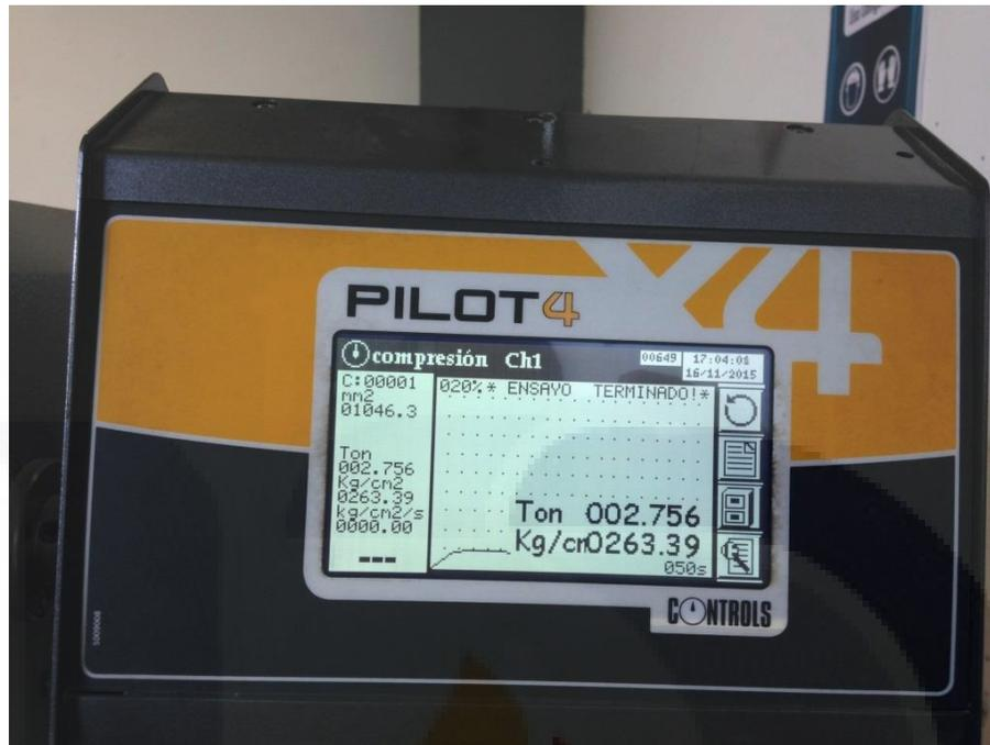
Figura 32. Resultados de resistencia a la compresión, en pantalla de prensa hidráulica.
