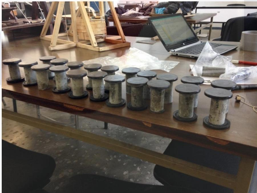
Figura 31. Muestras cabeceadas con azufre listas para ser ensayadas a la compresión.
