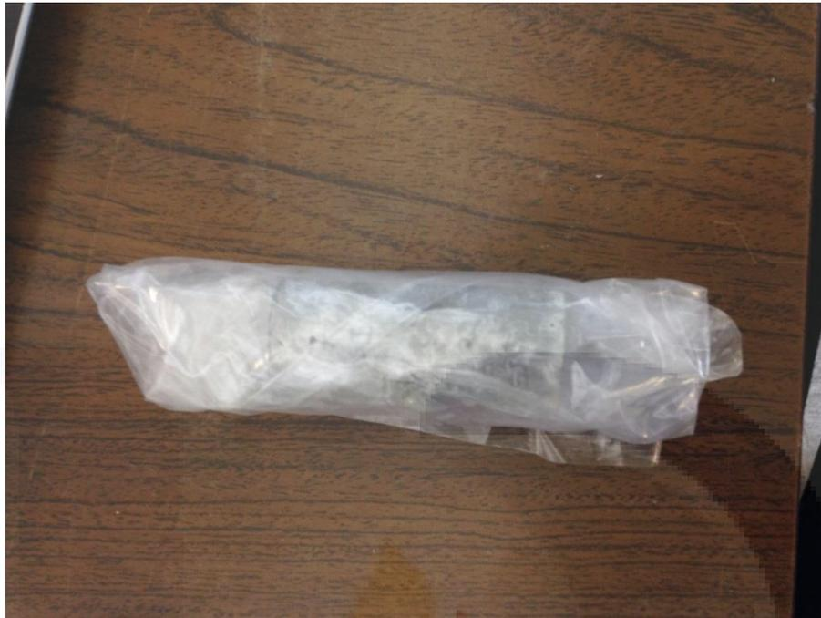
Figura 30. Muestra en proceso de sellado para evitar contaminación, previo a la obtención de polvo de cemento.
