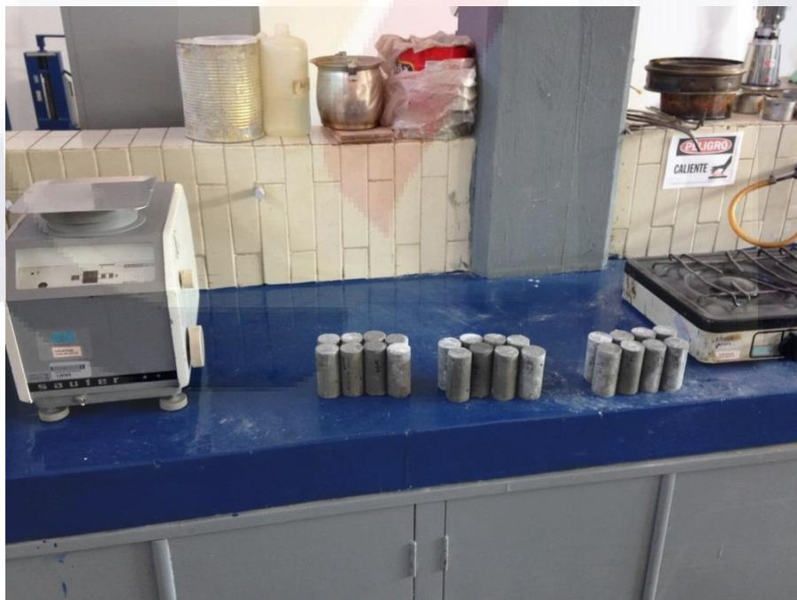
Figura 37. Pesaje en báscula de precisión de las muestras de concreto hidráulico.
