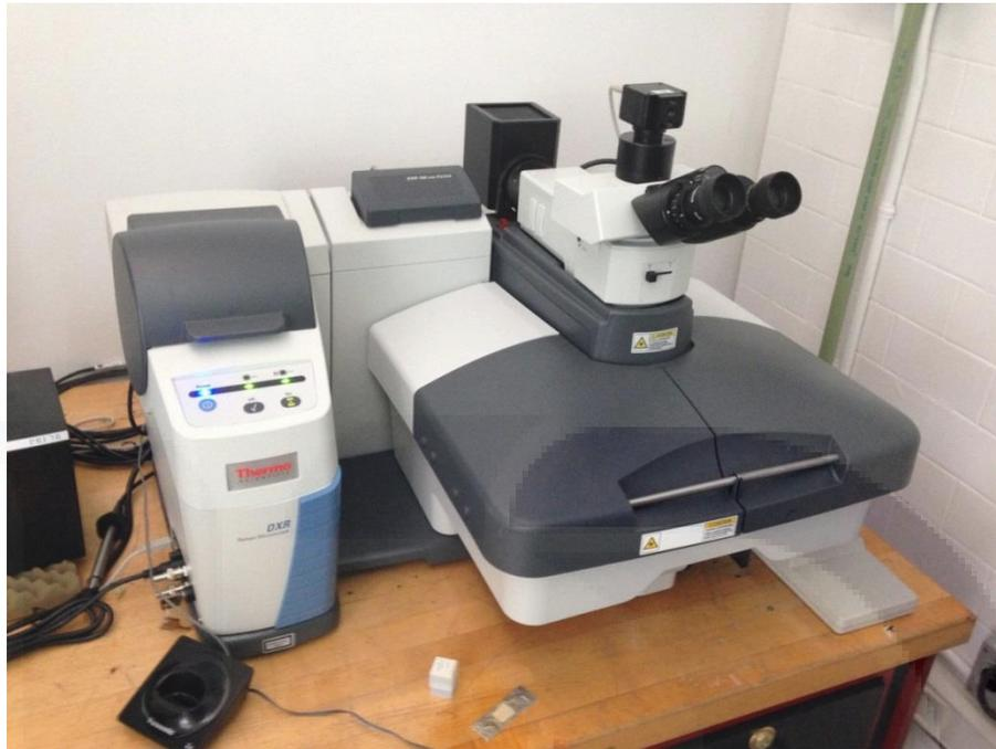
Figura 38. Ensaye en proceso en microscopio Raman para obtención de espectro de polvo de cemento.
