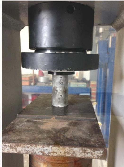
Figura 34. Muestra colocada en prensa hidráulica lista para ensayar.
