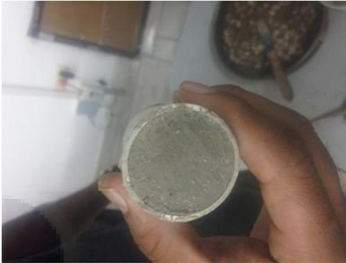
Figura 3 (izquierda). Las fisuras en la superficie superior del cilindro de concreto hidráulico desaparecen cuando la muestra es sometida a una radiación con potencia de 3.5 Watts.
