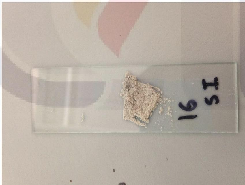
Figura 27. Polvo de cemento de muestra sin irradiar de concreto hidráulico para espectroscopia Raman.
