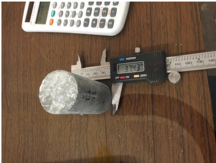
Figura 36. Medición de muestras de concreto hidráulico con Vernier digital.
