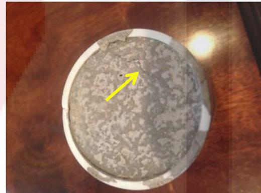
Figura 1 (izquierda). Se observa en la superficie inferior del cilindro de concreto hidráulico las fisuras por pérdida repentina de agua y por retracción térmica cuando la muestra es sometida a una radiación con potencia de 6.5 Watts.
