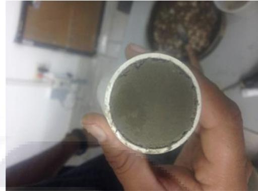
Figura 4 (derecha). Las fisuras en la superficie inferior del cilindro de concreto hidráulico desaparecen cuando la muestra es sometida a una radiación con potencia de 3.5 Watts.
