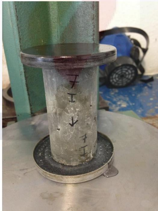
Figura 35. Cabeceado de muestra de concreto hidráulico.
