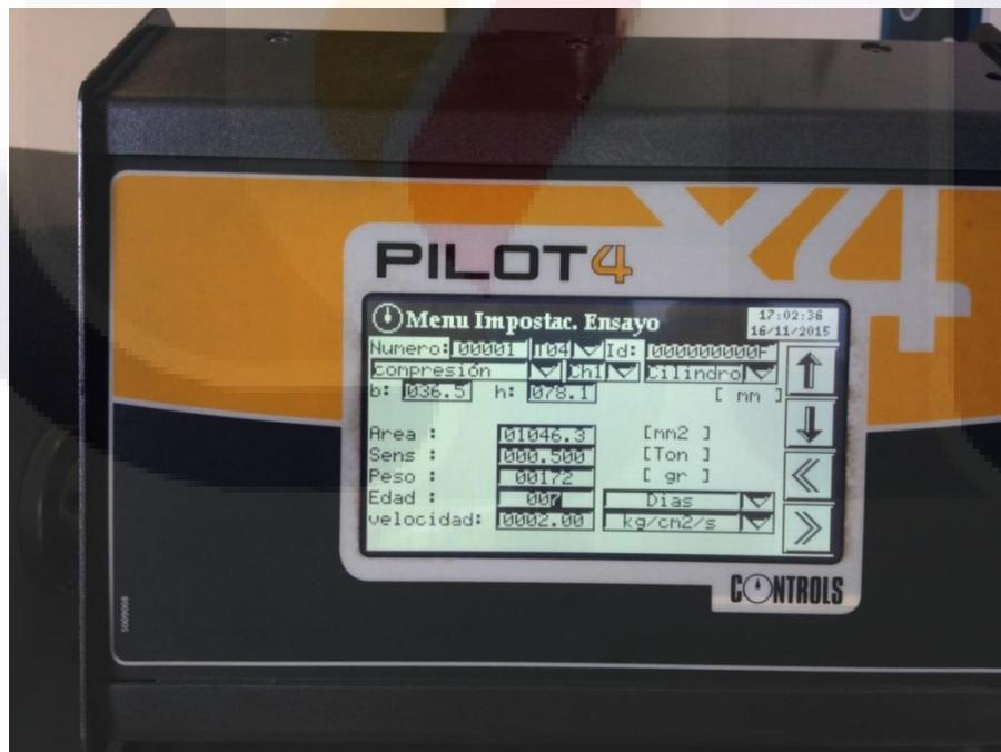
Figura 33. Pantalla en prensa hidráulica para introducir datos de la muestra a ensayar.
