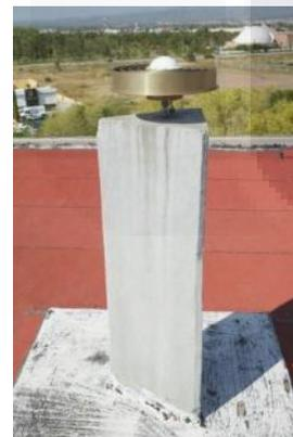
Figura 34.- Estación de referencia INEG de la red Geodésica Nacional Activa (RGNA).
