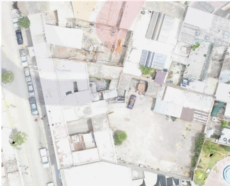
Figura 56.- Ortofoto generada con drones (UAV) y puntos de control geodésico en la zona de estudio.
