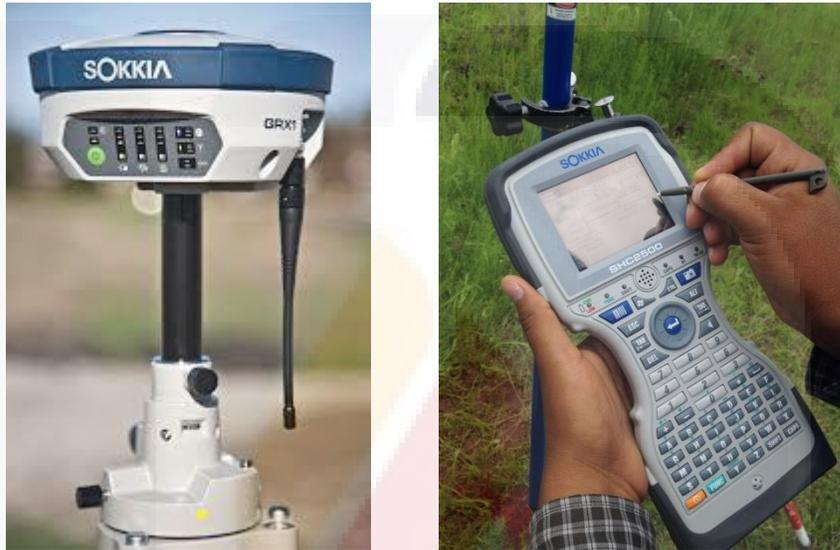
Figura 41.- Equipo GPS marca Sokkia modelo GRX-1
