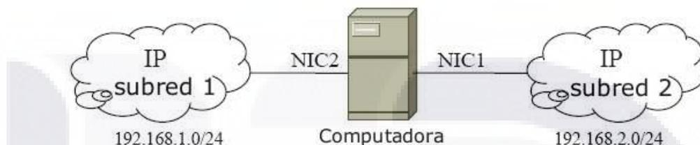
Figura 8: Computadora configurada para encaminador IP. (Adaptado de James and Yu 2004).
