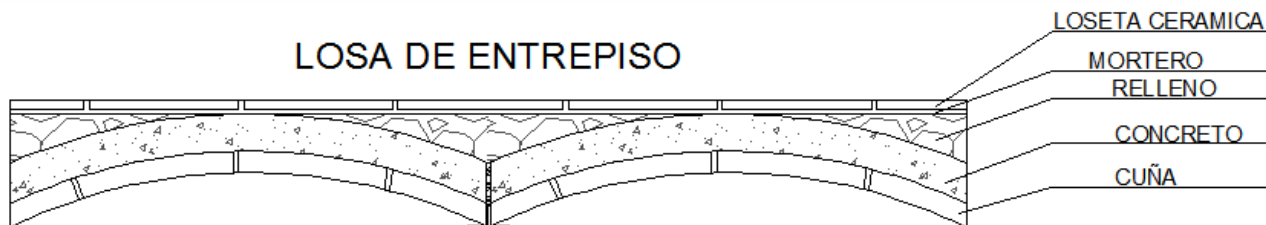
Figura 58.- Detalle de Losa de Entrepiso
