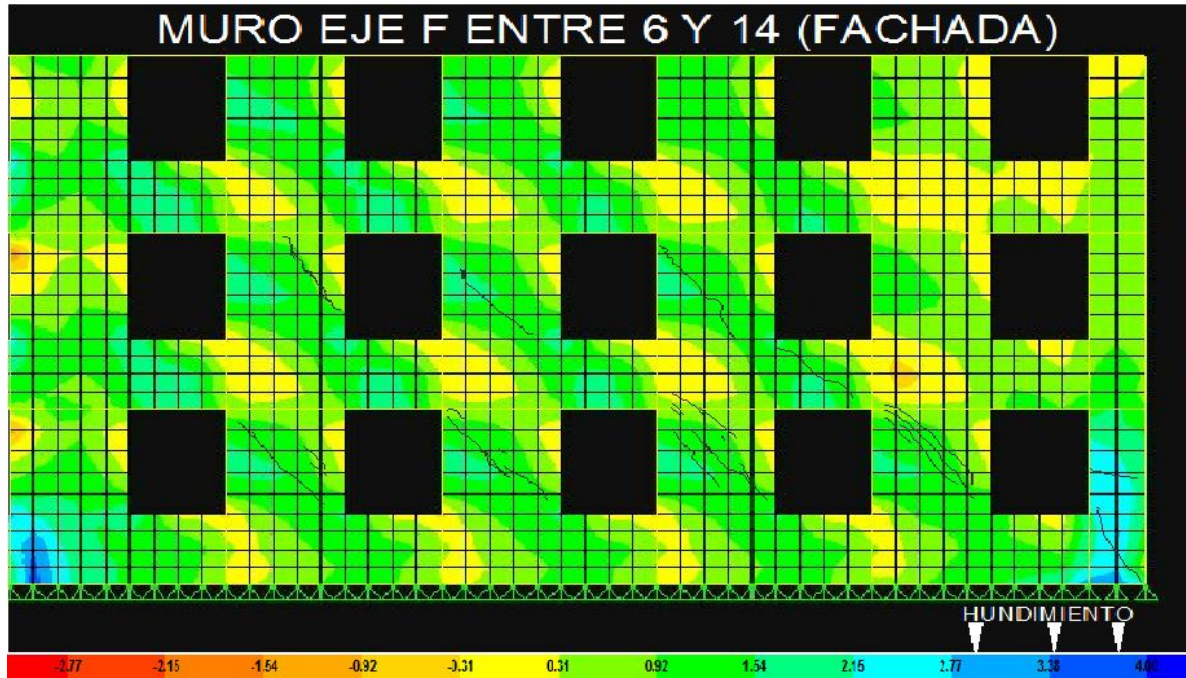
Figura 84.- Superposición de Agrietamientos con Respecto a los Esfuerzos Máximos para el Muro del Eje F
