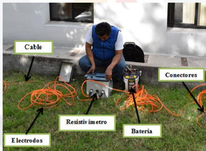
Figura 19.- Equipo de Campo para Adquisición de Datos de Resistividad
