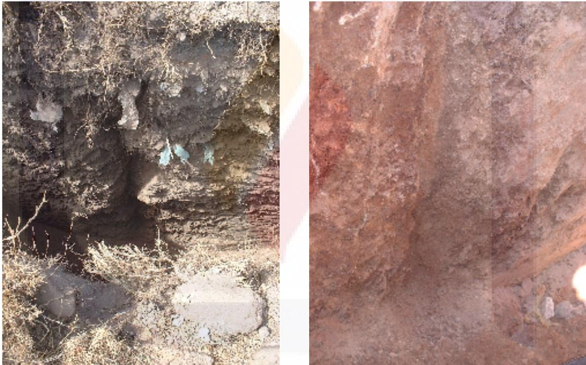
Figura 3.4. Vista de la falla en zona de relleno superficial (izquierda) y vista del cambio de materiales en la estratigrafía de la zona de falla (derecha). En toda la sección excavada el buzamiento observado es prácticamente de 90° (vertical).
