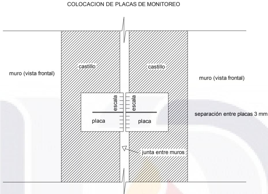
Figura 4.6. Colocación de placas metálicas de 8 x 8 cm x 1/4" de espesor, ancladas a castillos en junta tipo entre muros. Las placas estarán ranuradas y con escala para medición de desplazamientos verticales. La separación entre placas será de 2 mm.
