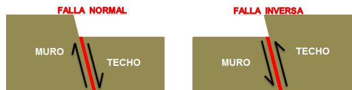
Figura 8. Identificación de los bloques de techo y muro, tomando como referencia el buzamiento de la falla y el tipo de falla según su desplazamiento vertical.
