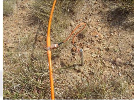
**Figura 45. Electrodo conectado al tendido del cableado.**
