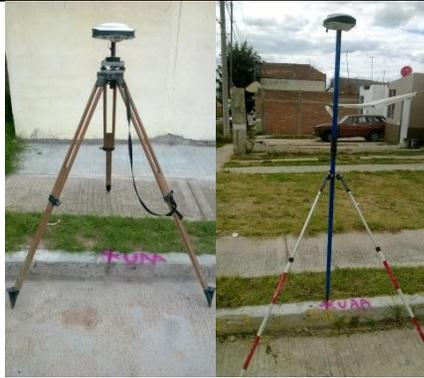
Figura 22. Toma de puntos de control con equipo GPS de doble frecuencia Mca. ASTECH, modelo PROMARK-500.
