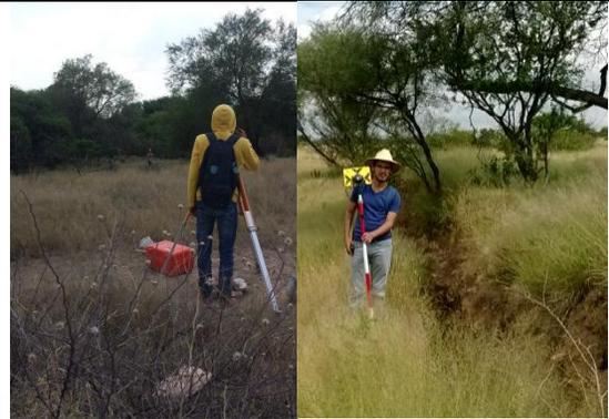
Figura 23. Levantamiento topográfico con estación total Mca. Sokkia modelo 630-RK
