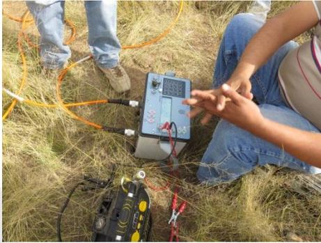
**Figura 44. Resistivímetro IRIS-SYSCAL conectado a una fuente de corriente continua y al tendido de cables.**
