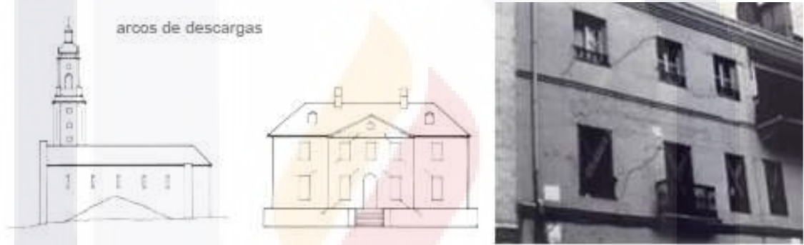
Figura 2.14. Agrietamiento en arco
