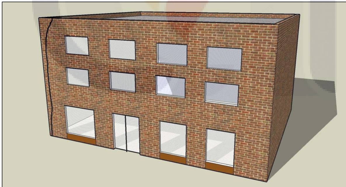
Figura 2.15 Fisura cercana a la arista del edificio de mampostería provocada por giro en la cimentación y/o empuje de las losas de piso. Adaptado de Genescà et al., 1997.
