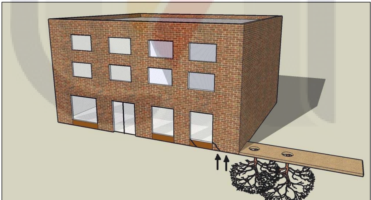
Figura 2.13 Fisuras provocadas por efecto de la proximidad de árboles talados cercanos al edificio de mampostería. Adaptado de Genescà et al., 1997.
