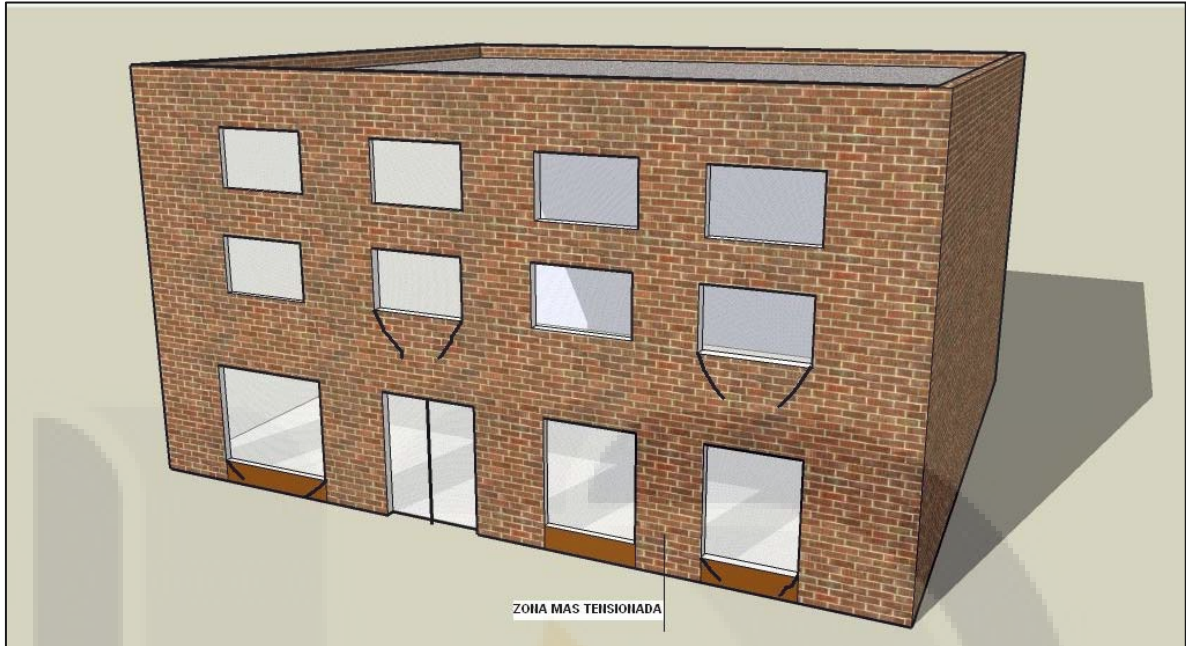
Figura 2.18 La compresibilidad del terreno en las zonas de mayor solicitaciones provoca esfuerzo cortante respecto a las zonas menos cargadas, generando grietas inclinadas en los pisos mas bajos. Adaptado de Genescà et al., 1997.
