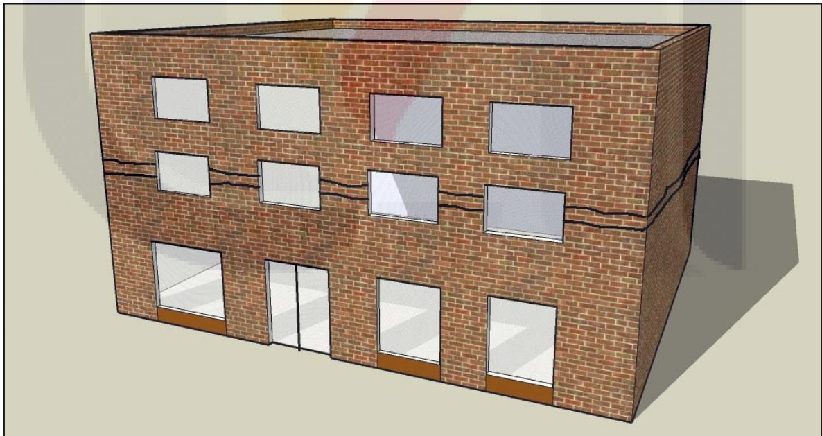
Figura 2.19 Fisuras generadas entre los pisos por efecto de un giro en el empotramiento del muro y la losa del piso superior. Adaptado de Genescà et al., 1997.
