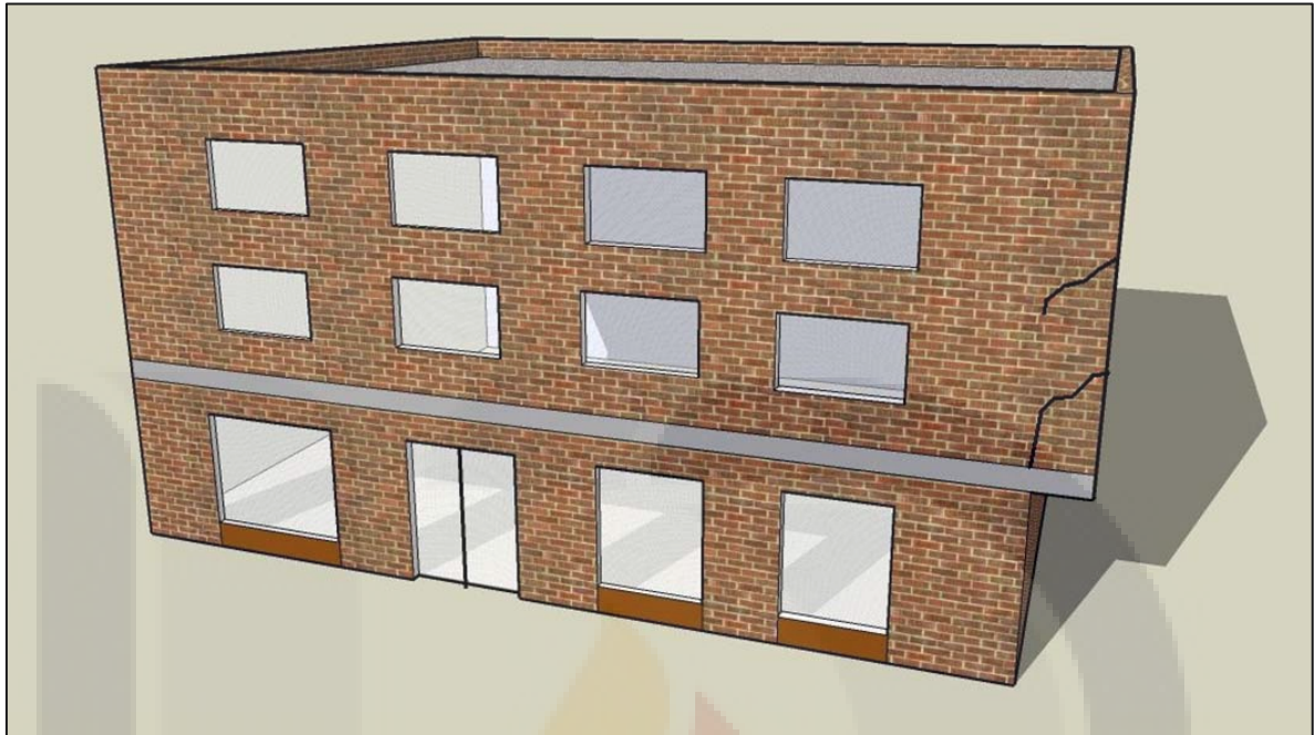
Figura 2.21 Grietas provocadas por el esfuerzo cortante que provoca la flexión del voladizo en la pared de mampostería. Adaptado de Genescà et al., 1997.
