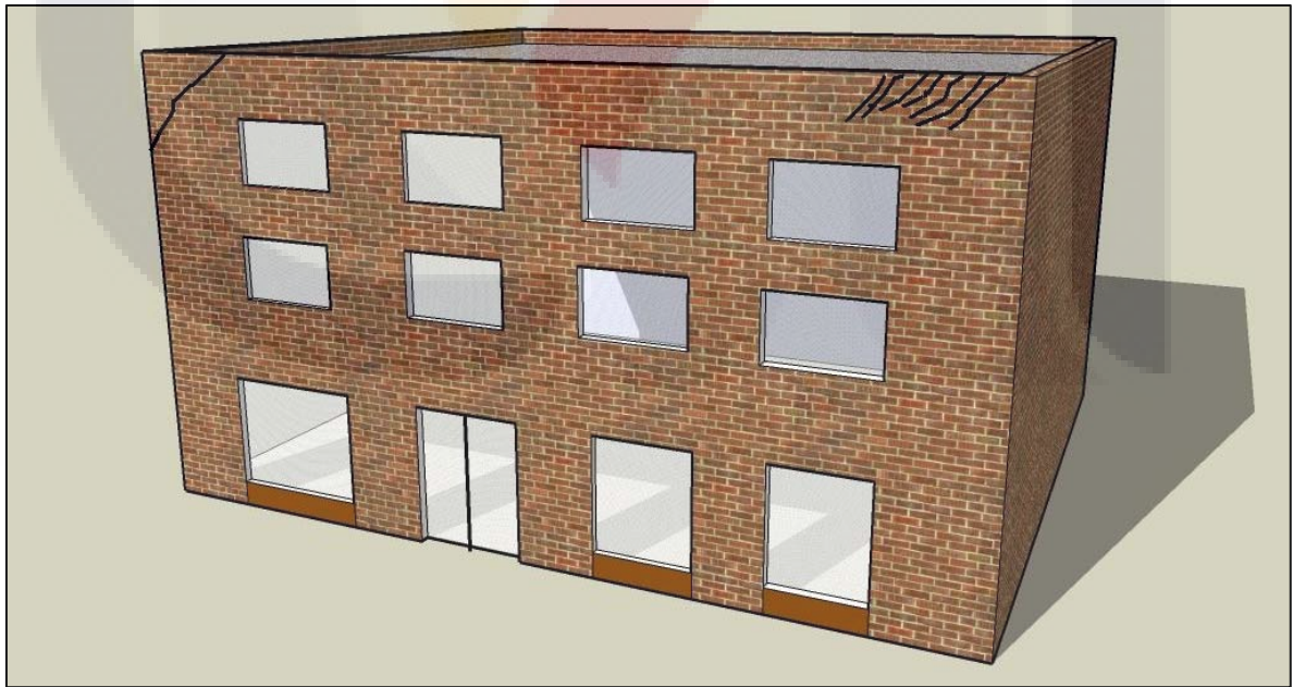
Figura 2.22 Fisuras en el extremo superior de la pared del edificio de mampostería, provocadas por algún impedimento al libre movimiento de la cubierta ocasionado por variaciones térmicas. Adaptado de Genescà et al., 1997.
