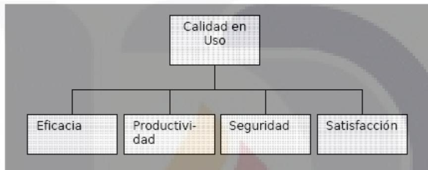
**Fig. 9 Modelo para calidad en uso. ISO IEC 9126-1 (2001)**
