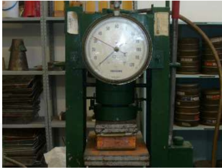
Figura 3.5 Realización de ensaye a compresión en maquina de prueba con capacidad de carga de 120 toneladas (laboratorio de la Universidad Autónoma de Aguascalientes).
