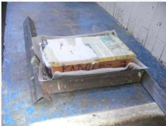
Figura 3.4 Cabeceo con azufre de las piezas de tabique de barro recocido (laboratorio de la Universidad Autónoma de Aguascalientes).
