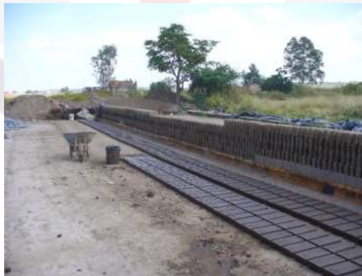
Figura 3.2 Secado al sol de piezas de barro (Los Arellano, Aguascalientes).
