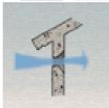
Fig.30.- Ventilación unilateral en la vivienda
