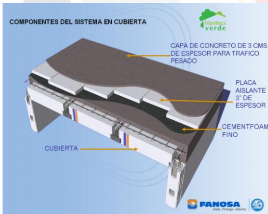
Fig. 69.16.- Placas de poliestireno expandido, no flamables, como recubrimiento en muros de fachadas o losas, que proporcionan aislamiento térmico excelente de las inclemencias de la temperatura. Es un producto certificado por la CONAE, INFONAVIT, etc. Para viviendas ecológicas.
