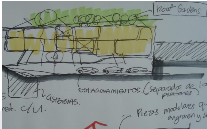
Figura 43.6.- Propuesta 1 Se pretende que el edificio elevado a su vez se componga por viviendas no de un solo nivel sino de 2 o más niveles. El área destinada al automóvil debe subelevarse a lo peatonal, por lo que los estacionamientos y guardados se deberán ocultar y se mandan a un desnivel de la calle debajo de las áreas públicas y verdes.
