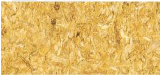
Fig. 69.5.-Aglomerado de maderas recicladas para usarse en la fabricación de muebles sustitutos de madera como closets, repisas, alacenas, etc.
