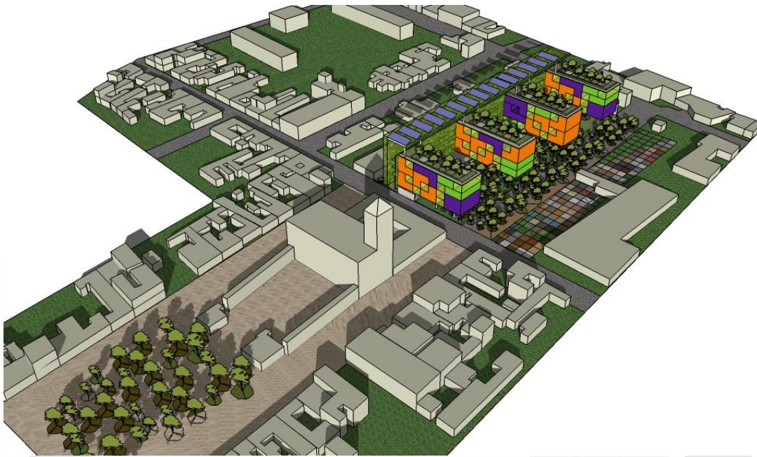
Fig. 47.1.- Propuesta 3 En donde el edificio se compone por 4 módulos de viviendas separadas por un espacio libre suficiente para su asoleamiento, y en donde todas las viviendas tienen la orientación norte sur, para obtener las mejores condiciones climáticas. Se sigue conservando los huecos verdes en el modulo de viviendas a manera de patios. Se plantean 3 módulos diferentes de vivienda.
