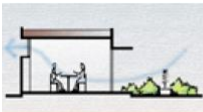
Fig.31.- Ventilación cruzada en la vivienda
