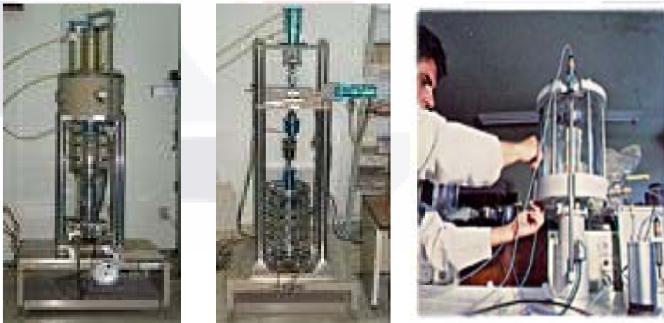
Fig. 3.3 Ensaye de columna resonante
