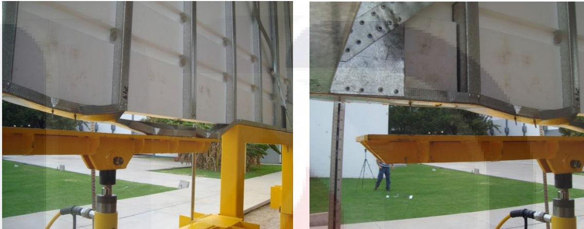
Figura 118.- Falla de sujeción por desgarramiento del track y desprendimiento de tornillos de fijación.
