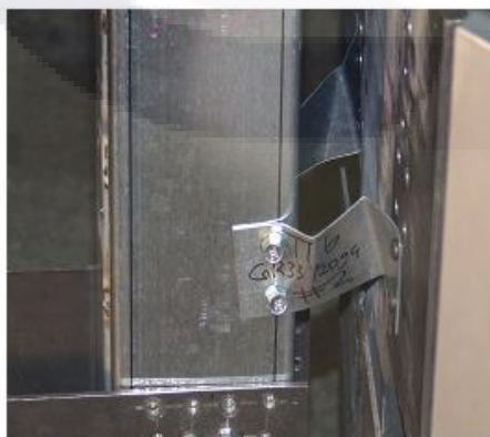
Figura 81.- Modo de falla a cortante de clip T1b y gráfica carga-desplazamiento
