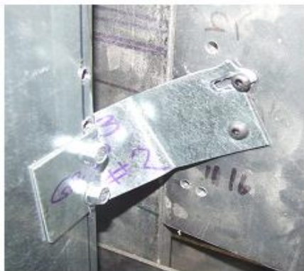
Figura 79.- Modo de falla a cortante de clip T3 y grafica carga-desplazamiento
