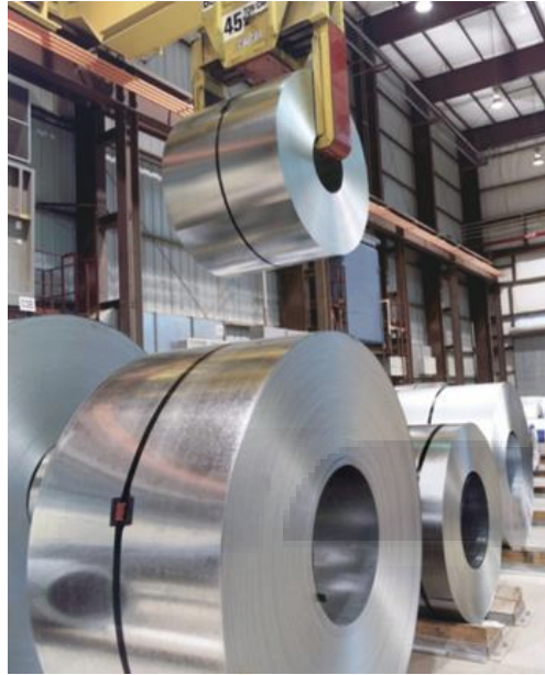
Figura 8.- Bobinas de acero laminado después del proceso de galvanizado. (Ussteel, 2014)
