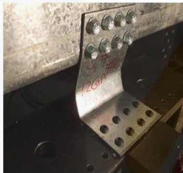
Figura 77.- Modo de falla de clip S7 y su correspondiente curva carga-desplazamiento.
