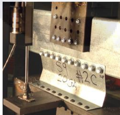
Figura 78.- Modo de falla de clip S9 y su correspondiente curva carga-desplazamiento.
