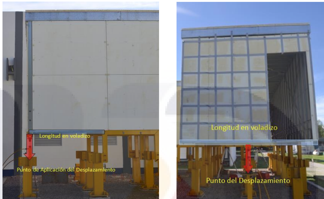
Figura 121.- Izquierda: Vista lateral del punto de aplicación de los desplazamientos. Derecha: Vista frontal del punto de aplicación de desplazamientos
