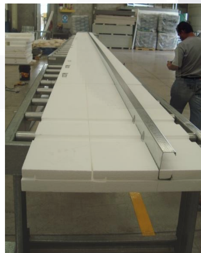
Figura 102.- Detalles de corte y ensamblado del poliestireno expandido.
