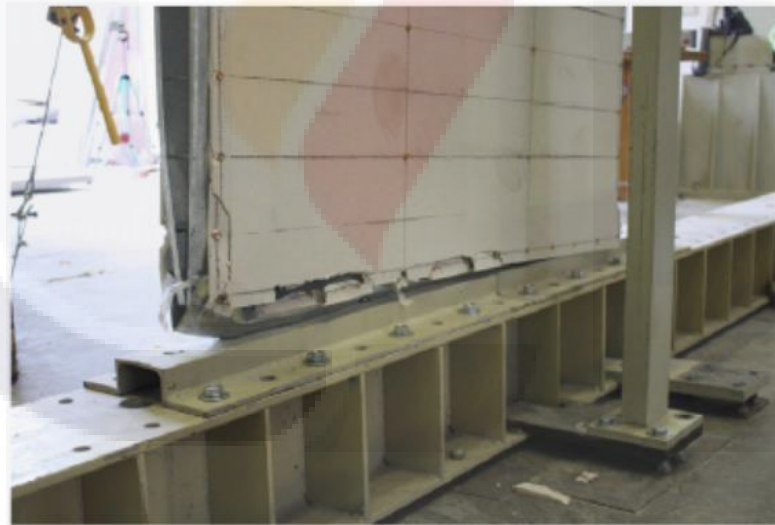
Figura 39.- Falla en track inferior del marco en la prueba experimental (Pan, 2011)
