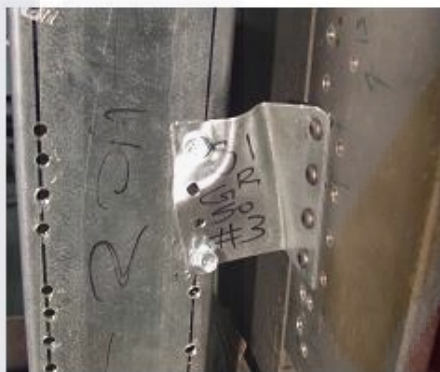
Figura 80.- Modo de falla a cortante de clip S1 y grafica carga-desplazamiento
