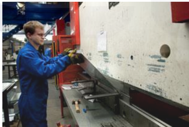
Figura 10.- Proceso de conformado en frío por medio de prensa dobladora (Perry Biomass, 2014)
