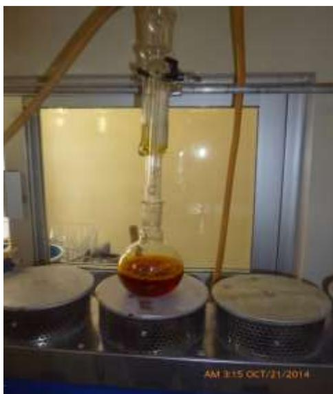
Figura 17. Filtro ubicado dentro del Soxhlet.
