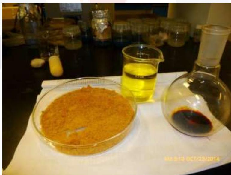
Figura 18. Los tres productos obtenidos en el sistema Soxhlet.
