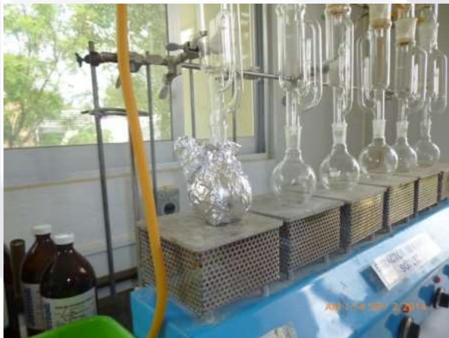
Figura 16. Equipo Soxhlet utilizado para la extracción de la oleorresina no saponificada.
