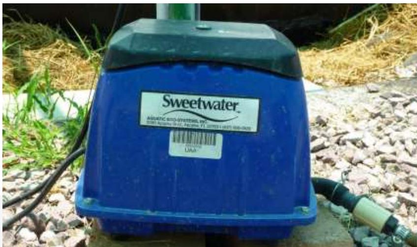
Figura 10. Aireación del sistema semi-cerrado de recirculación.
