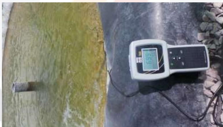
Figura 12. Oxímetro YSI modelo 550A.
