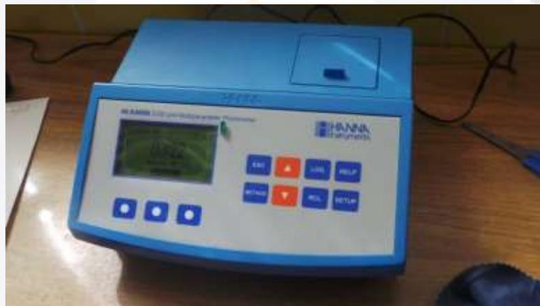
Figura 14. Equipo multiparámetros fotométrico para acuicultura.
