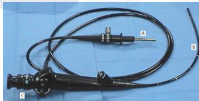
Ilustración 17. Partes de fibrosocopio. A. Cordón para la conexión a la fuente de luz. B. Cordón de inserción al paciente (Fibra óptica) C. Cuerpo del instrumento. En él se encuentran el control de la punta del aparato (flexión o extensión) el orificio
