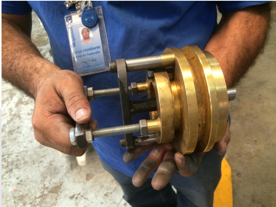
Figura 43. Fotografía que muestra una pieza de un molde a la que se le aplicó el concepto de pokayoke, a través de la guía lateral, la cual impedía que el molde cerrara si no estaba colocado en posición correcta.
