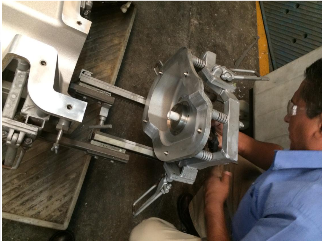
Figura 41. Evidencia de la implementación de guías y mecanismos que facilitan la descarga del molde como los ganchos de presión para los cierres,
