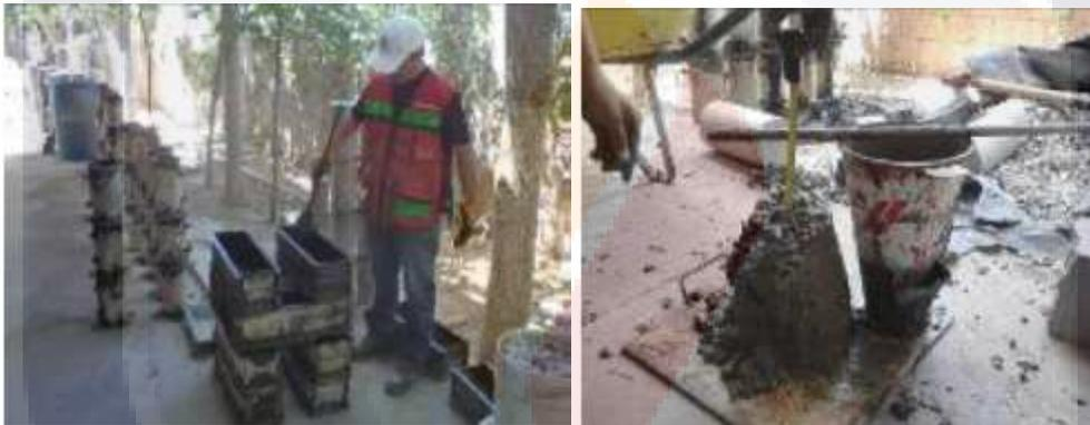
Figura B-1.- a) Imagen de los moldes cilíndricos y rectangulares. b) Imagen del ensayo de revenimiento del concreto (Ortiz, 2012).
