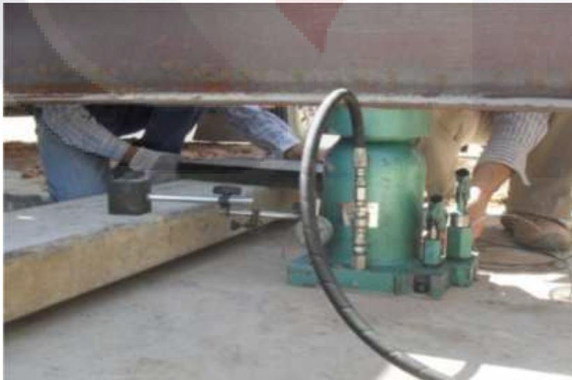
Figura 4.19.-Imagen de las características del equipo empleado para los ensayos en pisos.
