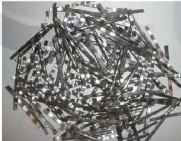
Figura 3.4.- Fibra de acero ondulada (FibraTeh, 2015).
