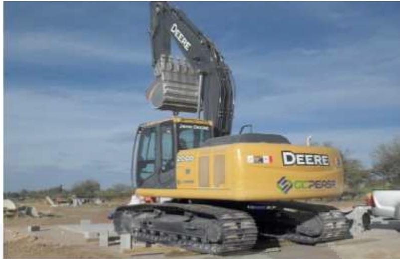
Figura 4.16.- Máquina utilizada para aplicar carga, en el segundo ensayo.
