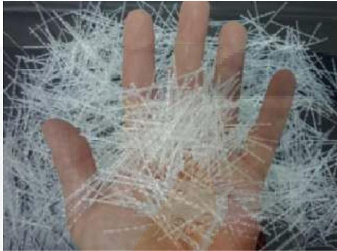
Figura 3.5.- Macro-fibra de polipropileno ondulada (NTH, 2015).
