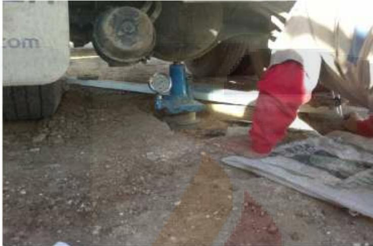
Figura 4.11.-Realización de prueba de placa.
