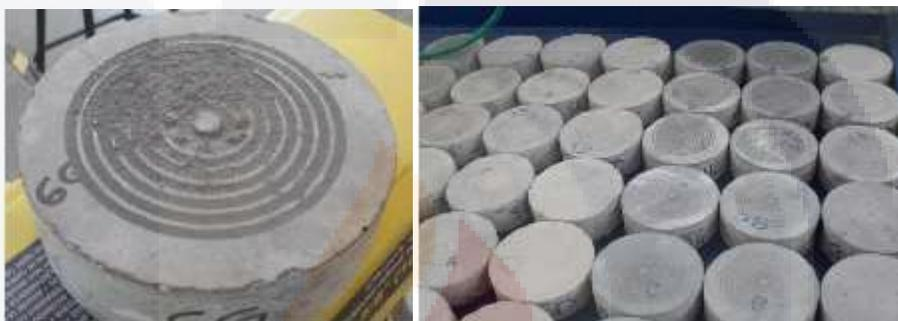
Figuras 6-F y 7-F.-Imagen de los especímenes ensayados a abrasión.
