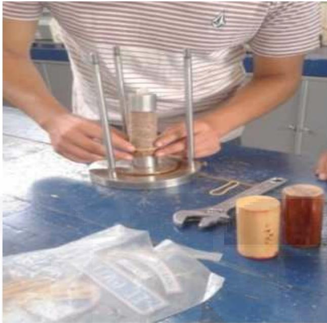
Figura 5.29.- Especímenes elaborados para los ensayos triaxiales.
