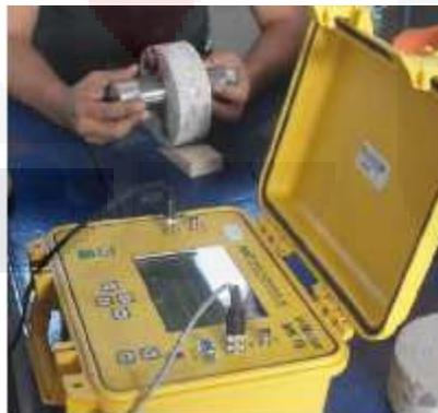
Figura 10-F.- Ensayo de prueba ultrasónica aplicado a las muestras de concreto a 21 días.
