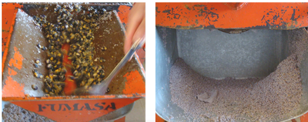
Figura 14. Molienda de granos nixtamalizados en molino de piedra volcánica.
