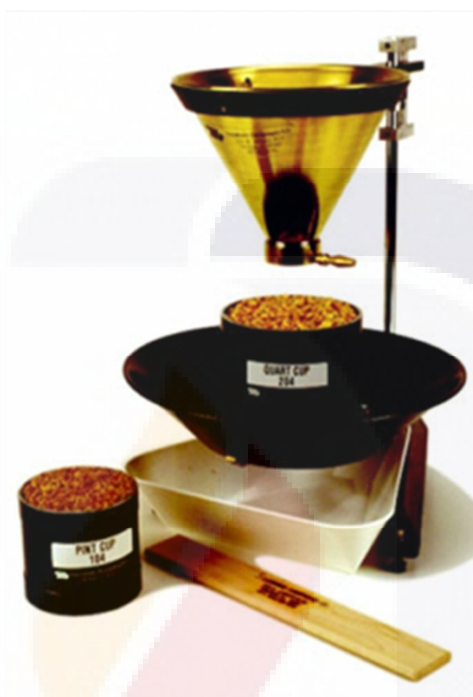
Figura 19. Medición del peso hectolítrico.
