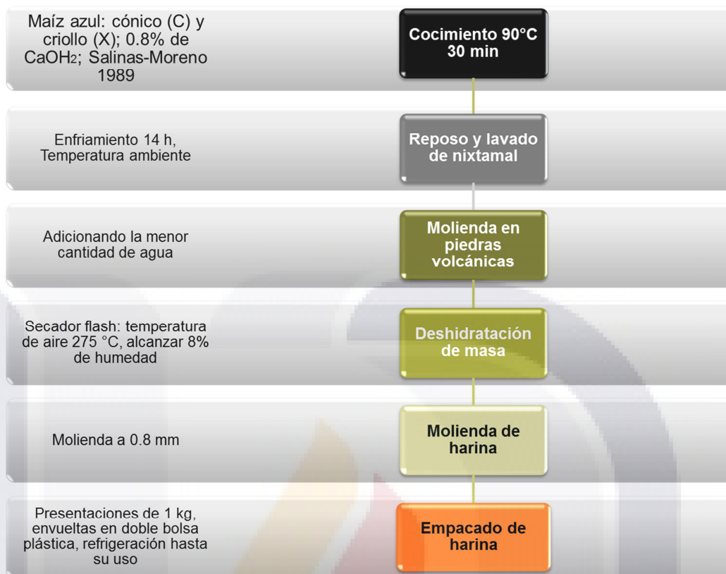
Figura 12. Esquema general de nixtamalización.
