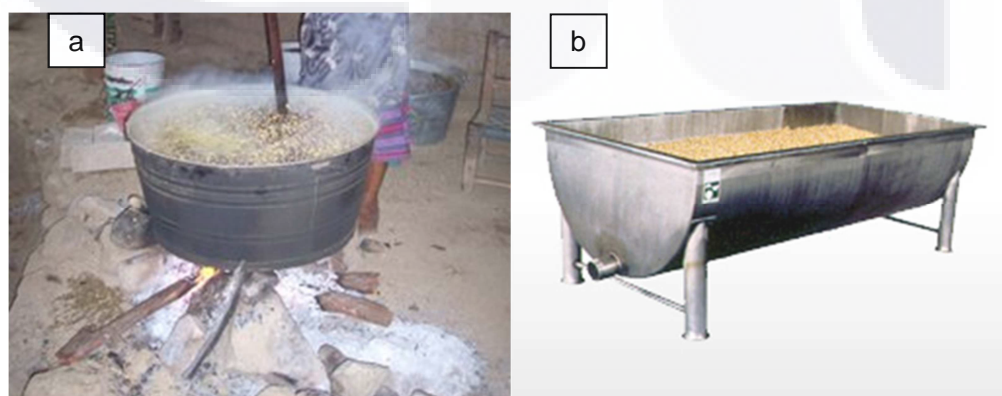
Figura 4. a) Cocimiento artesanal de maíz. b) Paila de acero inoxidable para cocimiento de maíz.
