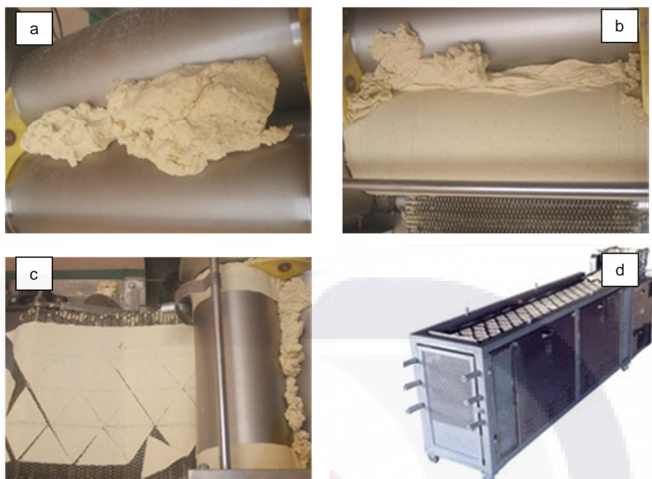
Figura 17. Moldeado, troquelado y precocción de testales de maíz nixtamalizado.
