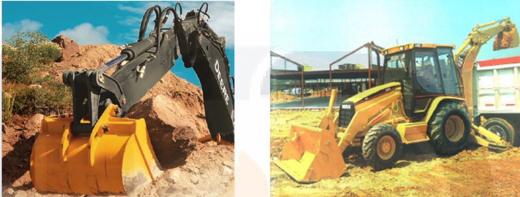
Gráfica no. 8 Bote trasero empleado para excavar.
