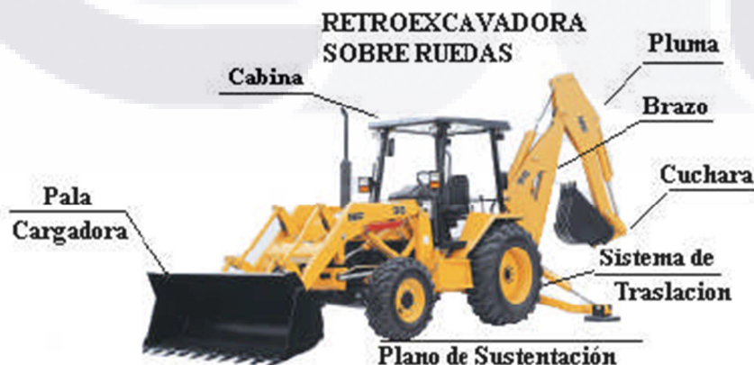
Gráfica no. 4. Partes que integran la retroexcavadora sobre neumáticos
