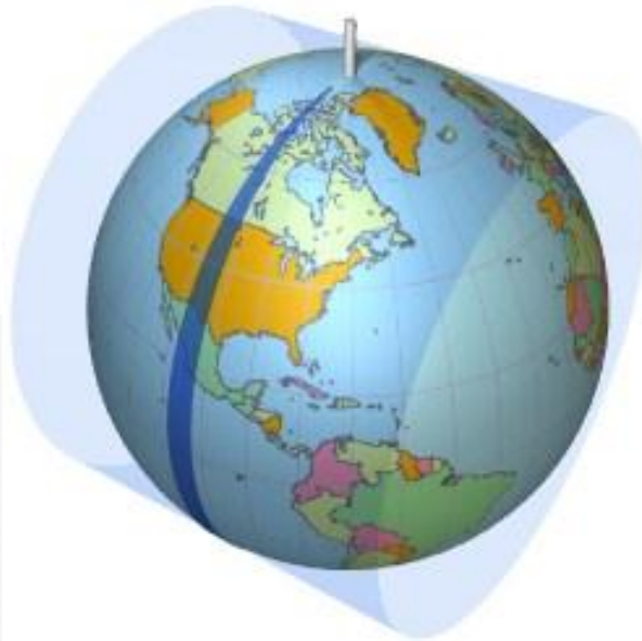
Figura. 11 Proyección UTM. Cilindro Transversal que envuelve a la Tierra y donde se proyecta las Líneas Principales del Globo Terrestre.
