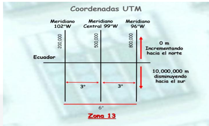
Figura. 18 Dibujo de las dimensiones de una zona u huso con coordenadas UTM.
