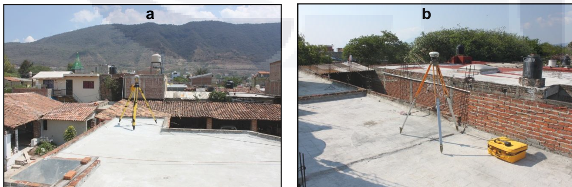
Fig. 5.5 Equipo GPS para monitorización de los desplazamientos: a) base fija y b) base móvil
