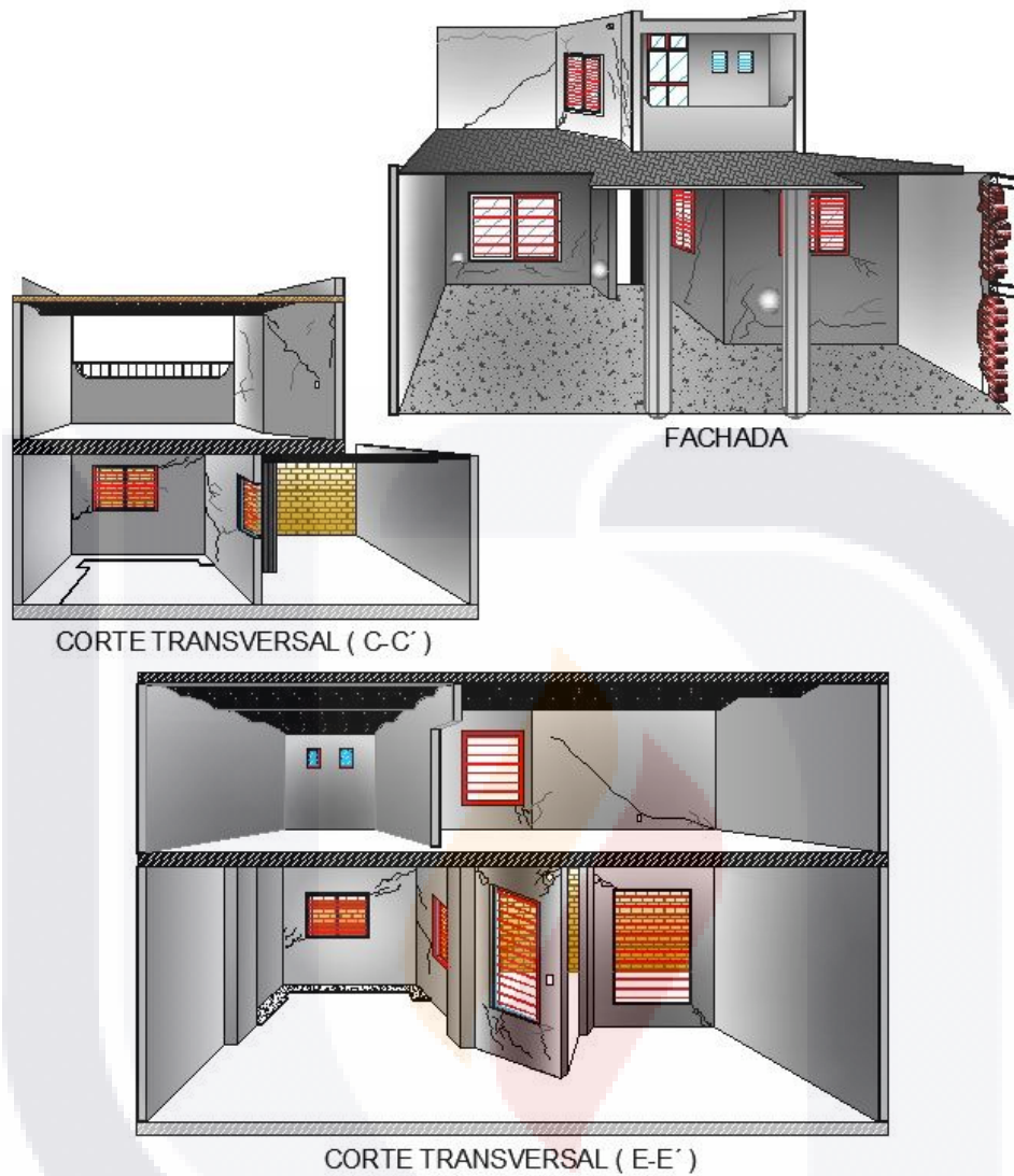
Fig. 4.6 Daños en elementos estructurales de la edificación seleccionada
