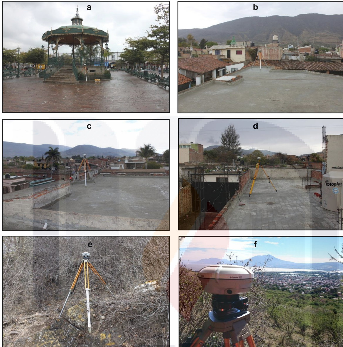
Fig. 5.7 Medición de puntos de control para monitorización de deformaciones: a) Estación E1 (kiosco), b) Estación E2 (casa Juárez), c) Estación E3 (casa Juárez), d) Estación E4 (casa Hidalgo), e) Estación E5 (cerro), f) vista hacia la localidad desde el punto E5
