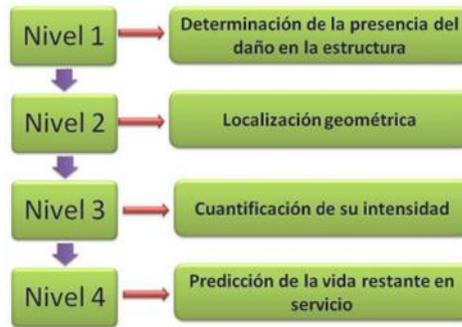
Figura 3.7: Niveles en el proceso de identificación de daño en estructuras.
