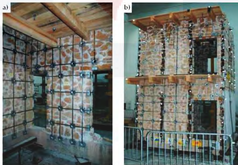
Figura 2 Ejemplo de reforzamiento CAM, en escala 2:3 para pruebas en mesa vibratoria a) Vista interna, b) Vista externa (Ferretti & Pascale, 2019).
