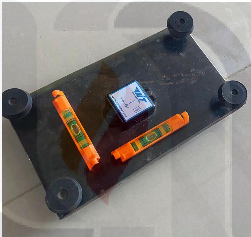
Figura V.2 Instalación y calibración de acelerómetro en losa
