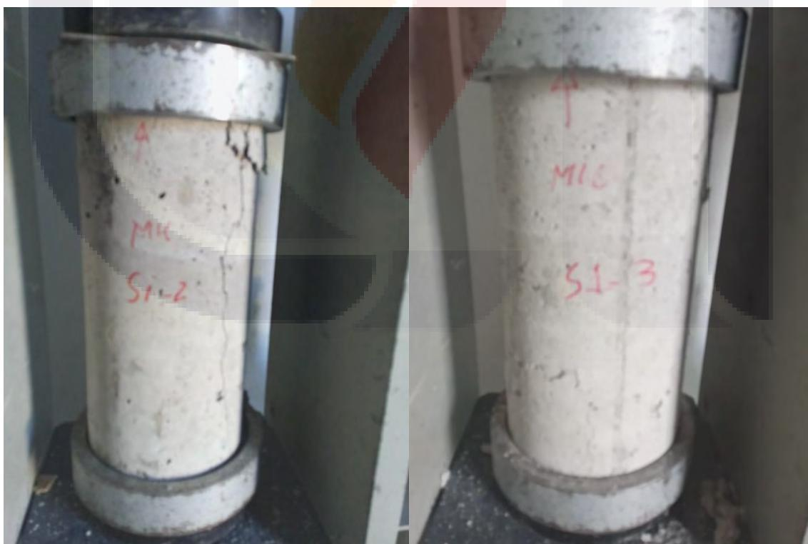
Figura 95. Ensayo a compresión axial de cilindros S1-2 y S1-3
