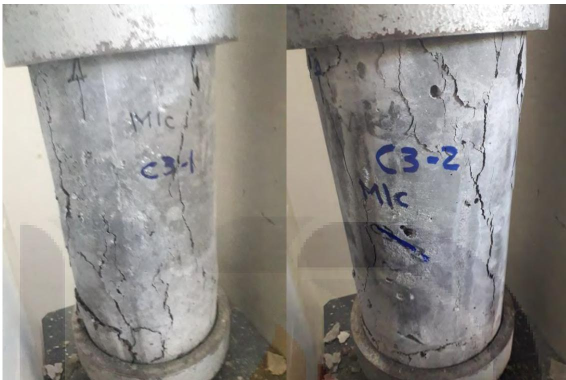
Figura 72. Ensayo a compresión axial de cilindros C3-1 y C3-2
