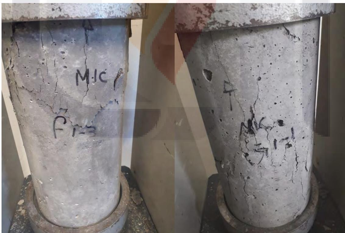
Figura 79. Ensayo a compresión axial de cilindros F1-3 y G1-1
