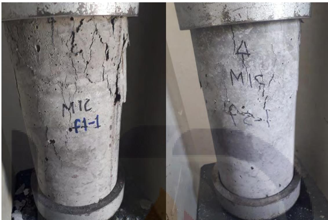
Figura 78. Ensayo a compresión axial de cilindros F1-1 y F2-1
