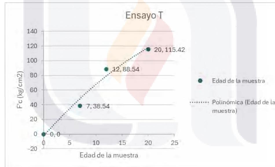
Figura 51. Resultados de ensayo con combinación de parámetros T
