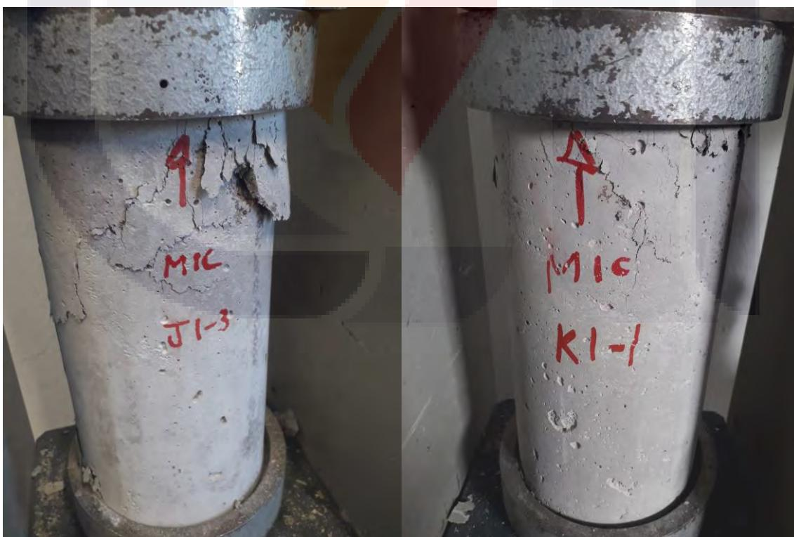
Figura 85. Ensayo a compresión axial de cilindros J1-3 y K1-1
