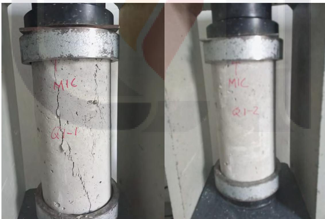
Figura 93. Ensayo a compresión axial de cilindros Q1-1 y Q1-2
