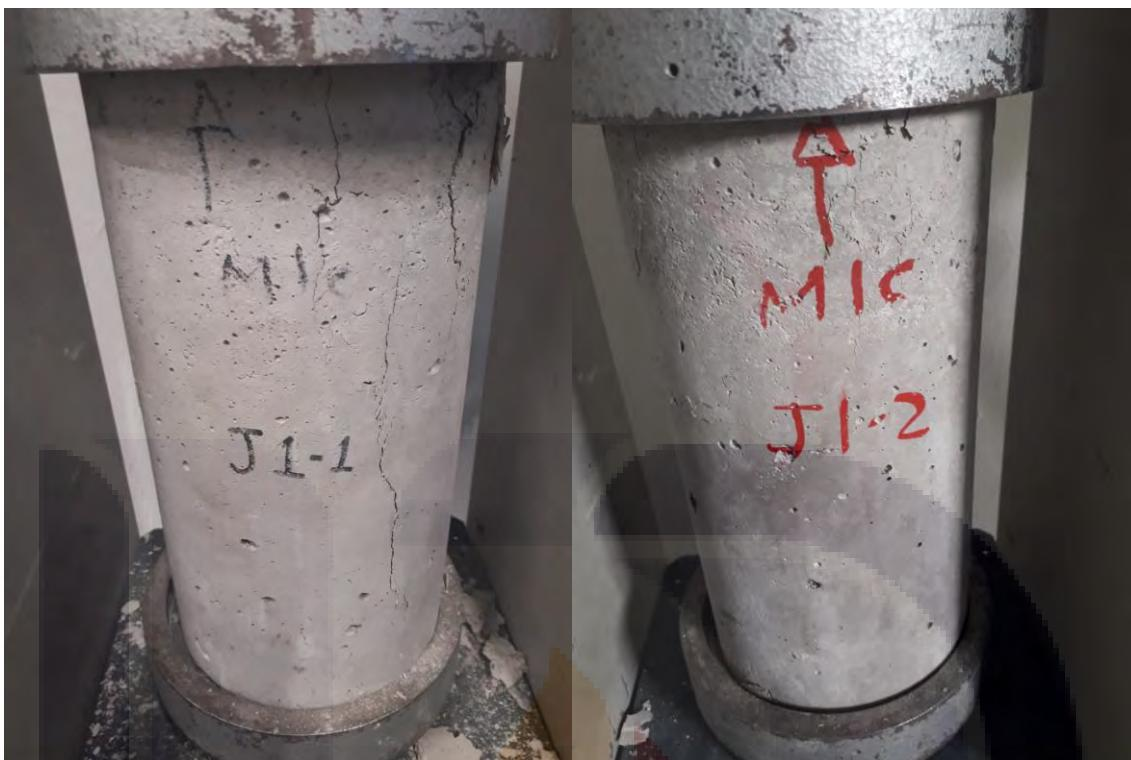
Figura 84. Ensayo a compresión axial de cilindros J1-1 y J1-2
