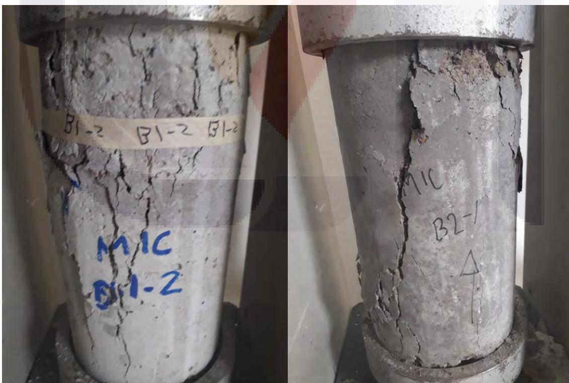
Figura 69. Ensayo a compresión axial de cilindros B1-2 y B2-1
