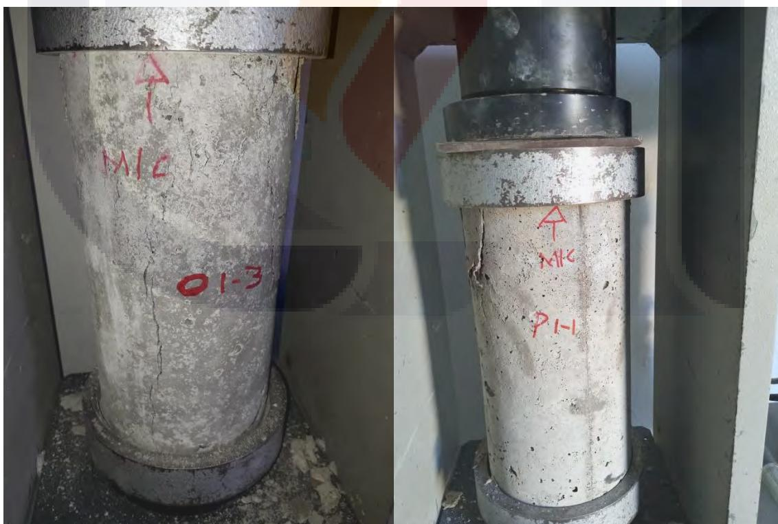
Figura 91. Ensayo a compresión axial de cilindros O1-3 y P1-1
