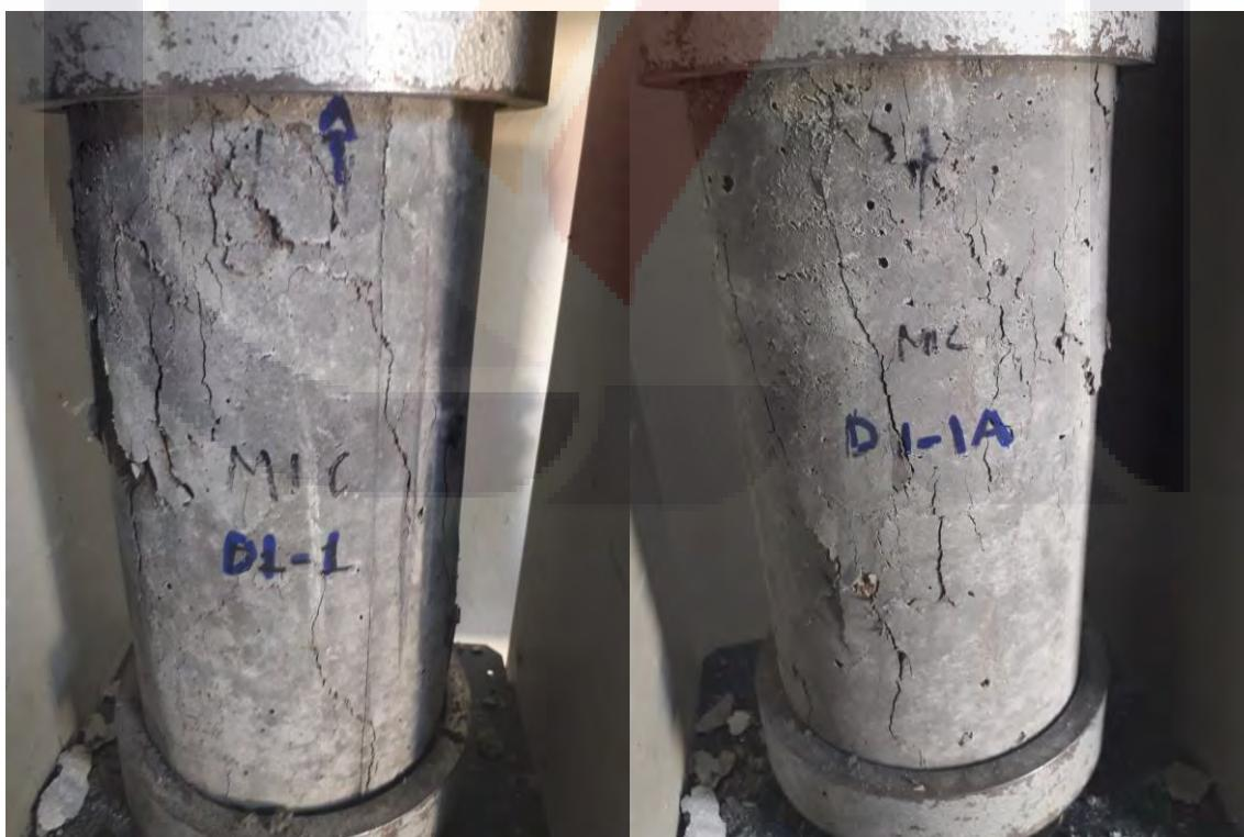
Figura 73. Ensayo a compresión axial de cilindros D1-1 y D1-1<sup>a</sup>
