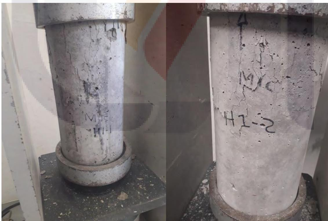
Figura 81. Ensayo a compresión axial de cilindros H1-1 y H1-2
