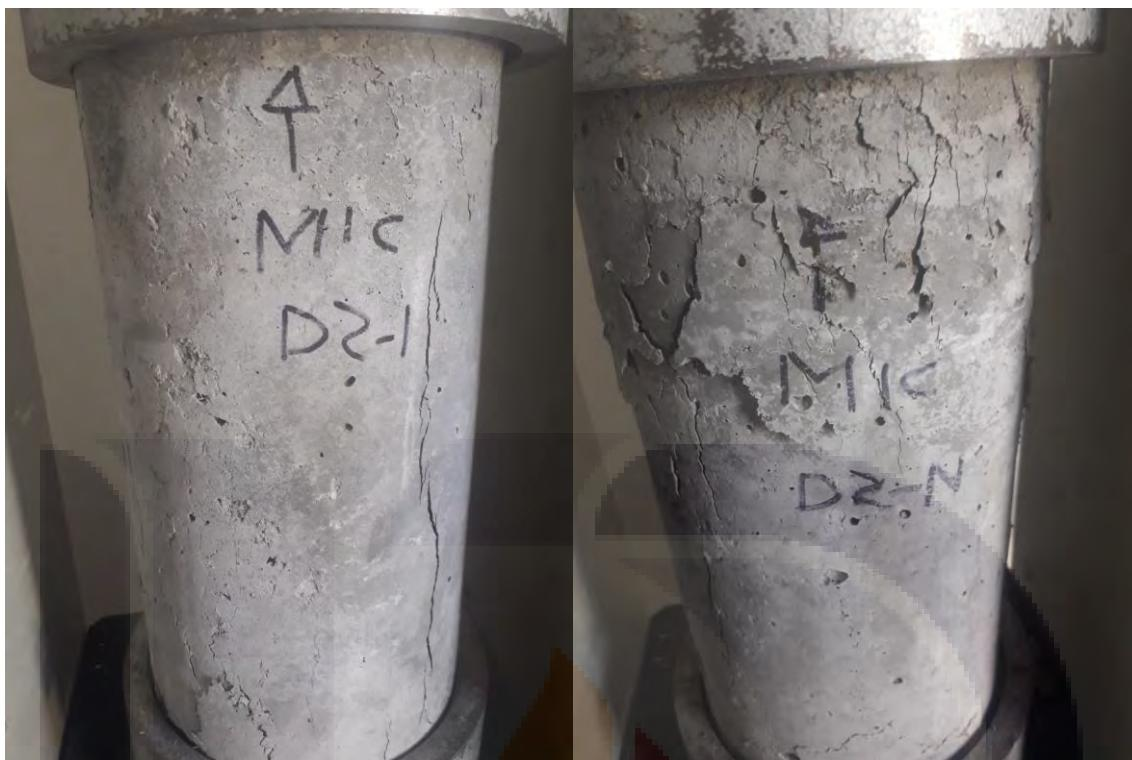
Figura 74. Ensayo a compresión axial de cilindros D2-1 y D2-N
