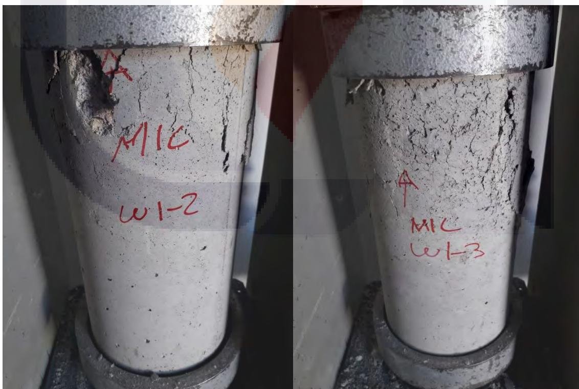
Figura 99. Ensayo a compresión axial de cilindros W1-2 y W1-3
