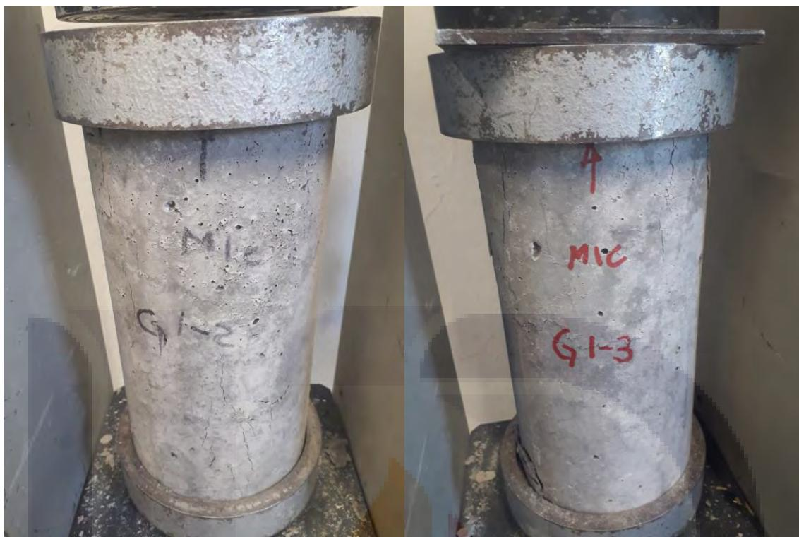
Figura 80. Ensayo a compresión axial de cilindros G1-2 y G1-3
