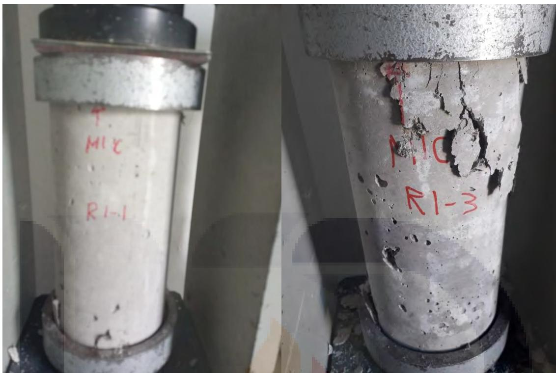
Figura 94. Ensayo a compresión axial de cilindros R1-1 y R1-3
