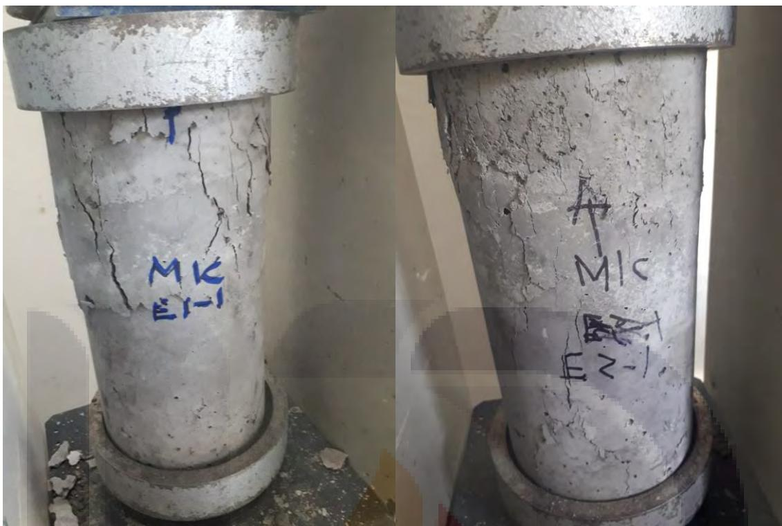
Figura 76. Ensayo a compresión axial de cilindros E1-1 y E2-1
