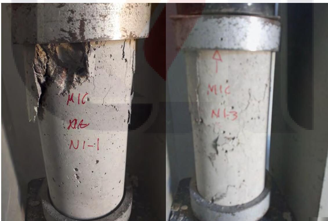
Figura 89. Ensayo a compresión axial de cilindros N1-1 y N1-3
