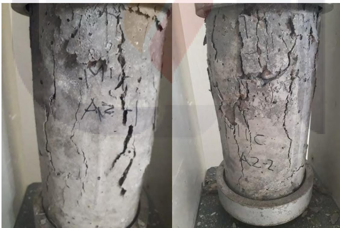
Figura 67. Ensayo a compresión axial de cilindros A2-1 y A2-2
