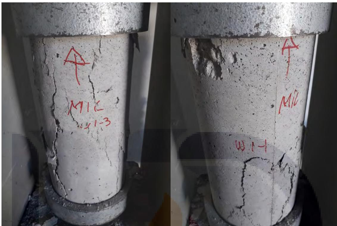
Figura 98. Ensayo a compresión axial de cilindros U1-3 y W1-1
