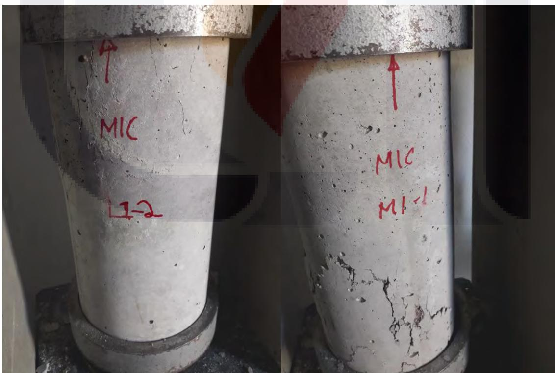
Figura 87. Ensayo a compresión axial de cilindros L1-2 y M1-1
