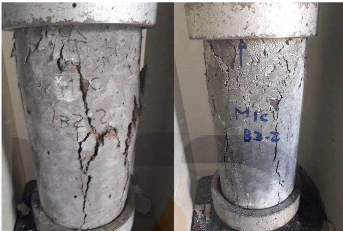
Figura 70. Ensayo a compresión axial de cilindros B2-2 y B3-2
