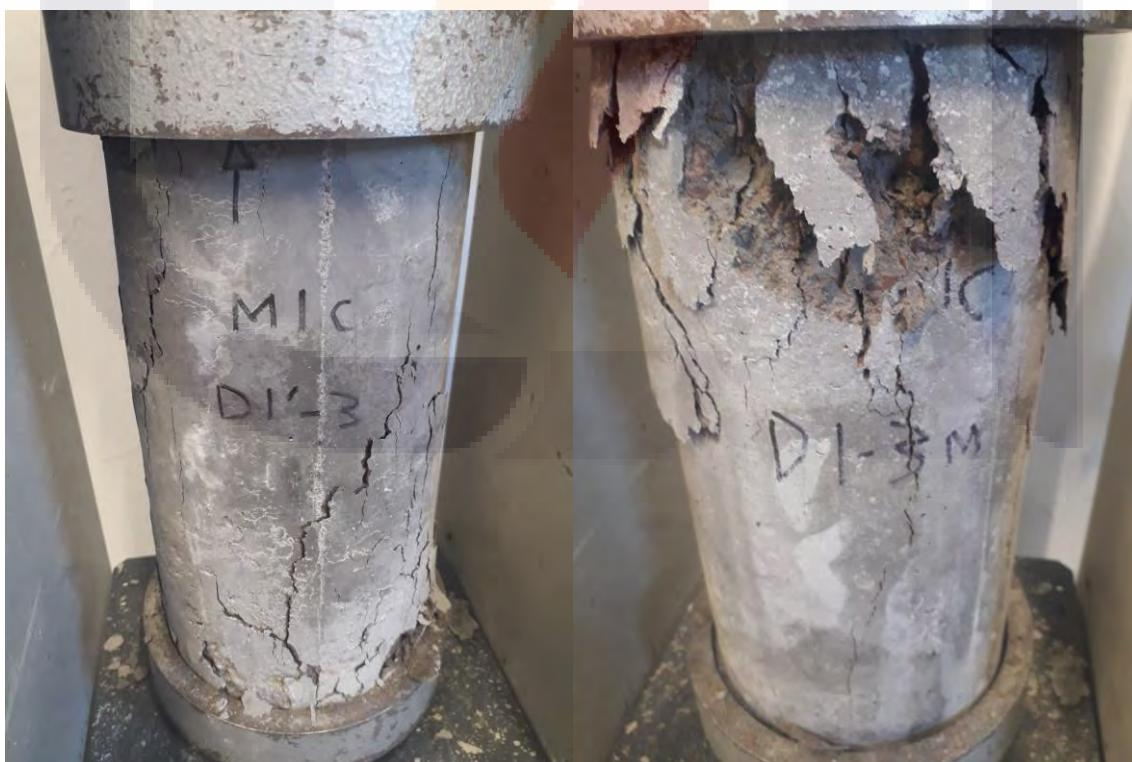
Figura 75. Ensayo a compresión axial de cilindros D1-3 y D1-3M
