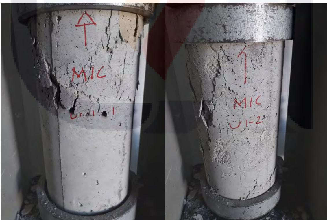
Figura 97. Ensayo a compresión axial de cilindros F1-3 y G1-1
