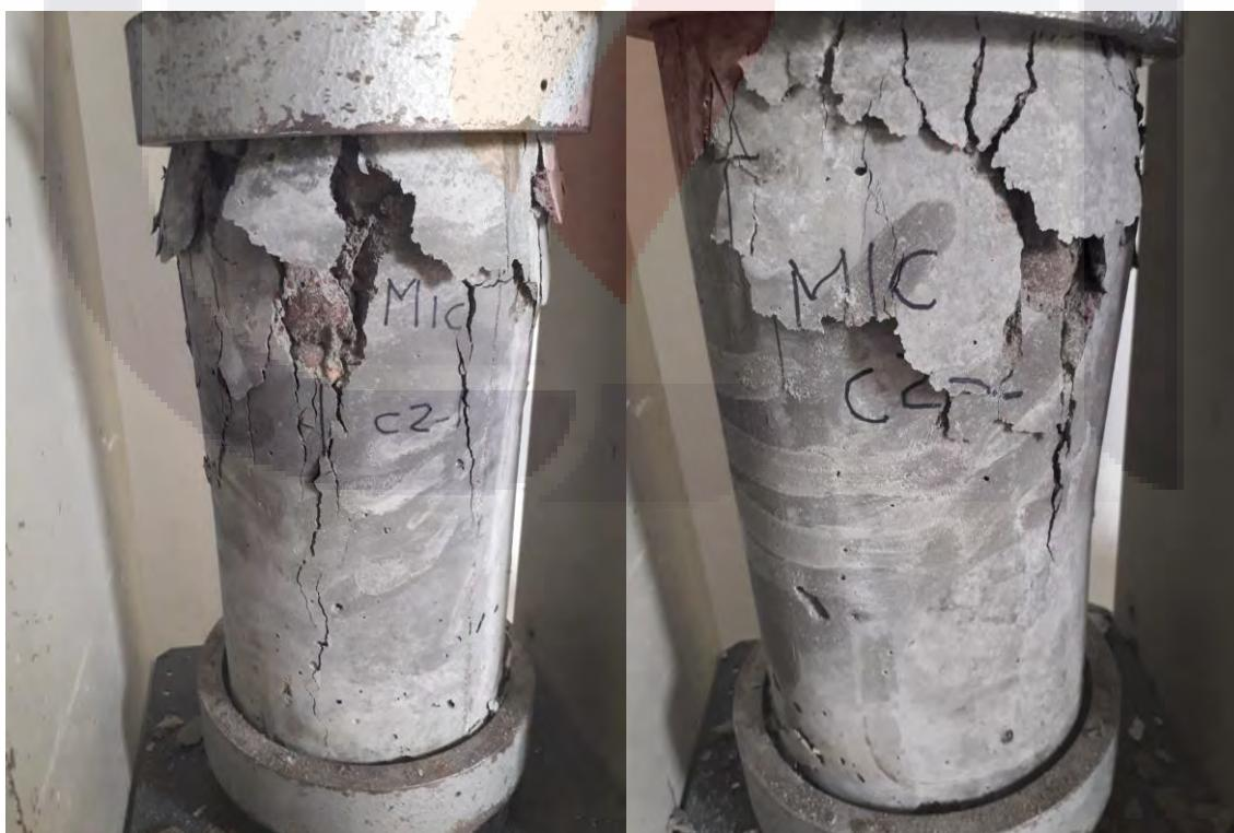
Figura 71. Ensayo a compresión axial de cilindros C2-1 y C2-2
