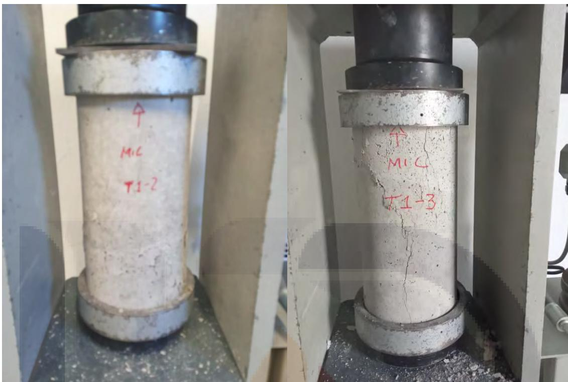
Figura 96. Ensayo a compresión axial de cilindros T1-2 y T1-3
