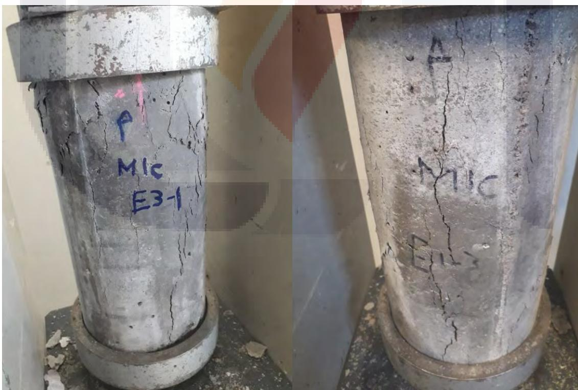
Figura 77. Ensayo a compresión axial de cilindros E3-1 y E1-3
