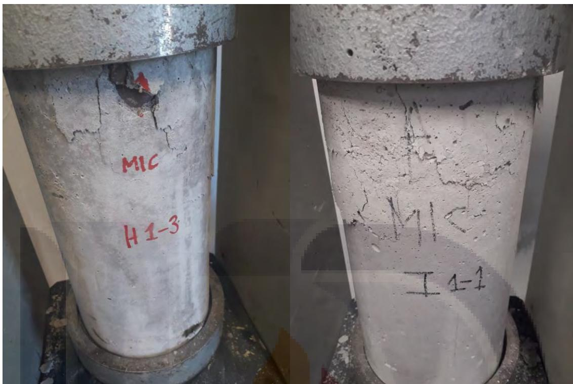
Figura 82. Ensayo a compresión axial de cilindros H1-3 y I1-1
