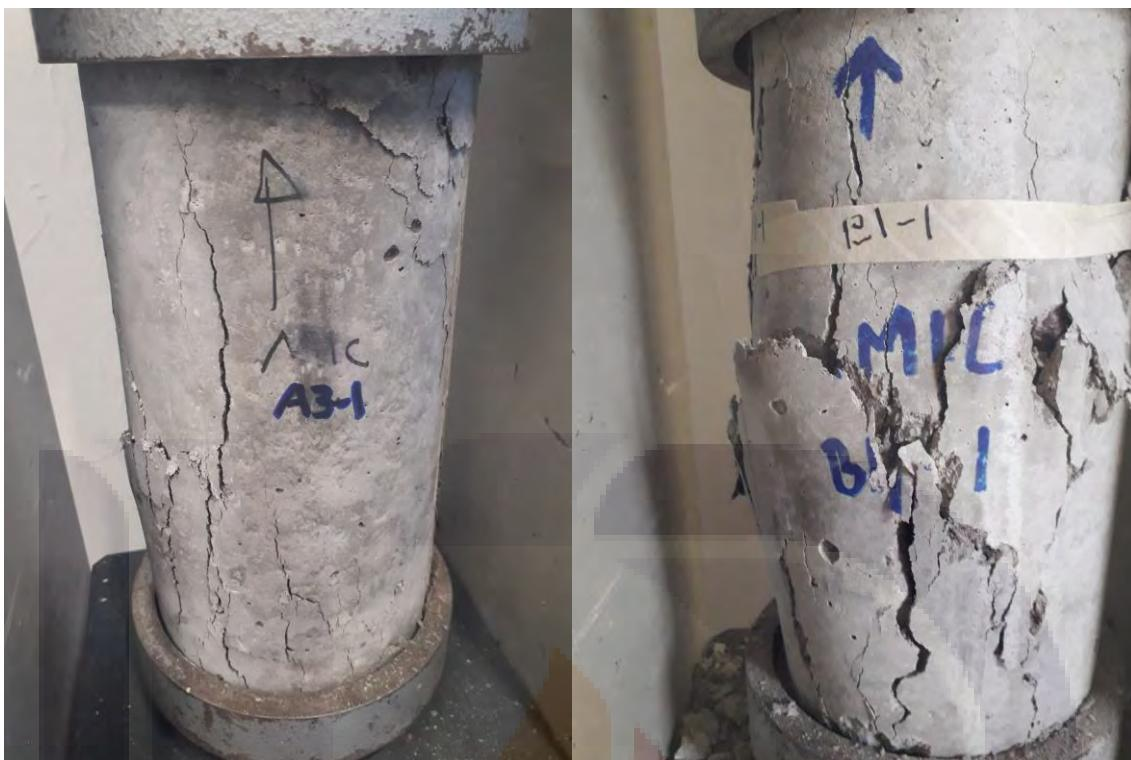
Figura 68. Ensayo a compresión axial de cilindros A3-1 y B1-1
