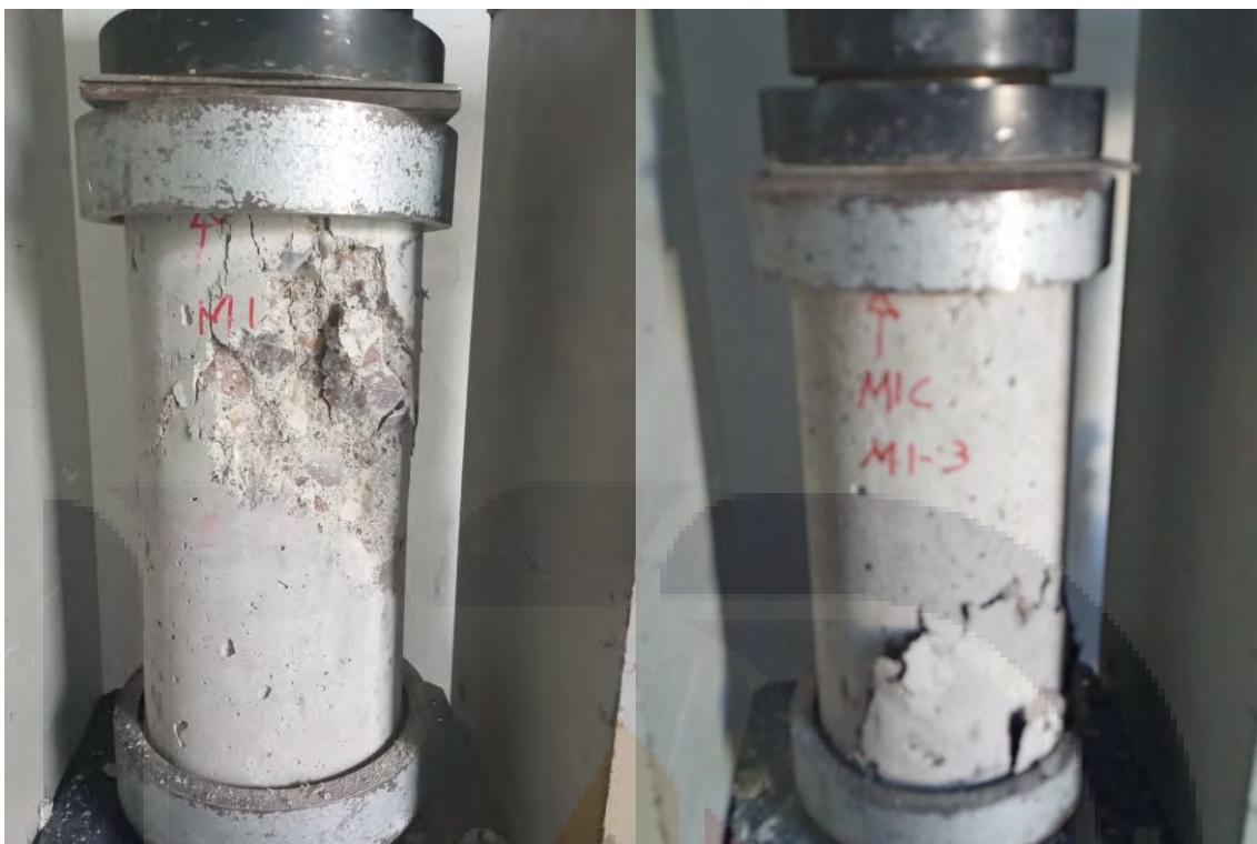
Figura 88. Ensayo a compresión axial de cilindros M1-2 y M1-3
