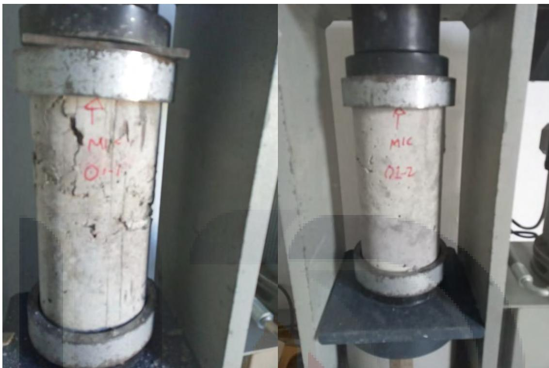
Figura 90. Ensayo a compresión axial de cilindros O1-1 y O1-2
