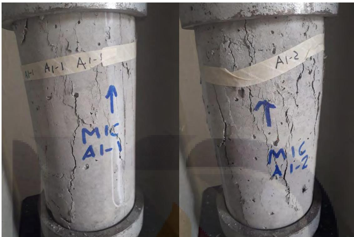
Figura 66. Ensayo a compresión axial de cilindros A1-1 y A1-2
