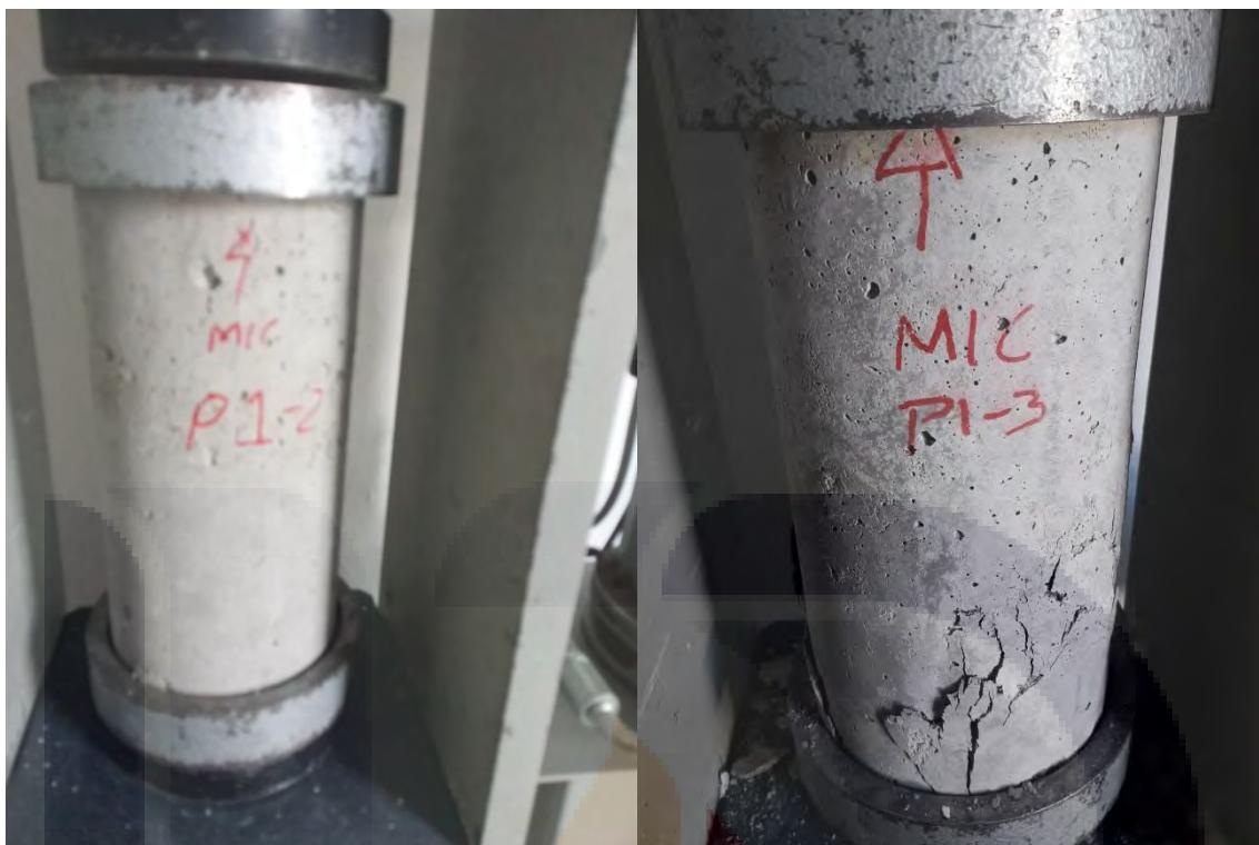
Figura 92. Ensayo a compresión axial de cilindros P1-2 y P1-3
