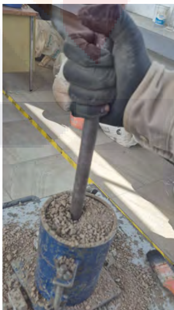
Ilustración 25 Compactación inducida a la tercera capa del ensaye de peso volumétrico seco compacto
