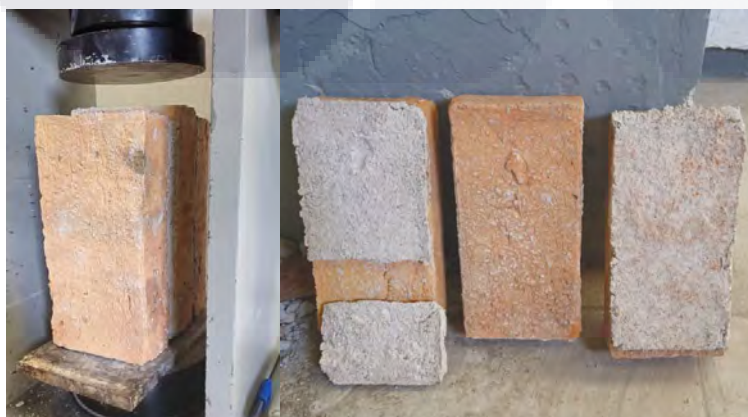
Ilustración 30 (Izquierda) Muestra posicionada en la prensa, (Derecha) Muestra con falla por falta de adherencia
