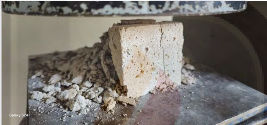
Ilustración 27 Falla del cubo de mortero de cal
