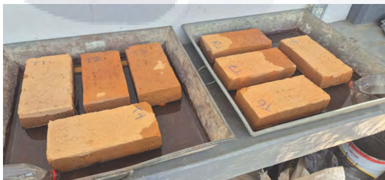
Ilustración 22 (Arriba) diagrama de la colocación de las piezas (Abajo) Absorción inicial de agua de las piezas de tabique rojo
