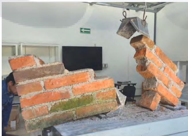
Ilustración 32 Falla del murete de mampostería
