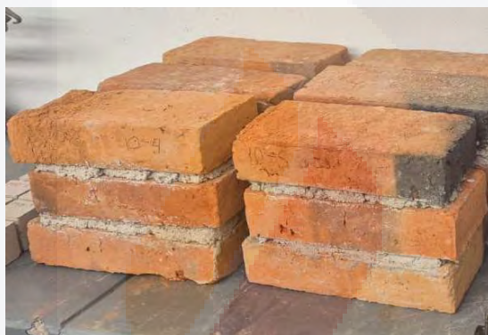
Ilustración 29 Espécimen de ensayo de adherencia por esfuerzo cortante
