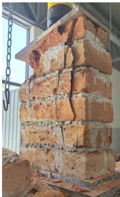
Ilustración 35 Falla de la pila a compresión
