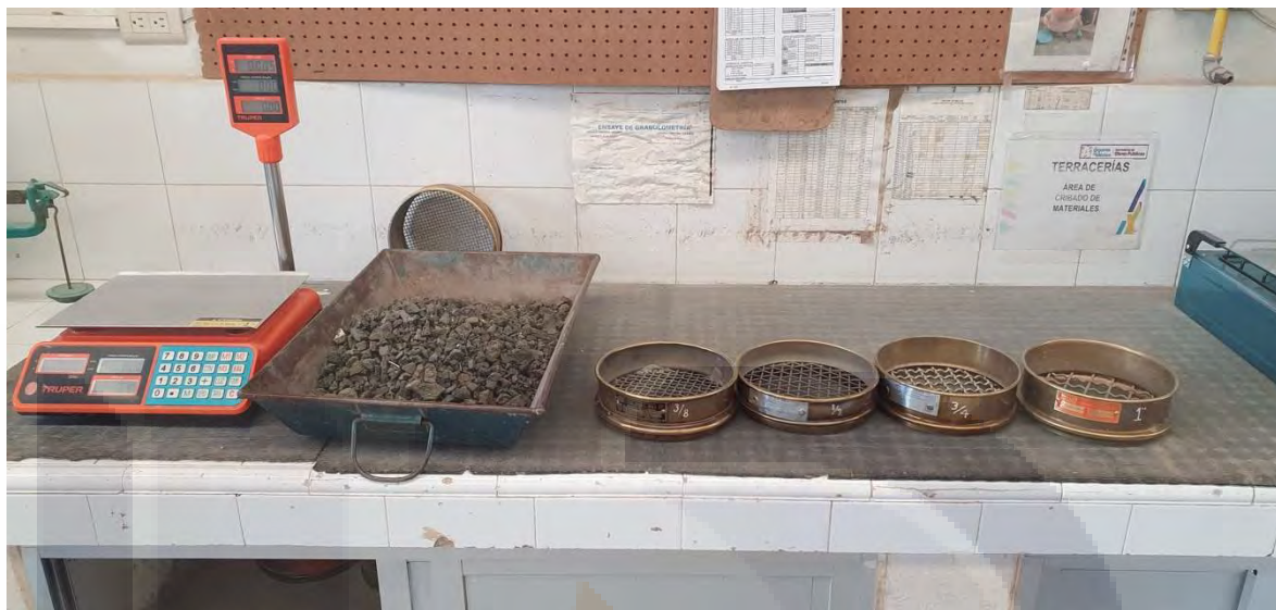
Ilustración 20 Preparación de material para determinación de granulometría del material. Foto del Autor
