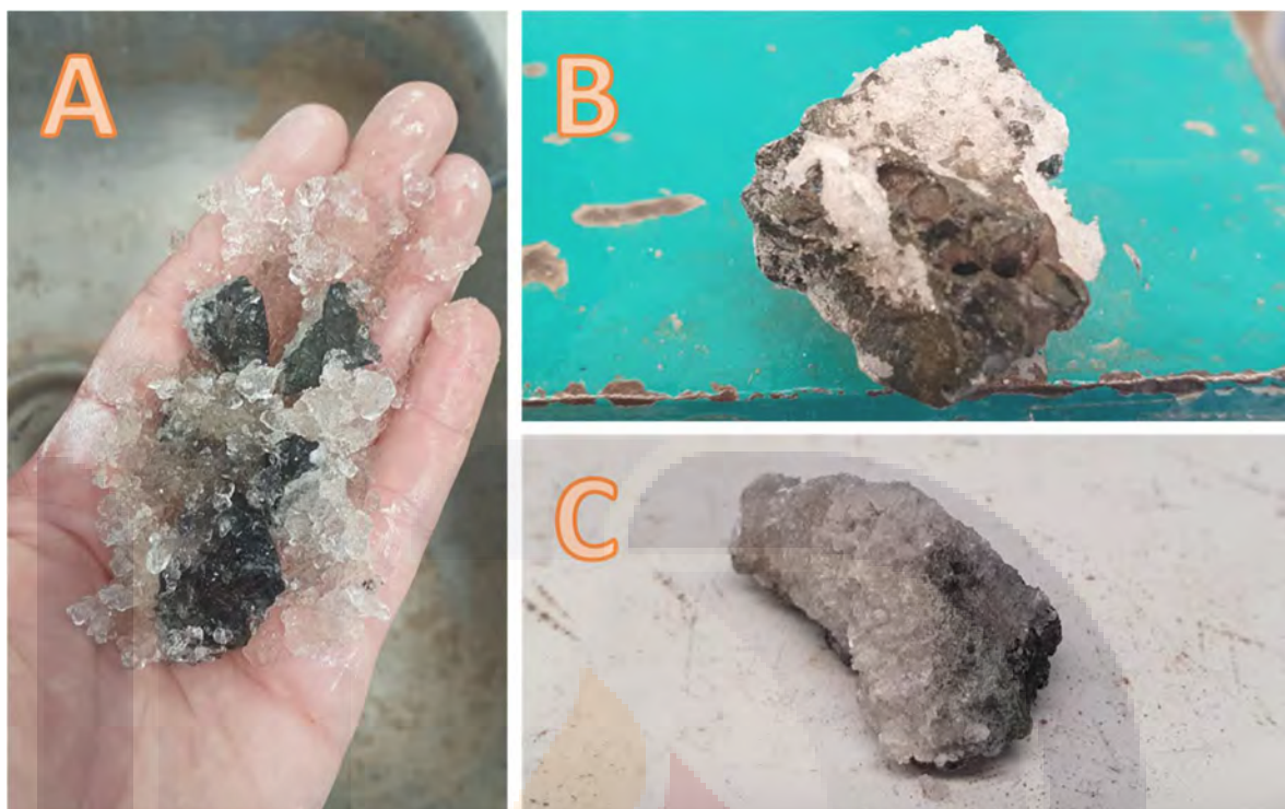
Ilustración 17 A: Sales producidas en la solución de trabajo. B: Formación de cristales, primer ciclo de Intemperismo. C: Formación de cristales en el agregado al finalizar los ciclos de exposición del material. Foto del Autor.
