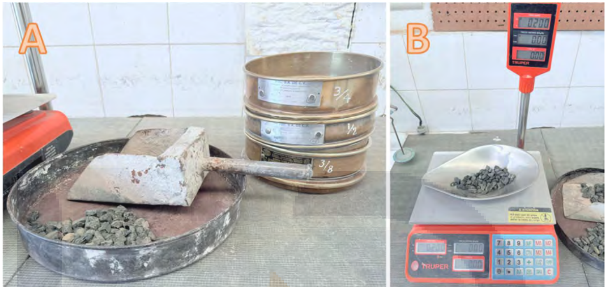
Ilustración 11 A: Preparación de la muestra para determinación de densidad aparente. B: Peso de material seco. Foto del Autor
