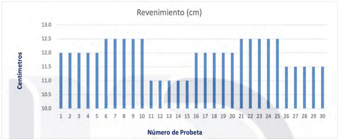
Ilustración 23 Revenimiento obtenido de 6 mezclas realizadas para la elaboración de 30 familias de muestras.
