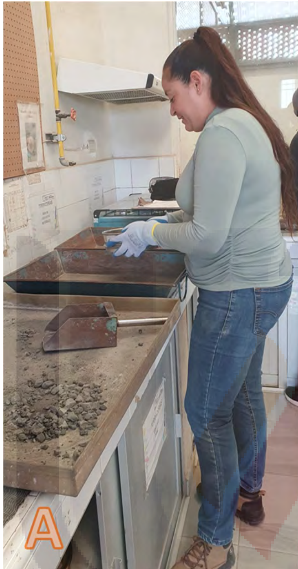
Ilustración 18 A: Cribado y preparación de la muestra. B: Exposición a ciclo de desgaste por abrasión. Foto del Autor.
