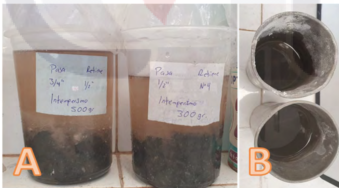
Ilustración 16 A: Saturación de material en solución de sulfato. B: Ciclo de exposición del material para Intemperismo acelerado. Foto del Autor.
