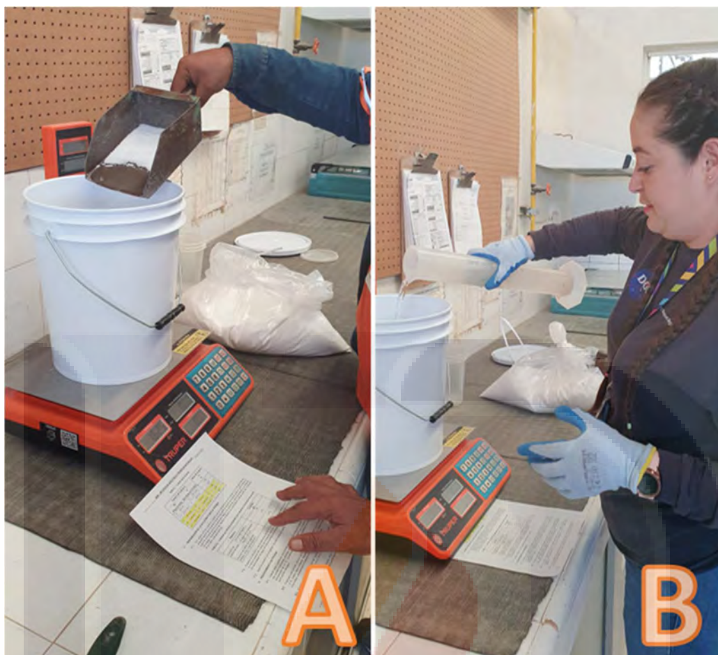
Ilustración 15 Preparación de solución de Sulfato de Sodio para pruebas de intemperismo acelerado. Foto del Autor
