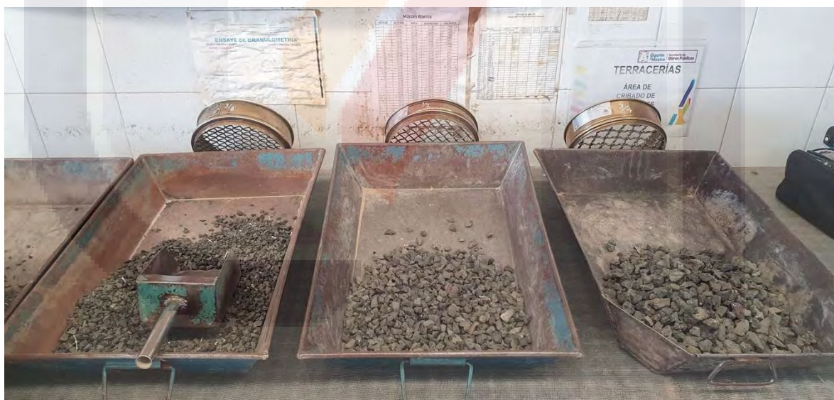
Ilustración 21 Retenidos para curva granulométrica del material. Foto del Autor
