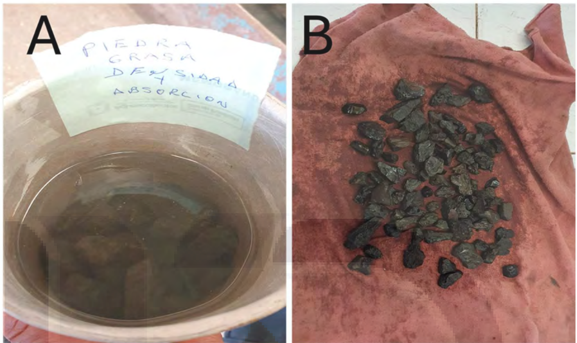
Ilustración 13 A: Saturación del material. B: Material Saturado Superficialmente Seco
