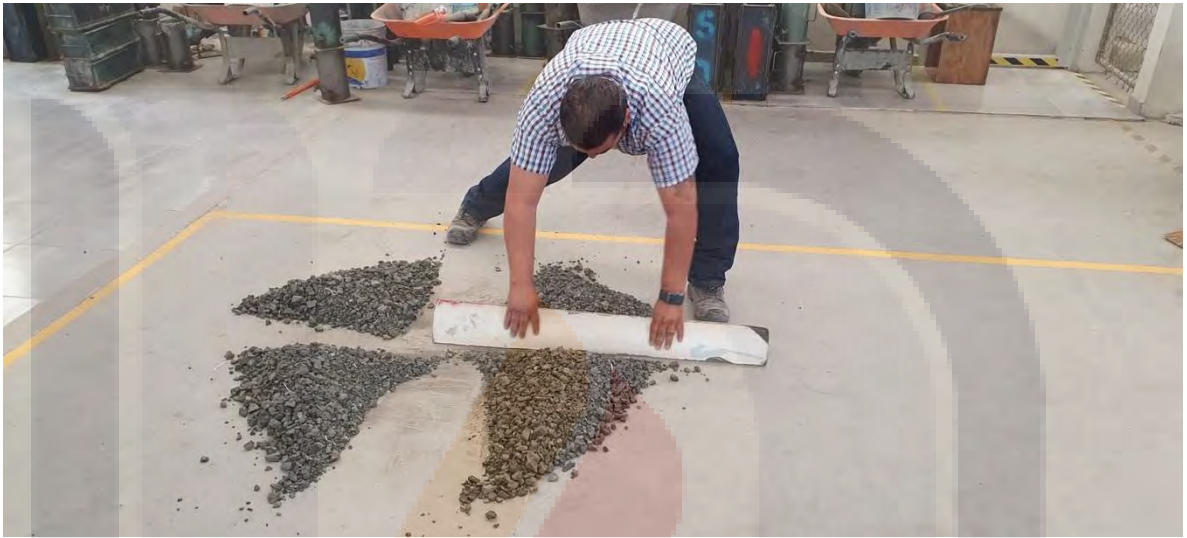
Ilustración 8 Cuarteo y homogenizado de la muestra de material para determinación de parámetros de calidad. Foto del Autor
