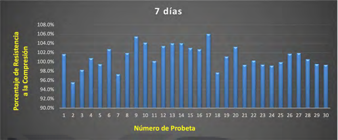
Ilustración 26 Gráfica de resistencia a la compresión obtenida a 7 días por número de muestra respecto a porcentaje.
