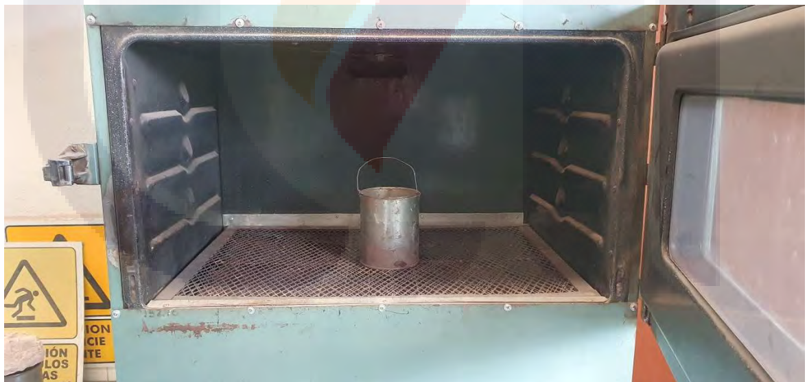
Ilustración 14 Secado del material para determinación de porcentaje de absorción mediante diferencia de pesos
