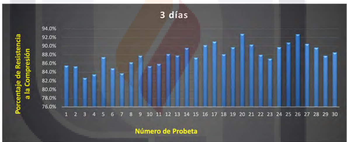
Ilustración 25 Gráfica de resistencia a la compresión obtenida a 3 días por número de muestra respecto a porcentaje.
