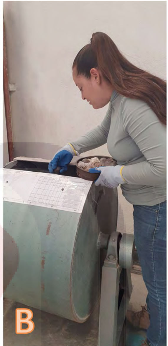
Ilustración 18 A: Cribado y preparación de la muestra. B: Exposición a ciclo de desgaste por abrasión. Foto del Autor.
