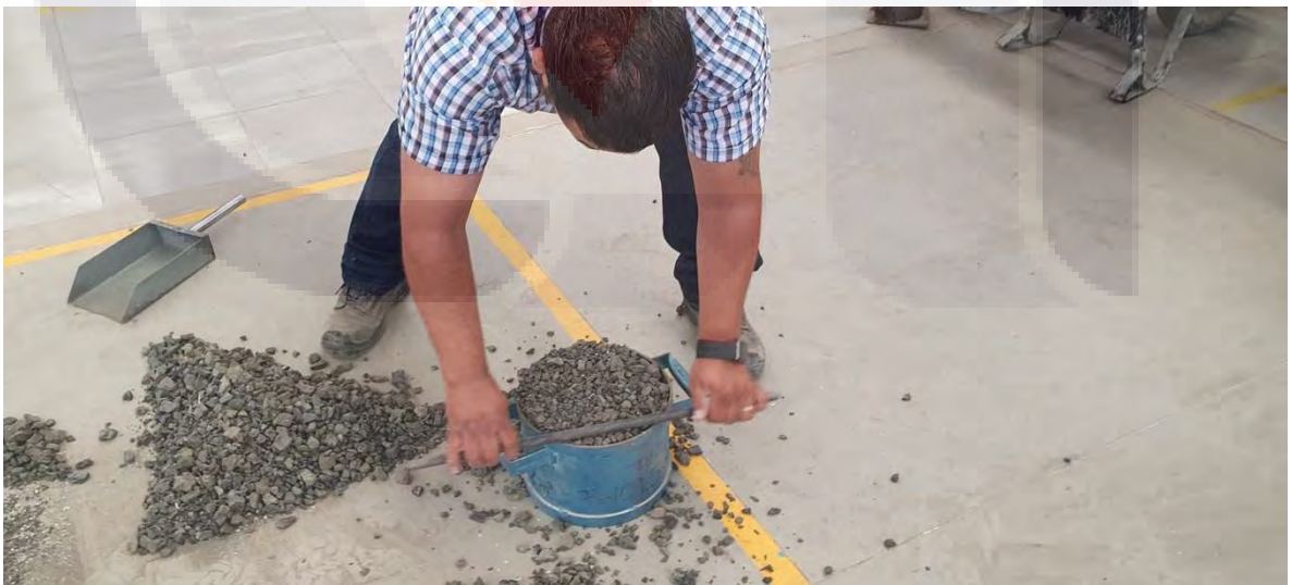
Ilustración 9 Determinación de Peso Volumétrico Seco Suelto del Material. Foto del Autor
