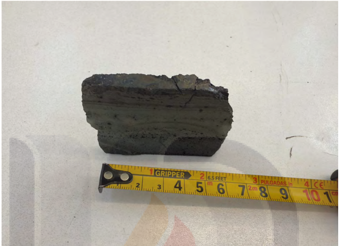
Ilustración 6. Preparación de probeta para lámina delgada. Foto del Autor.
